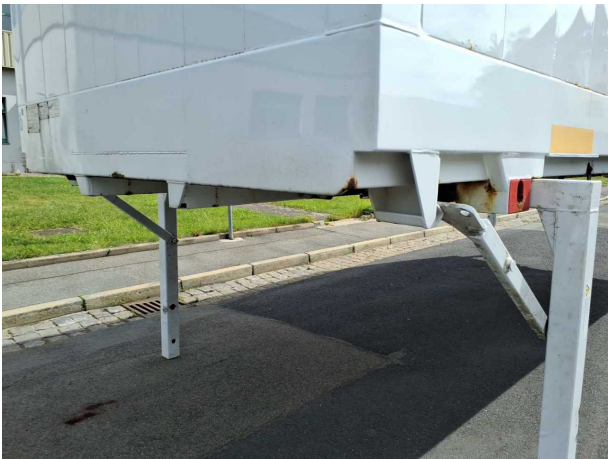
Beschädigung 2: Karosserie: Karosserie - Korrosion - instandsetzen und lackieren
