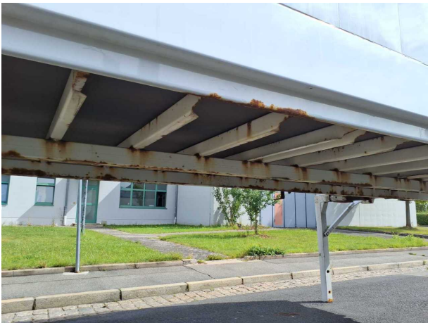
Beschädigung 2: Karosserie: Karosserie - Korrosion - instandsetzen und lackieren
