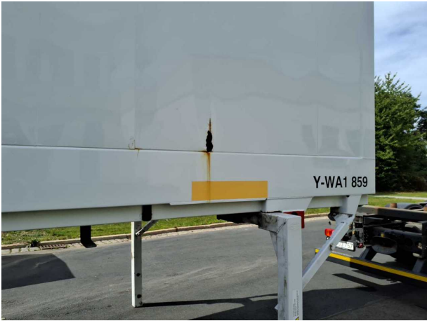
Beschädigung 2: Karosserie: Karosserie - Korrosion - instandsetzen und lackieren
