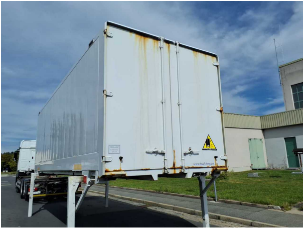
Beschädigung 2: Karosserie: Karosserie - Korrosion - instandsetzen und lackieren
