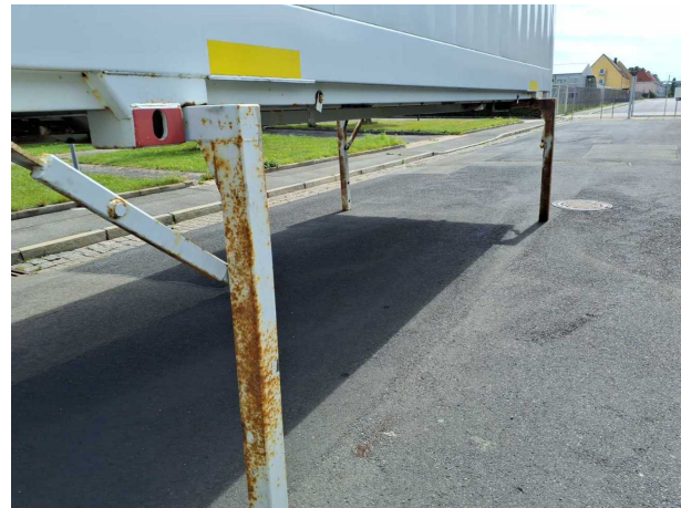
Beschädigung 1: Karosserie: Karosserie - Korrosion - instandsetzen und lackieren
