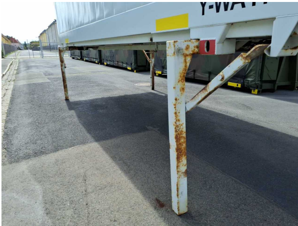
Beschädigung 1: Karosserie: Karosserie - Korrosion - instandsetzen und lackieren
