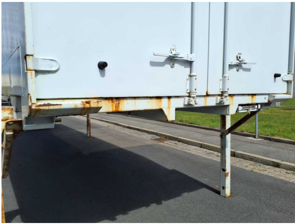
Beschädigung 1: Karosserie: Karosserie - Korrosion - instandsetzen und lackieren
