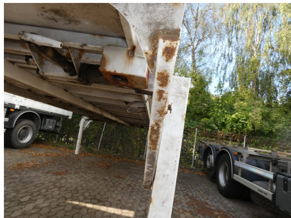
Bild 22: Rahmen und Stützbeine Korrosion - ohne Reparatur
