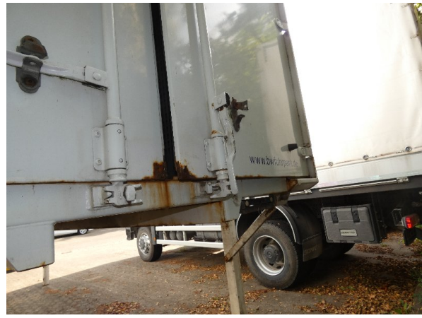
Bild 14: Hecktür rechts Korrosion - teillackieren
