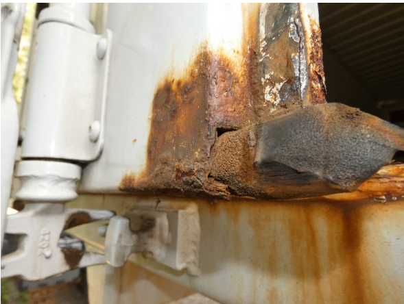
Bild 12: Hecktür links Korrosion - teillackieren
