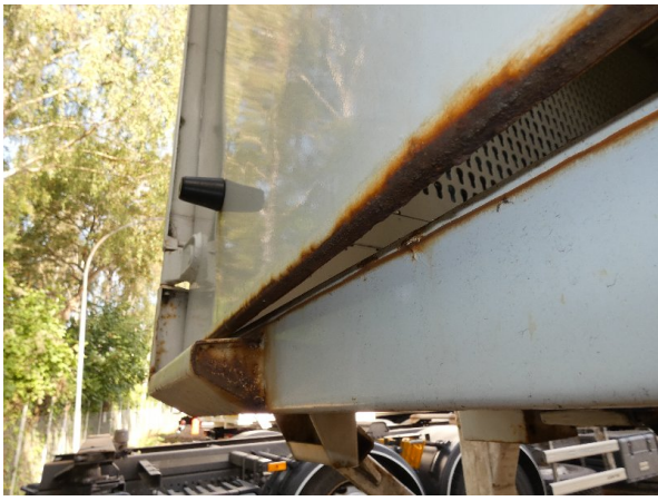
Bild 13: Hecktür links Korrosion - teillackieren
