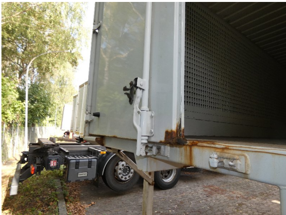
Bild 11: Hecktür links Korrosion - teillackieren
