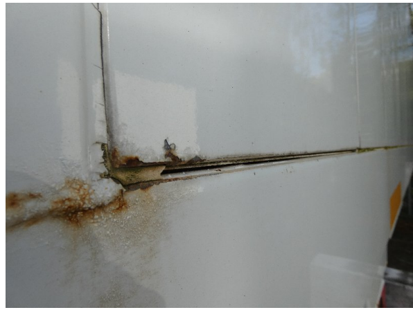
Bild 20: Seitenwand links außen Karrosseriedichtnaht fehlt - instandsetzen
