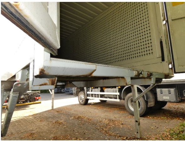
Bild 9: Portalrahmen unten Korrosion - lackieren
