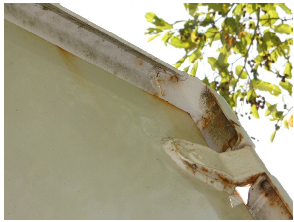
Bild 20: Hecktür rechts Korrosion - teillackieren
