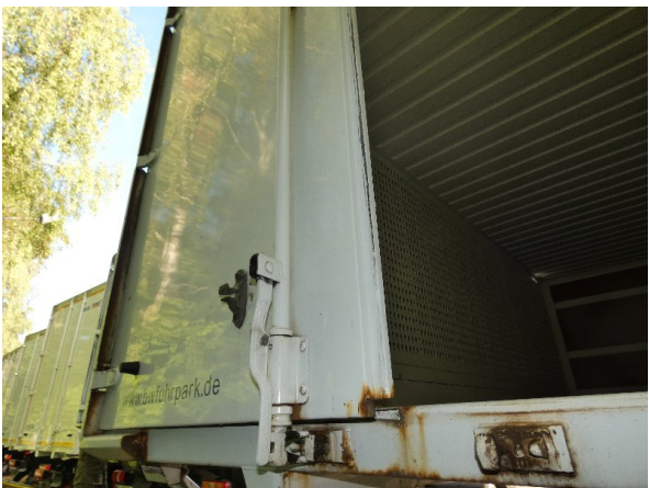
Bild 14: Hecktür links Korrosion - teillackieren
