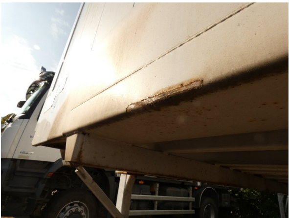
Bild 6: Rahmen und Stützbeine Korrosion - ohne Reparatur
