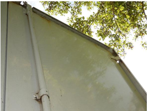
Bild 18: Hecktür rechts Korrosion - teillackieren
