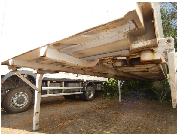
Bild 5: Rahmen und Stützbeine Korrosion - ohne Reparatur
