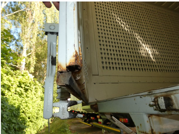
Bild 15: Hecktür links Korrosion - teillackieren
