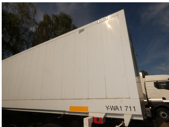
Bild 21: Seitenwand rechts Lackablösung - teillackieren
