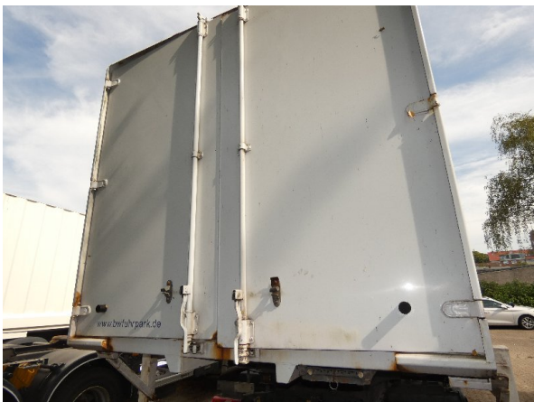
Bild 6: Hecktür rechts Korrosion - teillackieren
