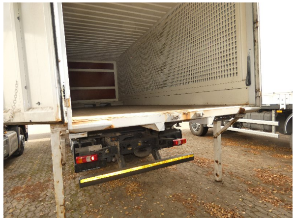
Bild 12: Portalrahmen unten Korrosion - lackieren
