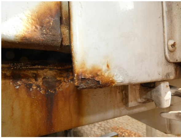
Bild 7: Hecktür rechts Korrosion - teillackieren
