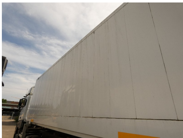
Bild 23: Seitenwand links Lackablösung, Korrosion - teillackieren
