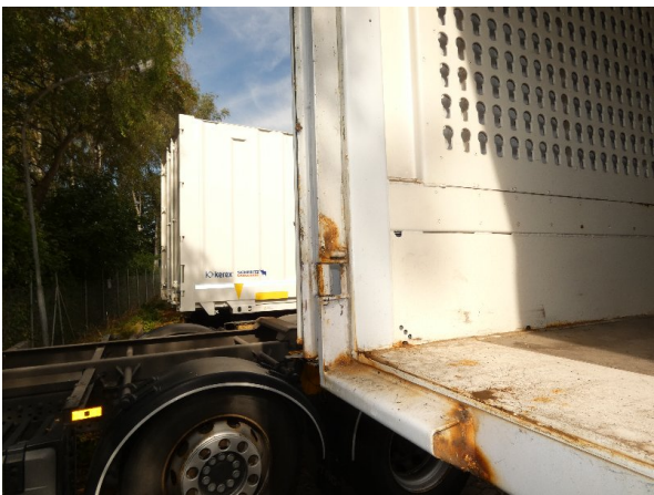
Bild 16: Portalrahmen links Korrosion - lackieren
