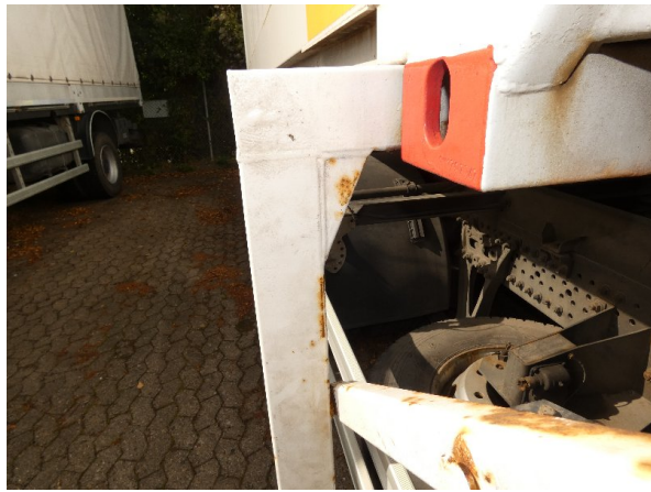
Bild 19: Rahmen und Stützbeine Korrosion - ohne Reparatur
