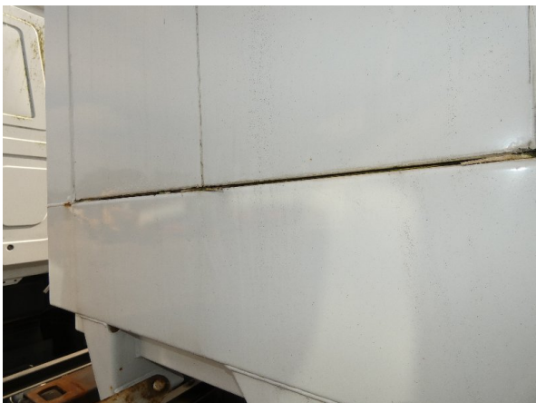
Bild 26: Seitenwand links Lackablösung, Korrosion - teillackieren
