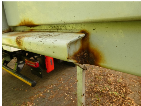
Bild 31: Portalrahmen unten Korrosion - lackieren
