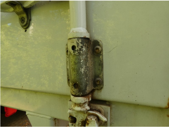
Bild 27: Halter Türverriegelung unlackiert - lackieren
