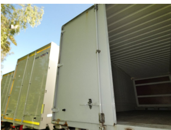
Bild 6: Hecktür links Korrosion - teillackieren
