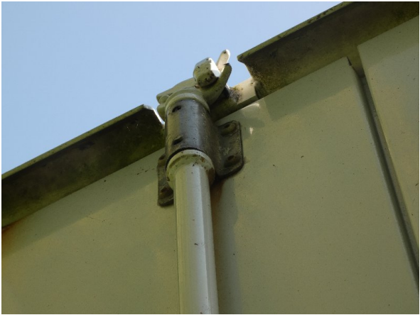
Bild 28: Halter Türverriegelung unlackiert - lackieren
