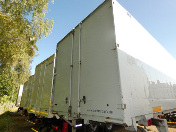
Bild 9: Hecktür rechts Korrosion - teillackieren
