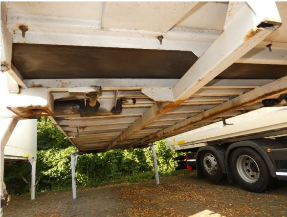
Bild 11: Rahmen und Stützbeine Korrosion - ohne Reparatur
