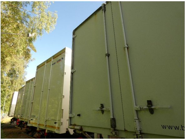
Bild 26: Halter Türverriegelung unlackiert - lackieren
