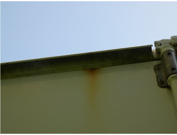
Bild 8: Hecktür links Korrosion - teillackieren
