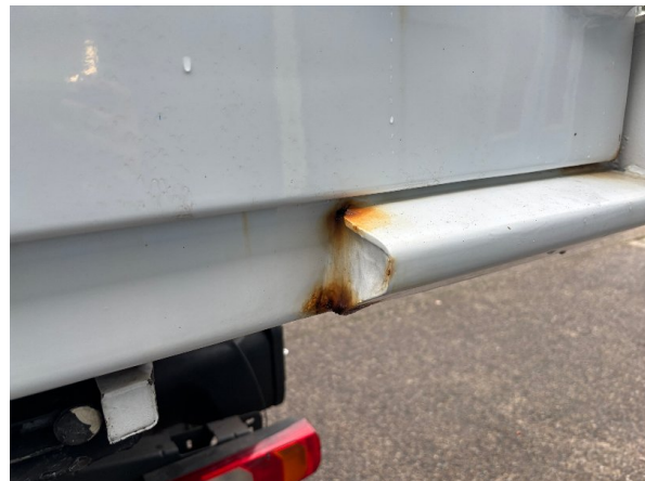
Bild 7: Container Korrosion - ohne Reparatur
