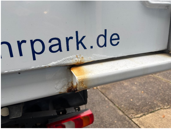
Bild 7: Container Korrosion - ohne Reparatur
