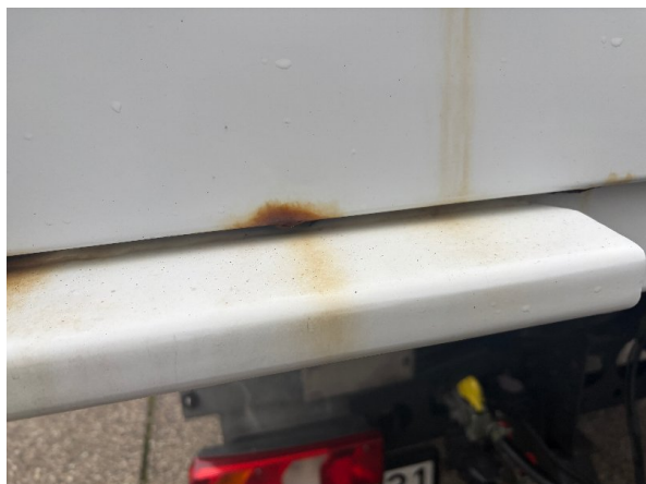
Bild 7: Container Korrosion - ohne Reparatur
