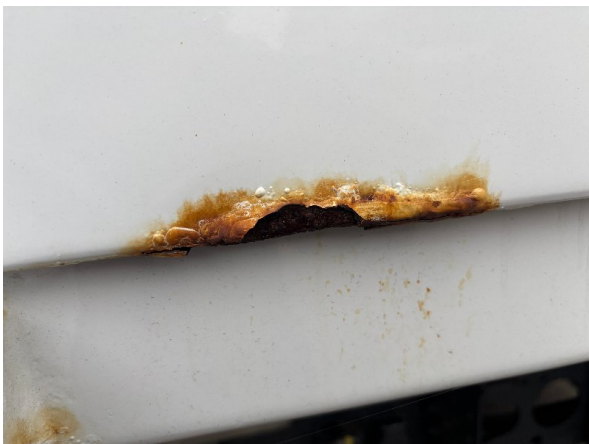
Bild 7: Container Korrosion - ohne Reparatur
