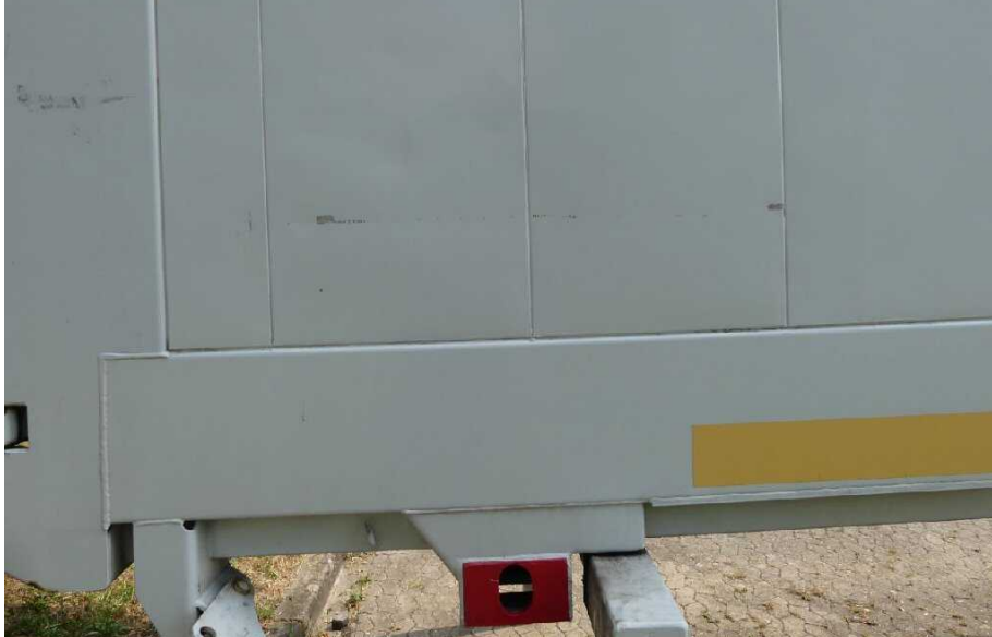
Bild 11 rechte Seite Seitenwand rechts verkratzt deformiert
