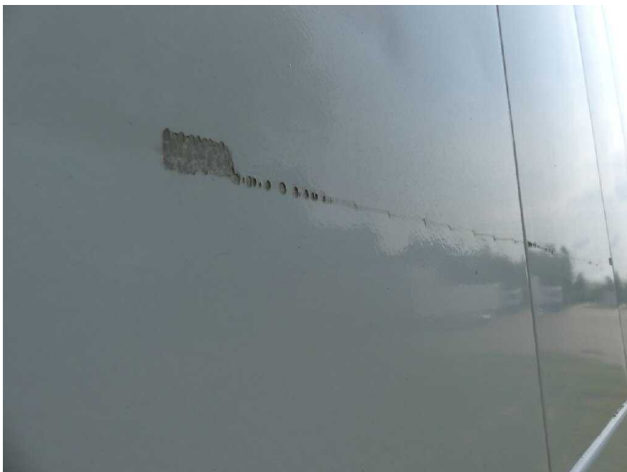
Bild 12 rechte Seite Seitenwand rechts verkratzt deformiert
