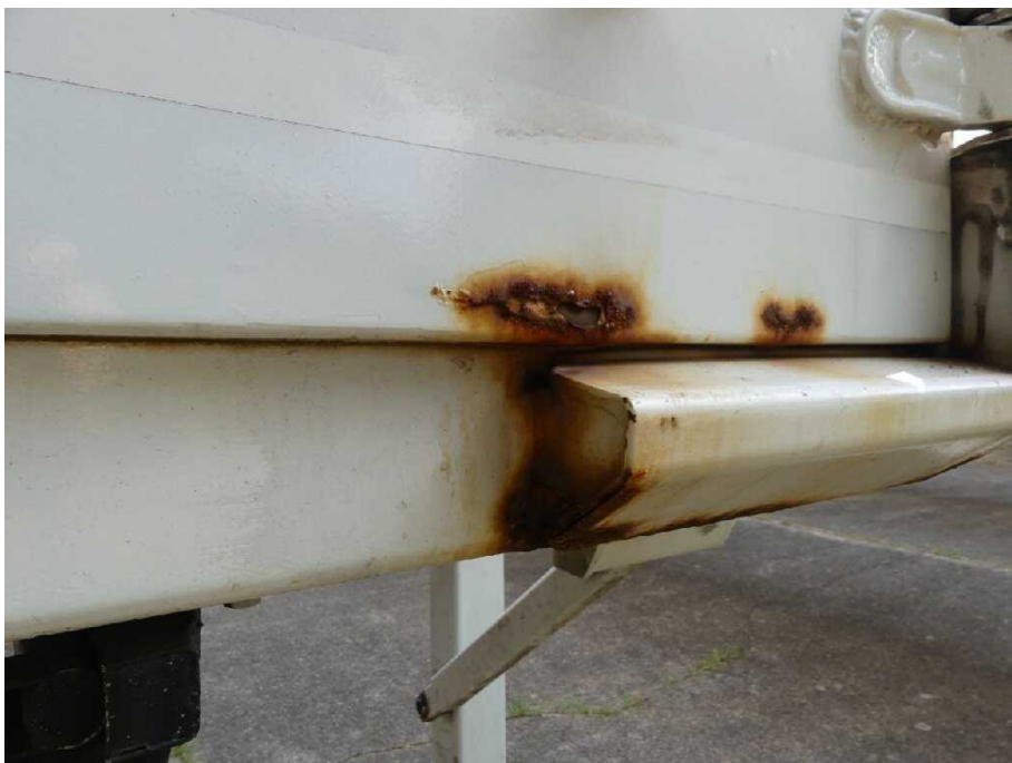
Bild 10 rechte Seite Tür hinten rechts korrodiert
