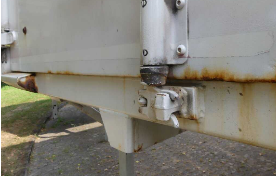
Bild 9 linke Seite Tür hinten links korrodiert
