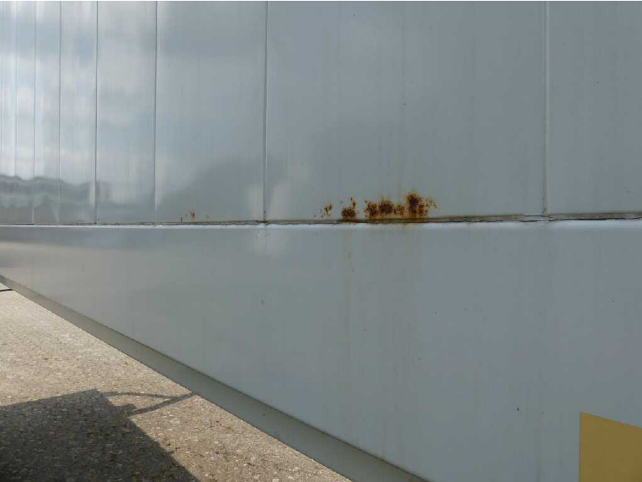
Bild 10 linke Seite Seitenwand links korrodiert
