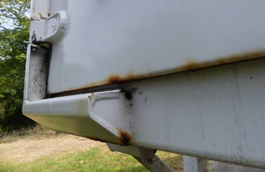
Bild 9 linke Seite Tür hinten links korrodiert
