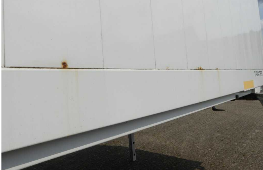
Bild 11 rechte Seite Seitenwand rechts korrodiert
