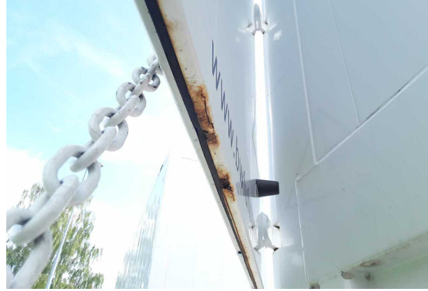
Beschädigung 2: Heckklappe/-tür: Hecktür rechts - Korrosio... instandsetzen und lackieren
