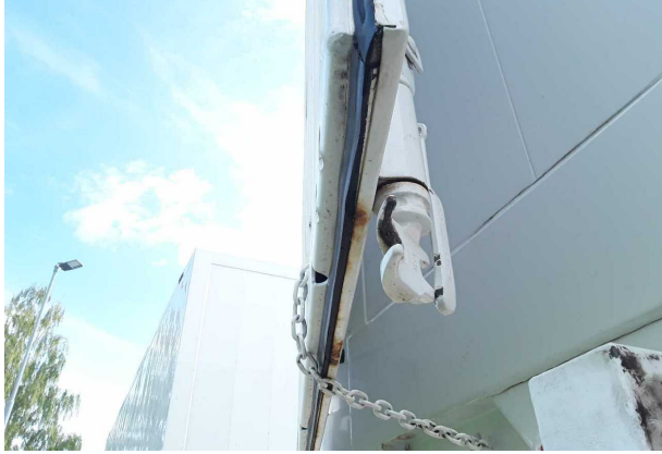
Beschädigung 2: Heckklappe/-tür: Hecktür rechts - Korrosion - instandsetzen und lackieren
