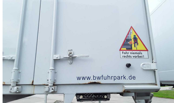
Beschädigung 3: Heckklappe/-tür: Hecktür rechts - Korrosio... instandsetzen und lackieren
