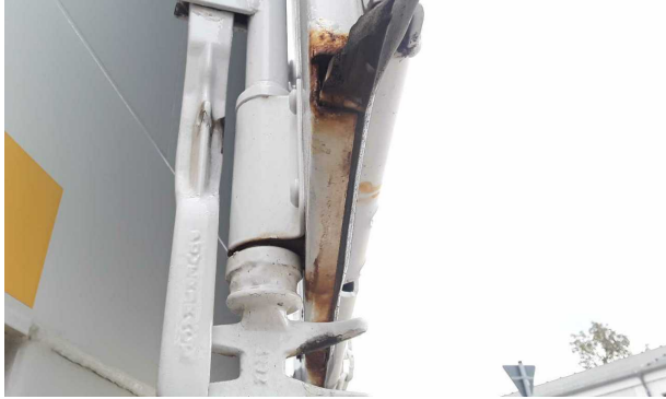
Beschädigung 2: Heckklappe/-tür: Hecktür links - Korrosion - instandsetzen und lackieren
