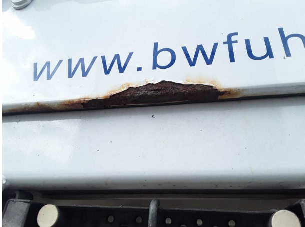
Beschädigung 3: Heckklappe/-tür: Hecktür rechts - Korrosion - instandsetzen und lackieren
