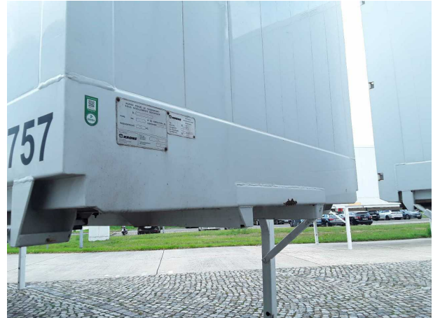
Beschädigung 4: Koffer: Portalrahmen (Vorn) - Korrosion - instandsetzen und lackieren
