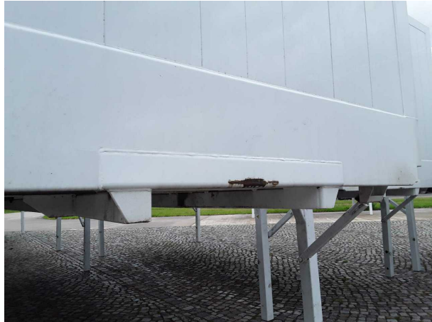
Gebrauchsspur 1: Koffer: Portalrahmen (Vorn) - Lackmangel
