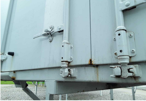
Beschädigung 2: Heckklappe/-tür: Hecktür links - Korrosion - instandsetzen und lackieren
