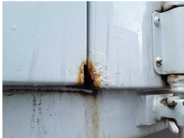
Beschädigung 3: Heckklappe/-tür: Hecktür rechts - Korrosio... instandsetzen und lackieren
