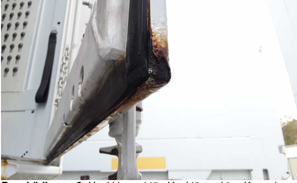
Beschädigung 3: Heckklappe/-tür: Hecktür rechts - Korrosion - instandsetzen und lackieren
