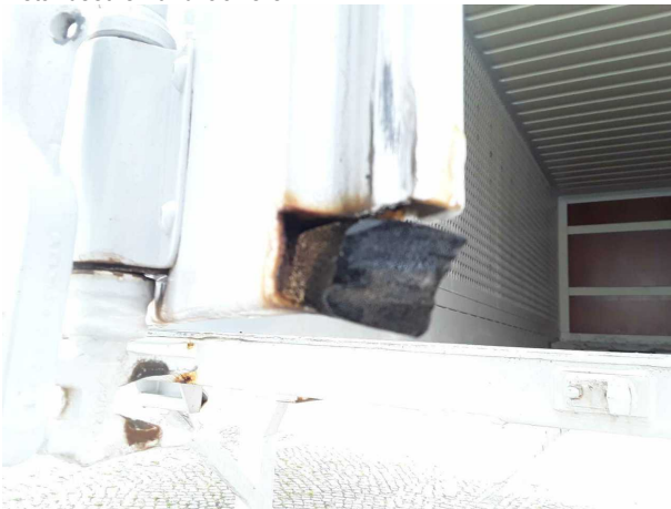
Beschädigung 2: Heckklappe/-tür: Hecktür links - Korrosion - instandsetzen und lackieren
