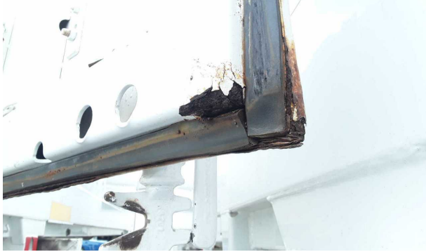
Beschädigung 3: Heckklappe/-tür: Hecktür rechts - Korrosion - instandsetzen und lackieren
