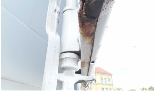
Beschädigung 2: Heckklappe/-tür: Hecktür links - Korrosion - instandsetzen und lackieren
