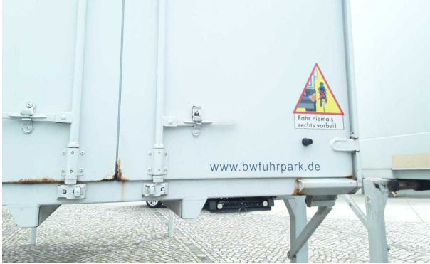
Beschädigung 2: Heckklappe/-tür: Hecktür rechts - Korrosion - instandsetzen und lackieren
