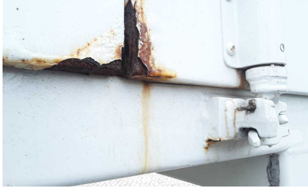
Beschädigung 2: Heckklappe/-tür: Hecktür rechts - Korrosio... instandsetzen und lackieren
