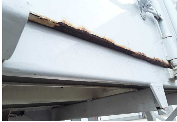
Beschädigung 1: Heckklappe/-tür: Hecktür links - Korrosion - instandsetzen und lackieren
