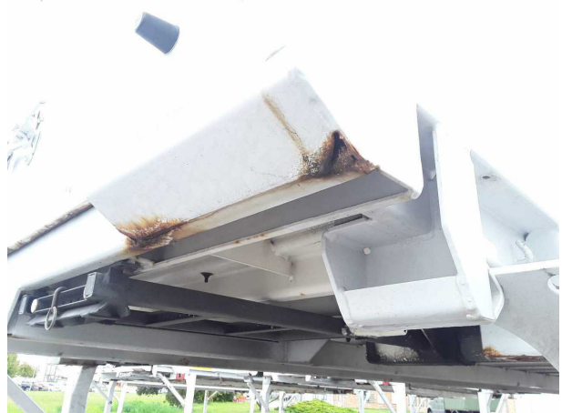
Gebrauchsspur 2: Koffer: Portalrahmen (Hinten) - Korrosion - kein Abzug
