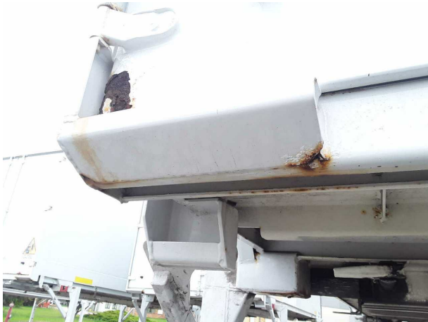
Gebrauchsspur 2: Koffer: Portalrahmen (Hinten) - Korrosion - k... Abzug
