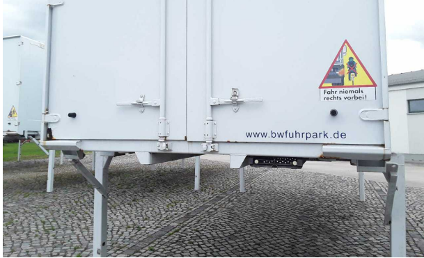
Gebrauchsspur 2: Koffer: Portalrahmen (Hinten) - Korrosion - k... Abzug
