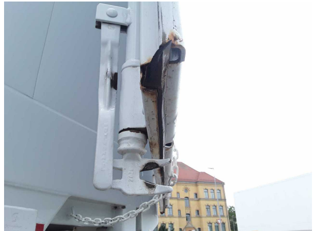
Beschädigung 2: Heckklappe/-tür: Hecktür links - Korrosion - instandsetzen und lackieren
