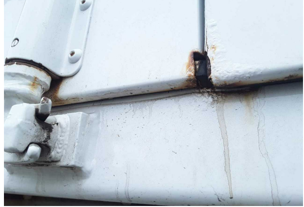
Beschädigung 2: Heckklappe/-tür: Hecktür links - Korrosion - instandsetzen und lackieren
