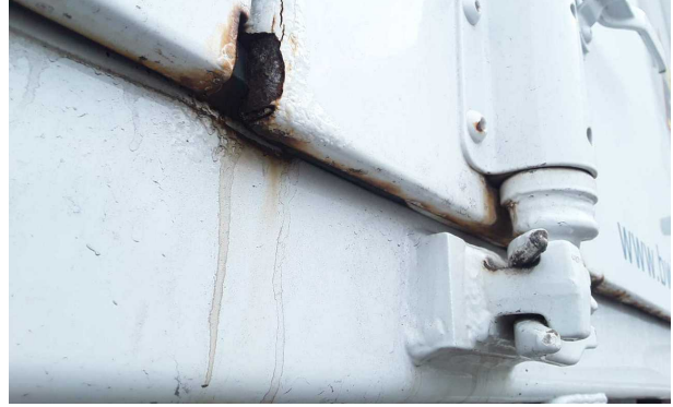
Beschädigung 3: Heckklappe/-tür: Hecktür rechts - Korrosio... instandsetzen und lackieren
