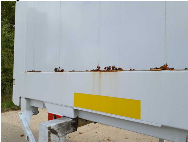
Gebrauchsspur 1: Karosserie: Karosserie - beschädigt - kein Abzug
