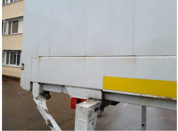
Beschädigung 1: Karosserie: Karosserie - Korrosion - instandsetzen und lackieren
