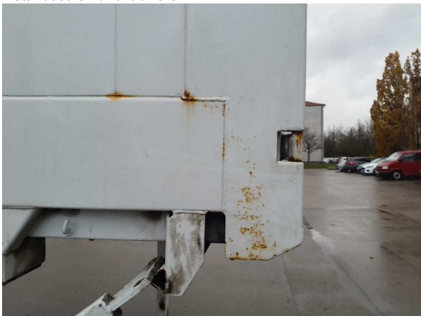
Beschädigung 1: Karosserie: Karosserie - Korrosion - instandsetzen und lackieren
