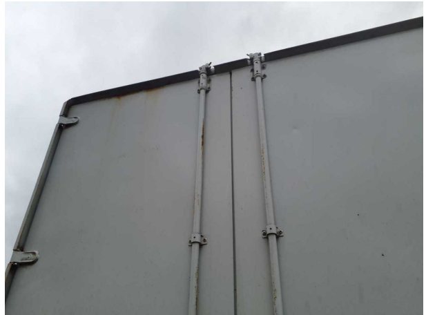
Beschädigung 1: Karosserie: Karosserie - Korrosion - instandsetzen und lackieren
