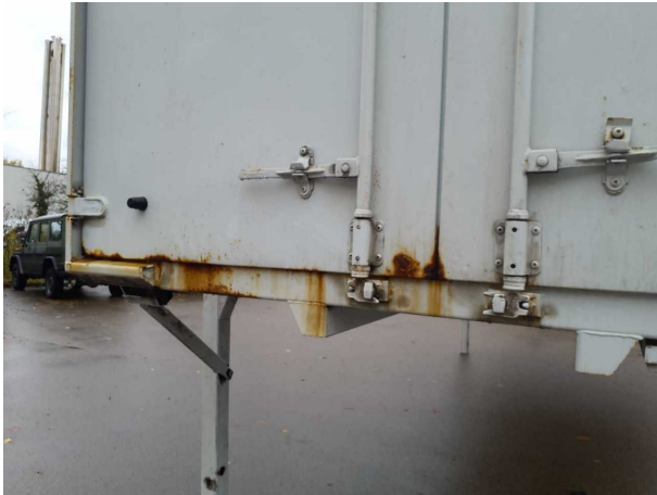
Beschädigung 1: Karosserie: Karosserie - Korrosion - instandsetzen und lackieren
