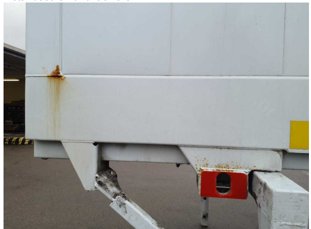
Beschädigung 1: Karosserie: Karosserie - Korrosion - instandsetzen und lackieren
