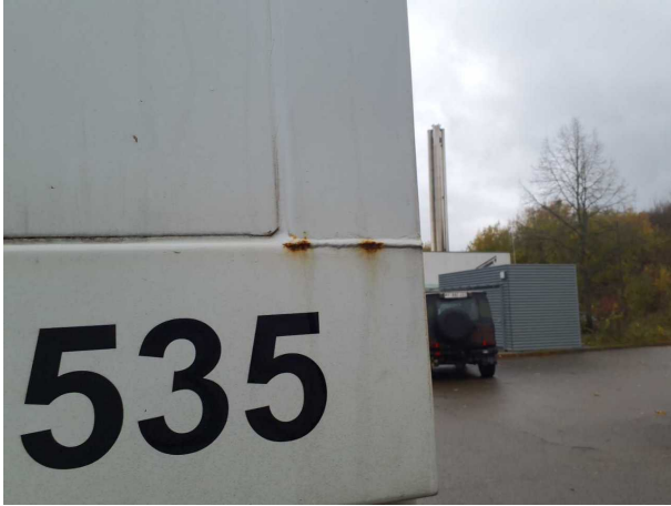
Beschädigung 1: Karosserie: Karosserie - Korrosion - instandsetzen und lackieren
