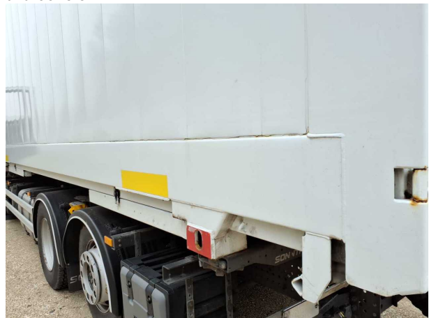
Beschädigung 1: Aufbau: Aufbau - Korrosion - instandsetzen und lackieren
