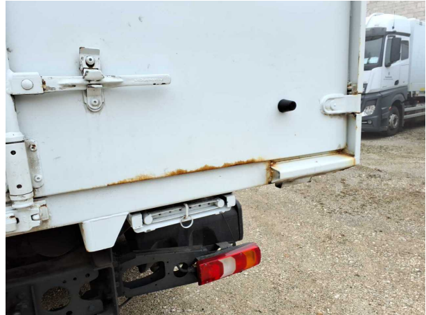
Beschädigung 1: Aufbau: Aufbau - Korrosion - instandsetzen und lackieren
