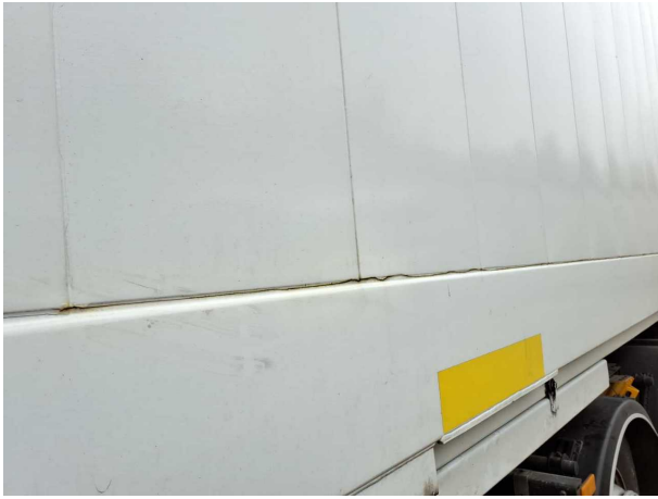
Beschädigung 1: Aufbau: Aufbau - Korrosion - instandsetzen und lackieren
