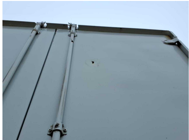
Beschädigung 1: Aufbau: Aufbau - Korrosion - instandsetzen und lackieren
