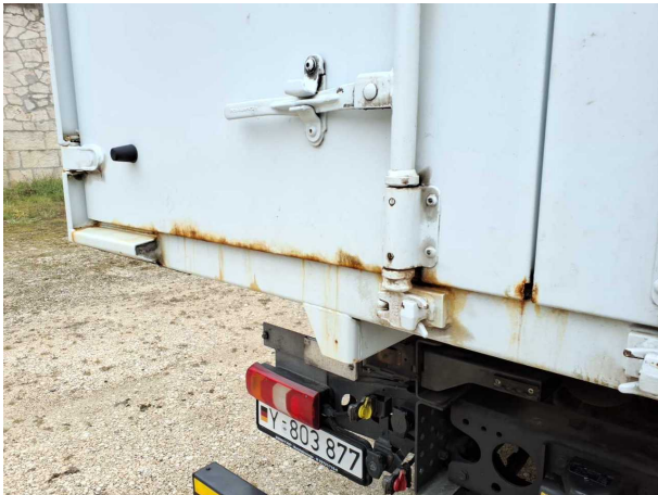
Beschädigung 1: Aufbau: Aufbau - Korrosion - instandsetzen und lackieren
