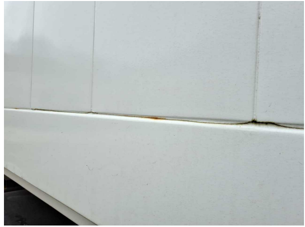
Beschädigung 1: Aufbau: Aufbau - Korrosion - instandsetzen und lackieren
