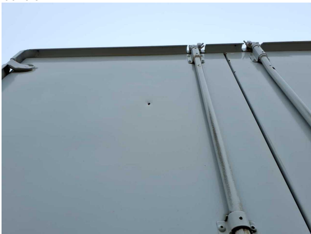
Beschädigung 1: Aufbau: Aufbau - Korrosion - instandsetzen und lackieren
