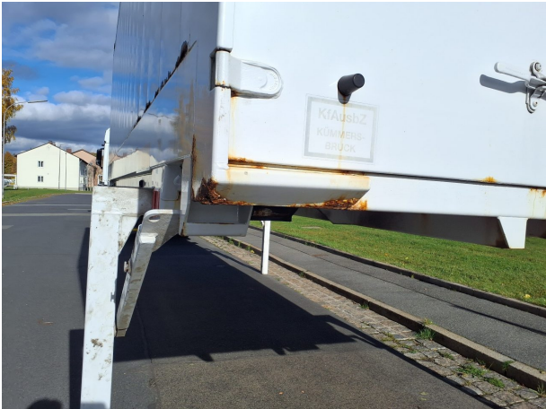
Beschädigung 1: Karosserie: Karosserie - Korrosion - instandsetzen und lackieren
