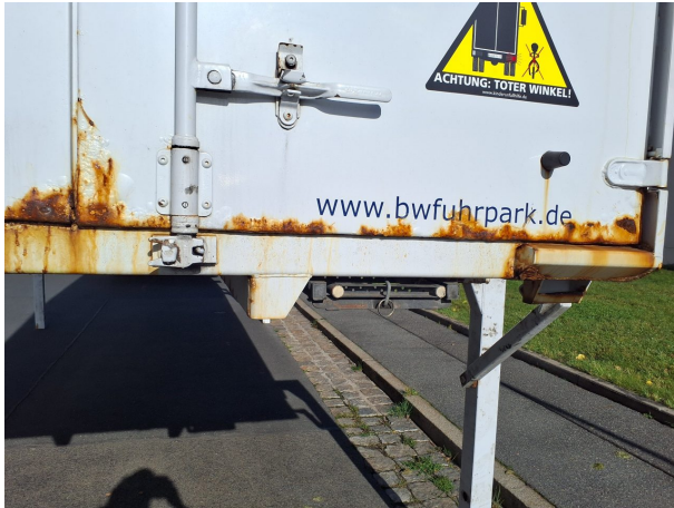
Beschädigung 1: Karosserie: Karosserie - Korrosion - instandsetzen und lackieren
