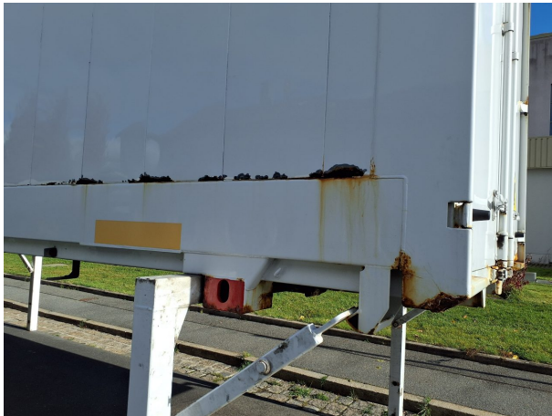
Beschädigung 1: Karosserie: Karosserie - Korrosion - instandsetzen und lackieren
