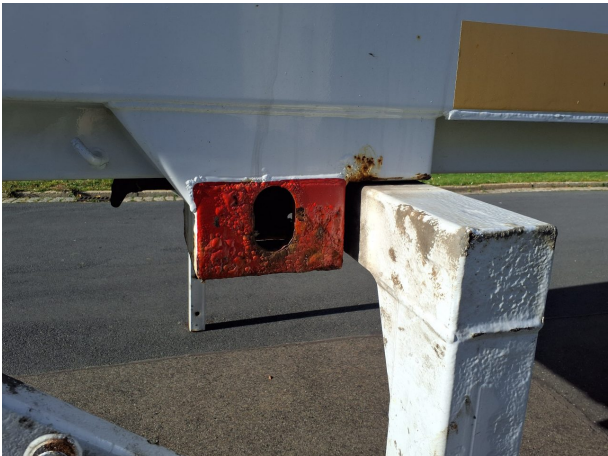
Beschädigung 1: Karosserie: Karosserie - Korrosion - instandsetzen und lackieren
