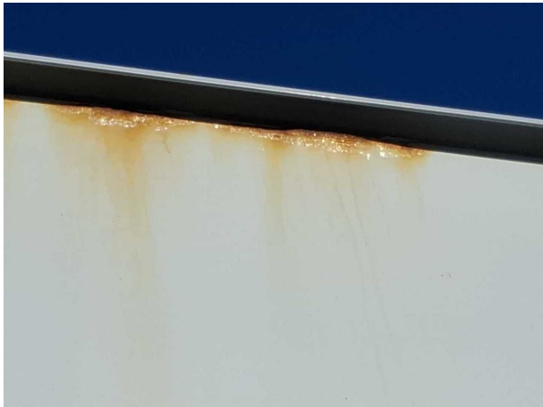
Beschädigung 2: Karosserie: Karosserie - Korrosion - instandsetzen und lackieren
