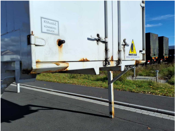
Beschädigung 2: Karosserie: Karosserie - Korrosion - instandsetzen und lackieren
