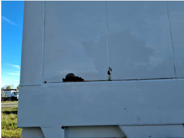
Beschädigung 2: Karosserie: Karosserie - Korrosion - instandsetzen und lackieren
