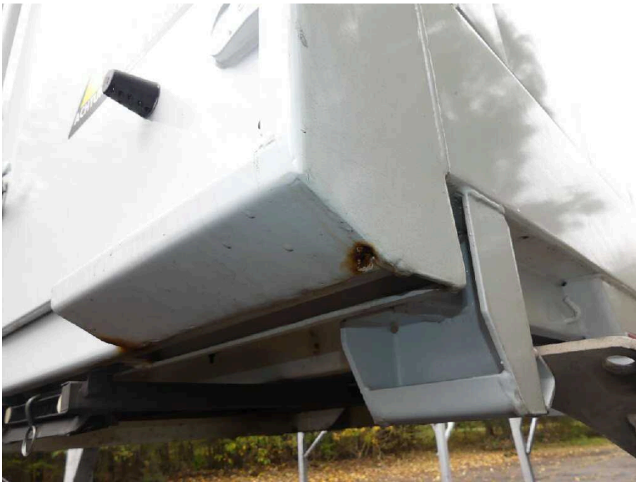
Bild 11 Fahrzeugheck Rahmen hinten rechts korrodiert
