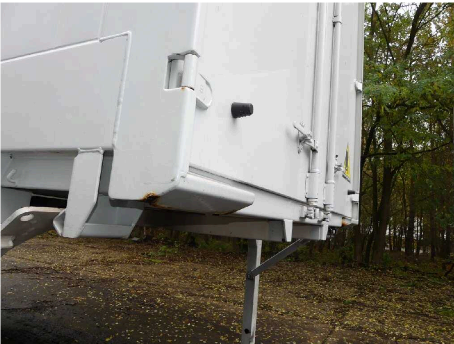
Bild 16 Fahrzeugheck Rahmen hinten links stark korrodiert
