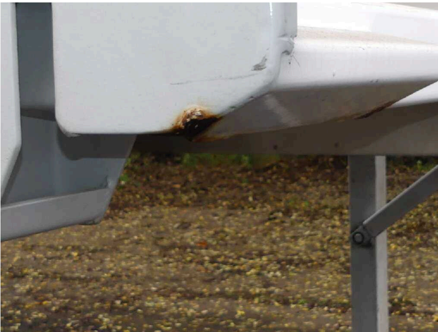
Bild 18 Fahrzeugheck Rahmen hinten links stark korrodiert
