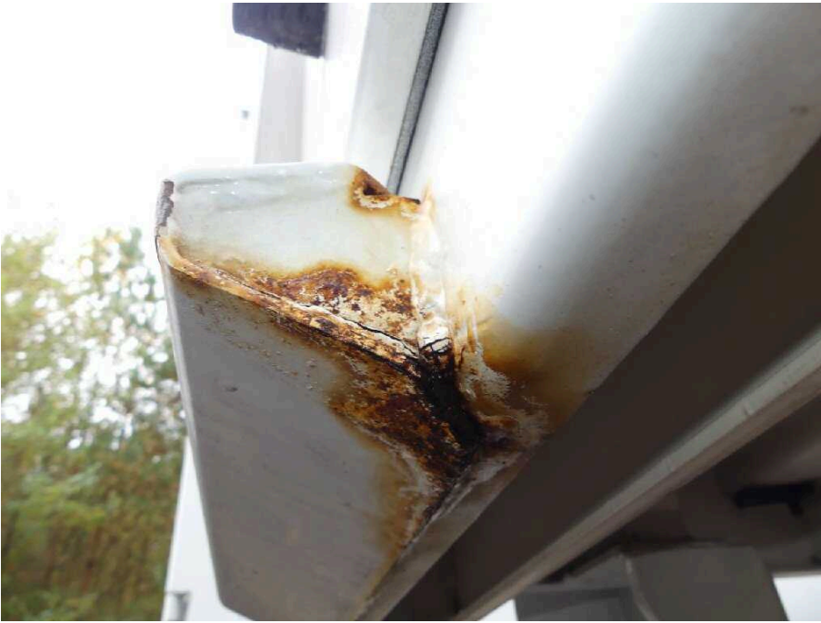
Bild 15 Fahrzeugheck Rahmen hinten links stark korrodiert
