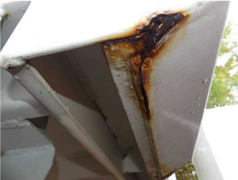
Bild 17 Fahrzeugheck Rahmen hinten links stark korrodiert
