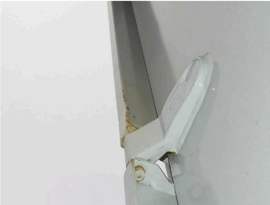
Bild 23 Fahrzeugheck Ecksäule hinten links deformiert
