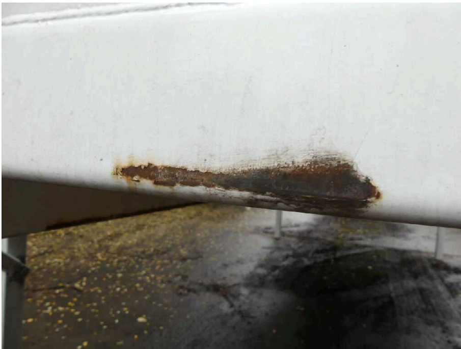
Bild 10 Aufbau Bodenrahmen vorne korrodiert
