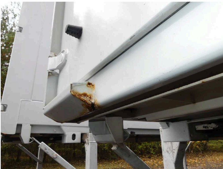
Bild 14 Fahrzeugheck Rahmen hinten links stark korrodiert
