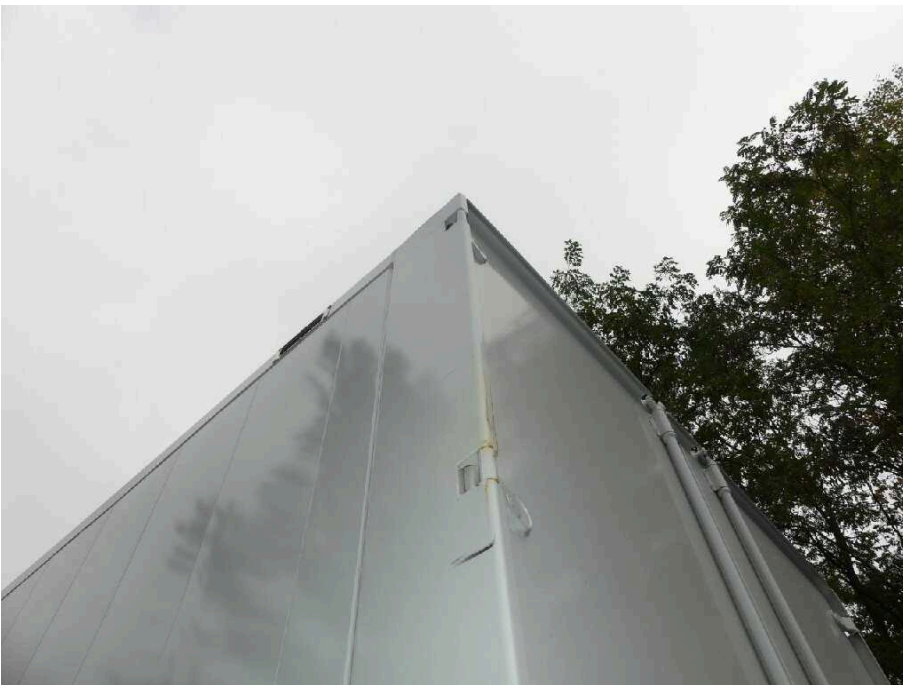
Bild 20 Fahrzeugheck Ecksäule hinten links deformiert
