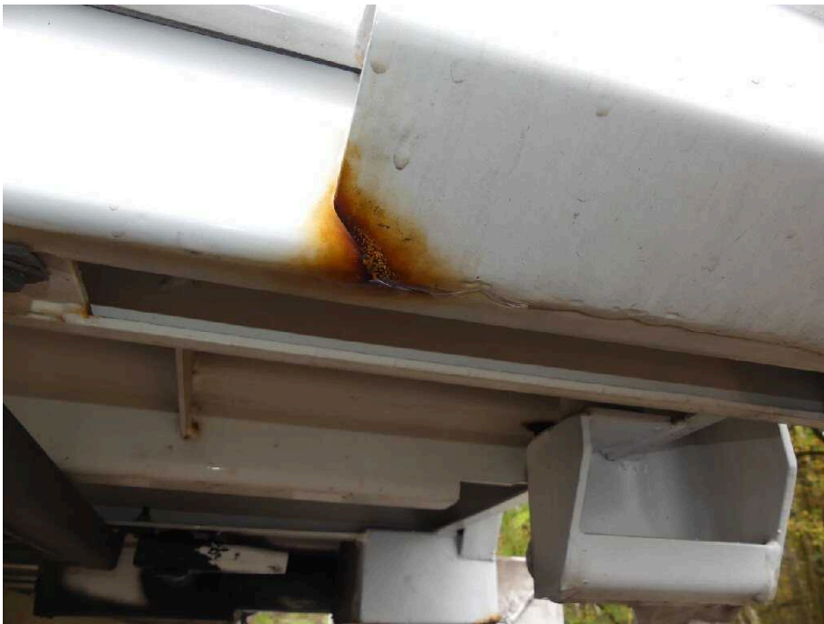
Bild 13 Fahrzeugheck Rahmen hinten rechts korrodiert
