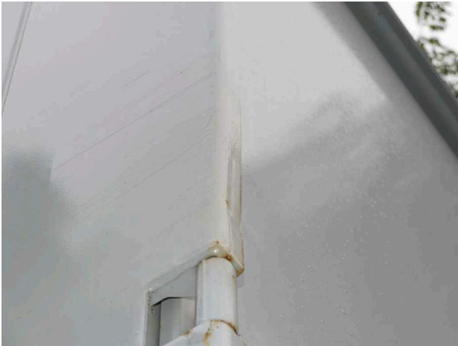
Bild 21 Fahrzeugheck Ecksäule hinten links deformiert
