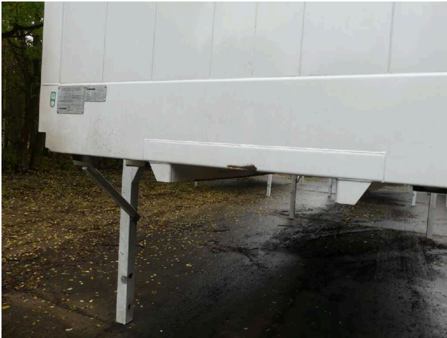
Bild 9 Aufbau Bodenrahmen vorne korrodiert
