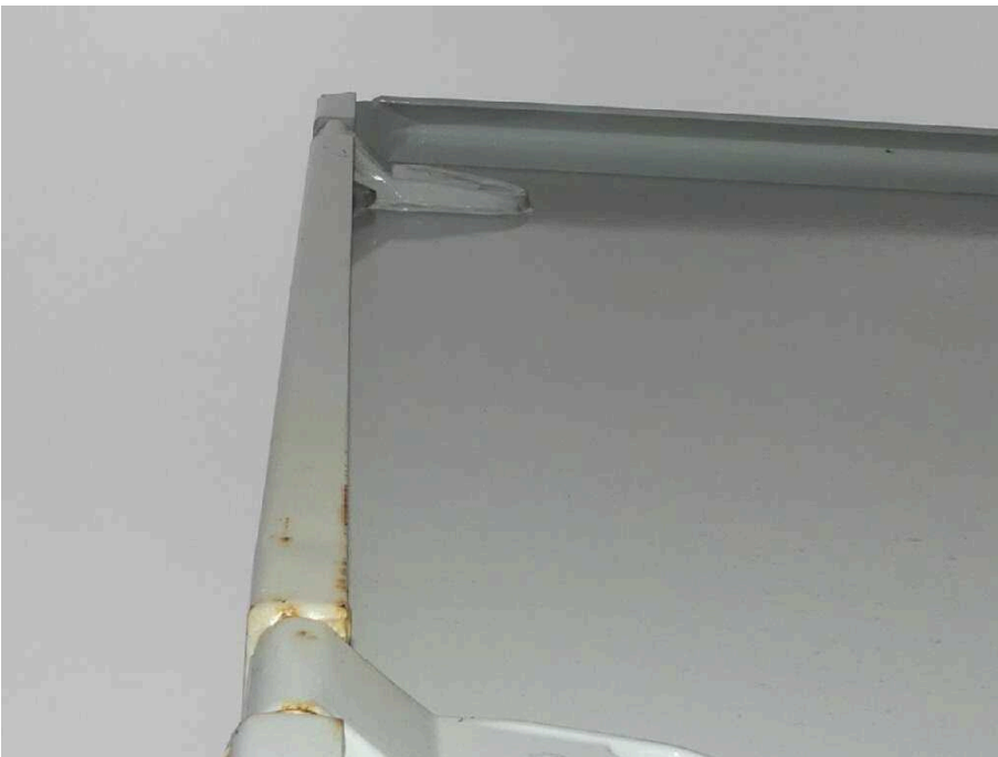
Bild 24 Fahrzeugheck Ecksäule hinten links deformiert
