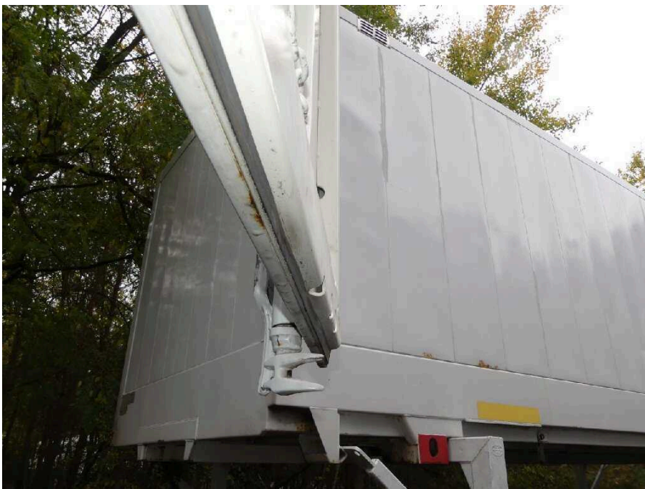
Bild 26 Fahrzeugheck Heckflügeltür links korrodiert
