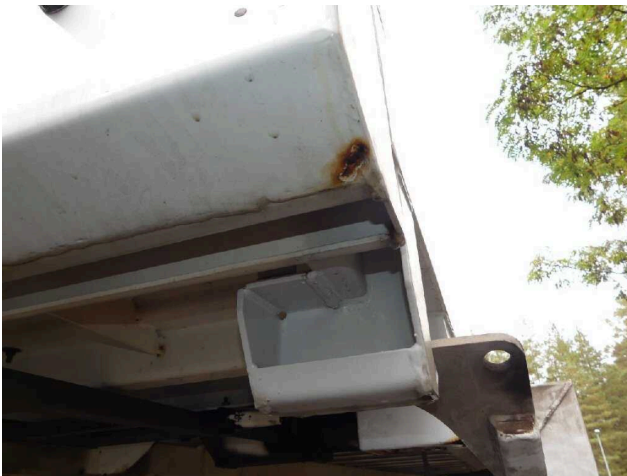
Bild 12 Fahrzeugheck Rahmen hinten rechts korrodiert
