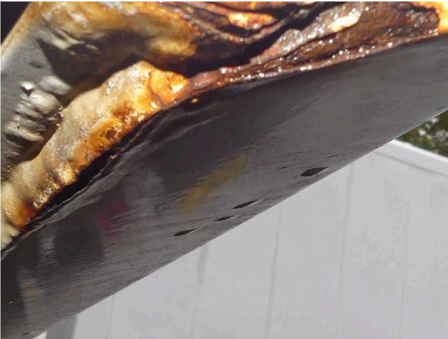
Bild 19 Fahrzeugheck Rahmen hinten links stark korrodiert
