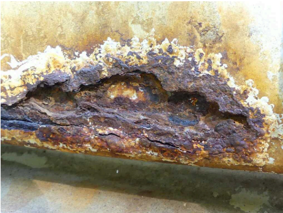
Bild 12 Fahrzeugheck Heckflügeltür rechts stark korrodiert
