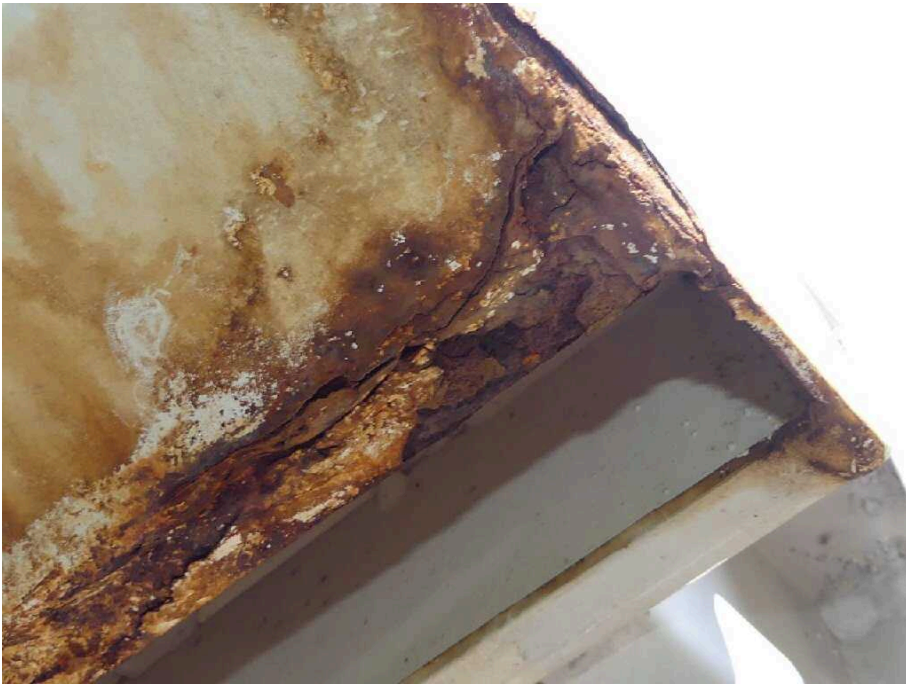
Bild 15 Fahrzeugheck Rahmen hinten rechts korrodiert
