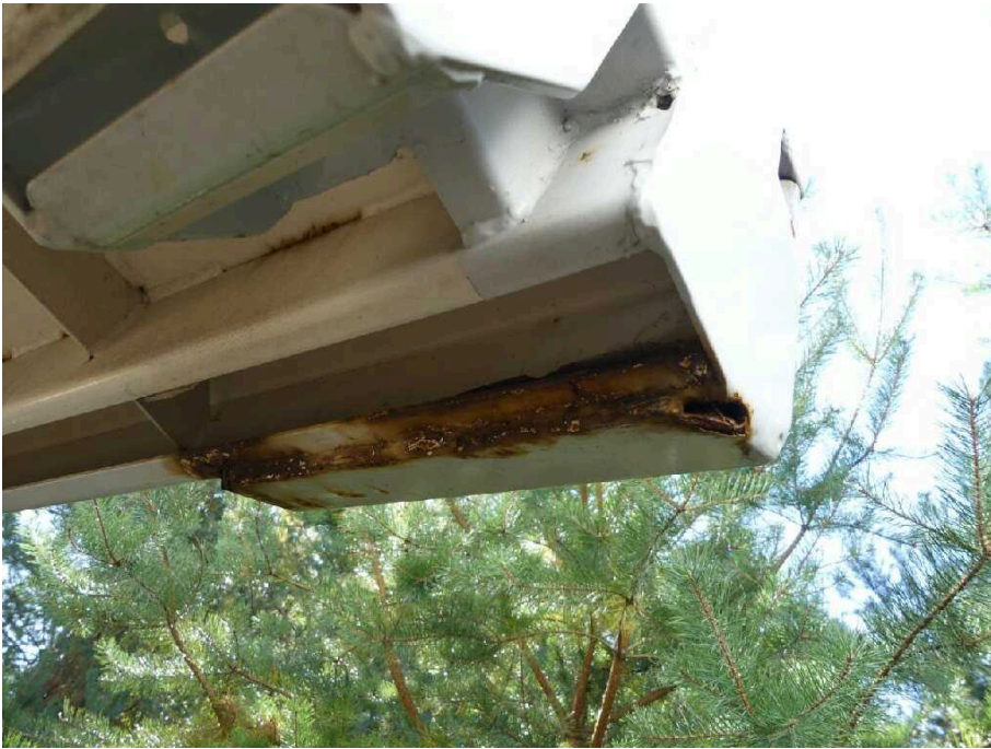
Bild 23 Fahrzeugheck Rahmen hinten links stark korrodiert
