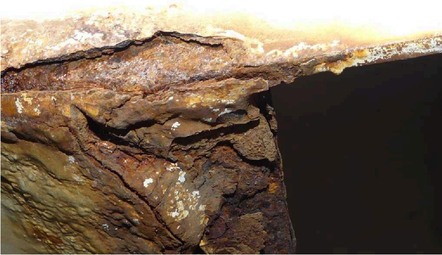
Bild 17 Fahrzeugheck Rahmen hinten rechts korrodiert
