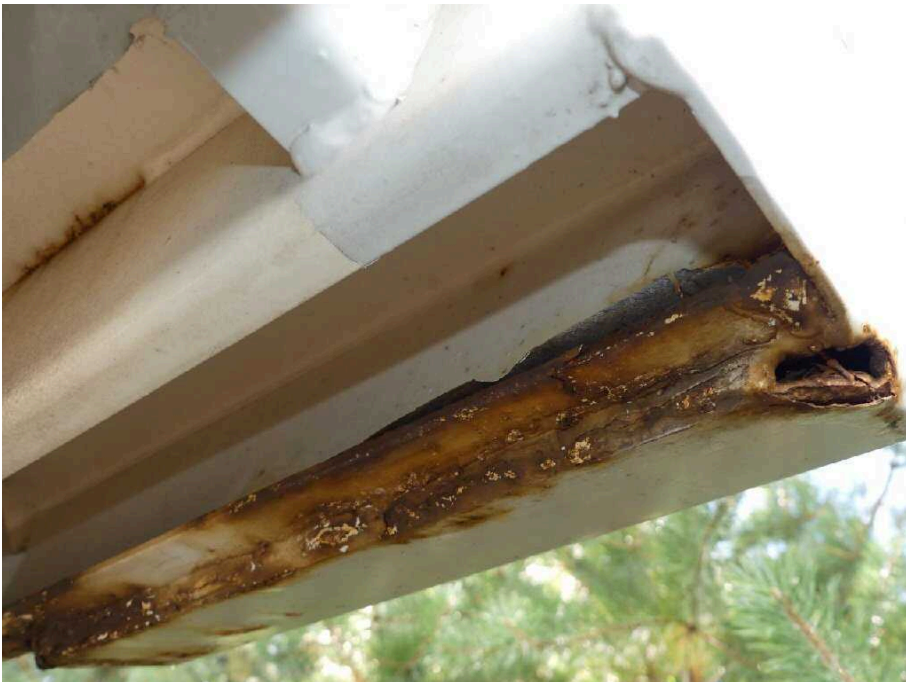
Bild 24 Fahrzeugheck Rahmen hinten links stark korrodiert
