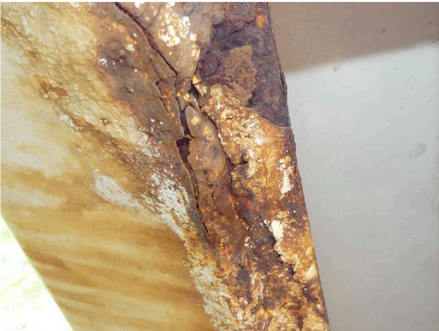
Bild 18 Fahrzeugheck Rahmen hinten rechts korrodiert
