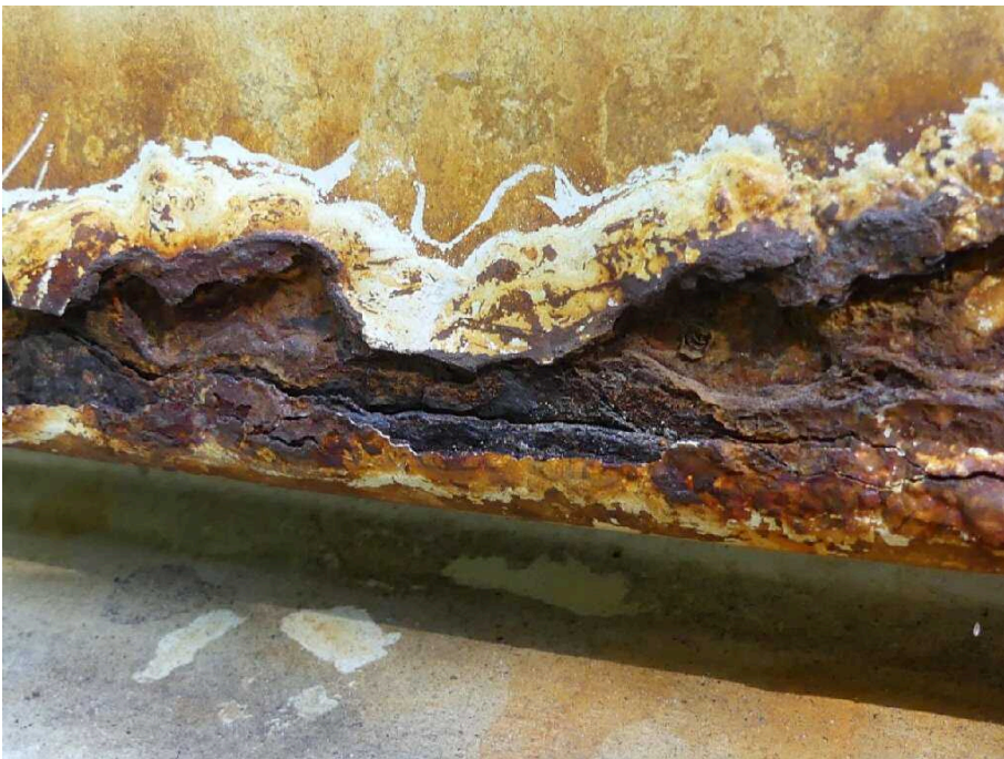
Bild 11 Fahrzeugheck Heckflügeltür rechts stark korrodiert
