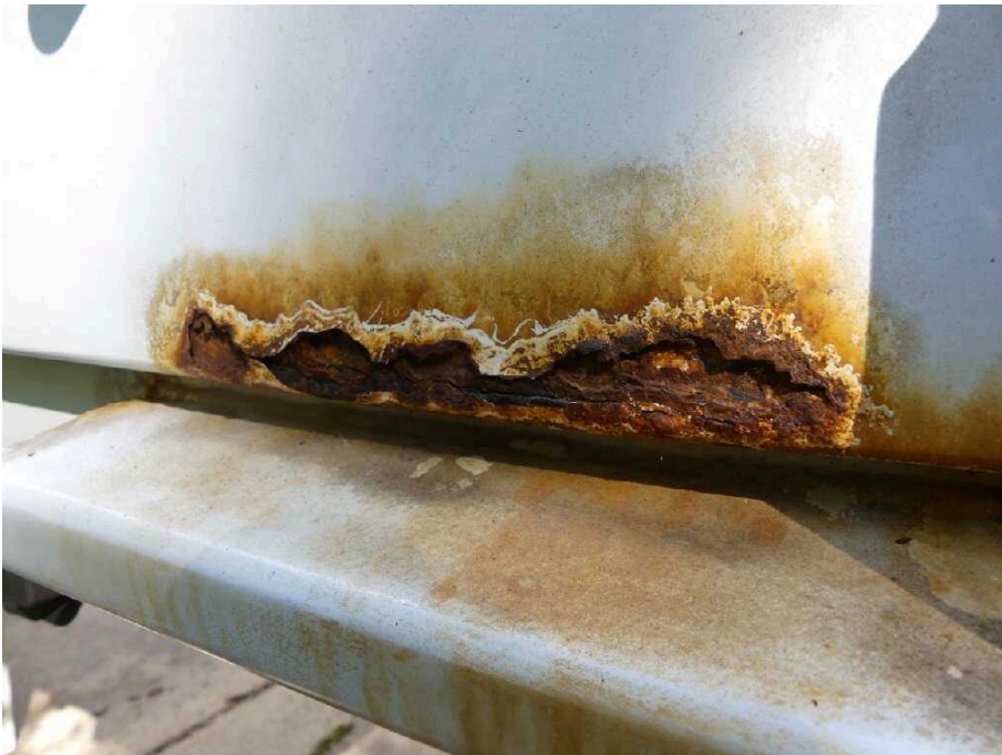
Bild 10 Fahrzeugheck Heckflügeltür rechts stark korrodiert
