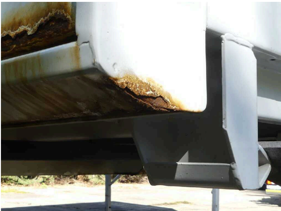
Bild 14 Fahrzeugheck Rahmen hinten rechts korrodiert
