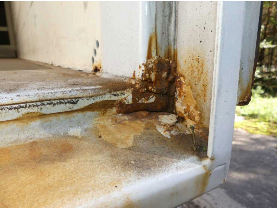
Bild 20 Fahrzeugheck Rahmen hinten rechts korrodiert
