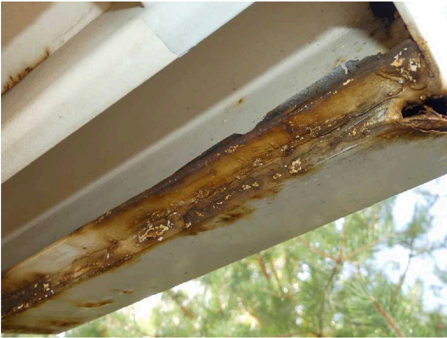
Bild 25 Fahrzeugheck Rahmen hinten links stark korrodiert
