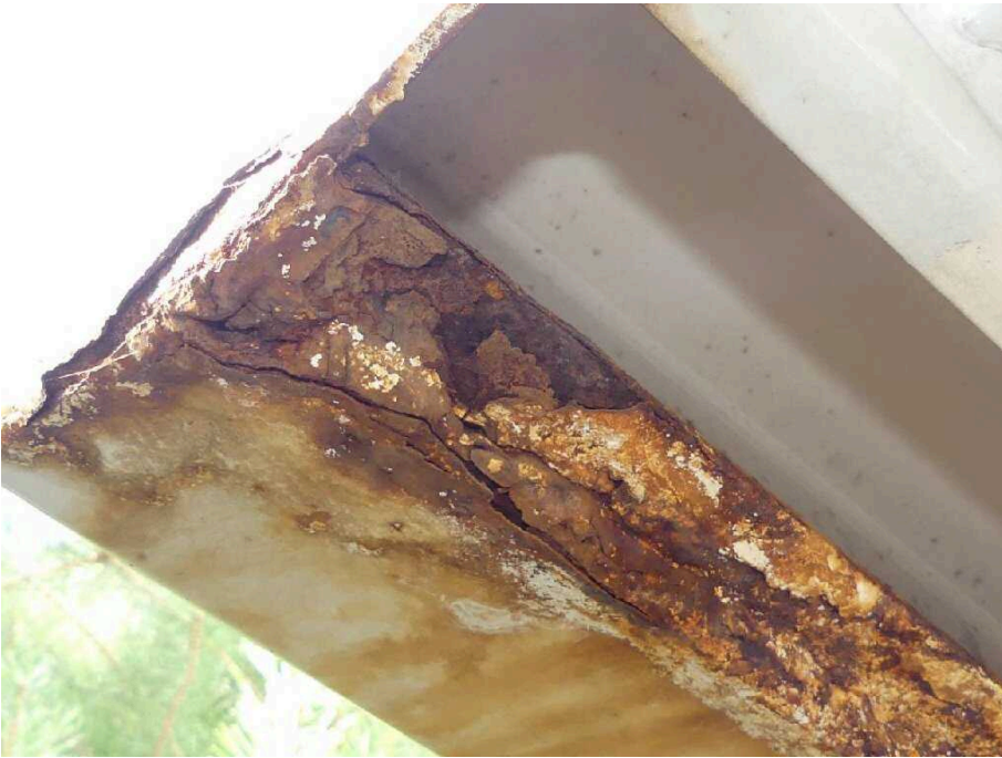
Bild 19 Fahrzeugheck Rahmen hinten rechts korrodiert
