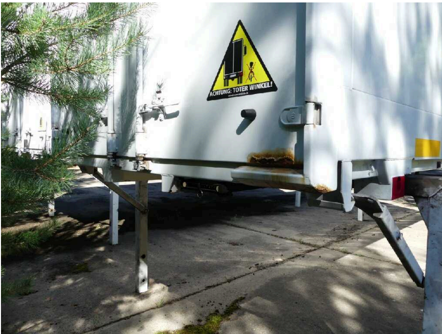
Bild 9 Fahrzeugheck Heckflügeltür rechts stark korrodiert
