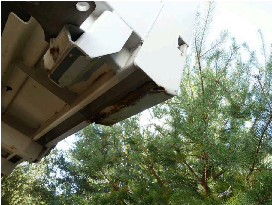
Bild 22 Fahrzeugheck Rahmen hinten links stark korrodiert
