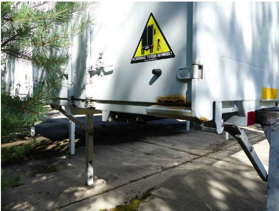
Bild 13 Fahrzeugheck Rahmen hinten rechts korrodiert
