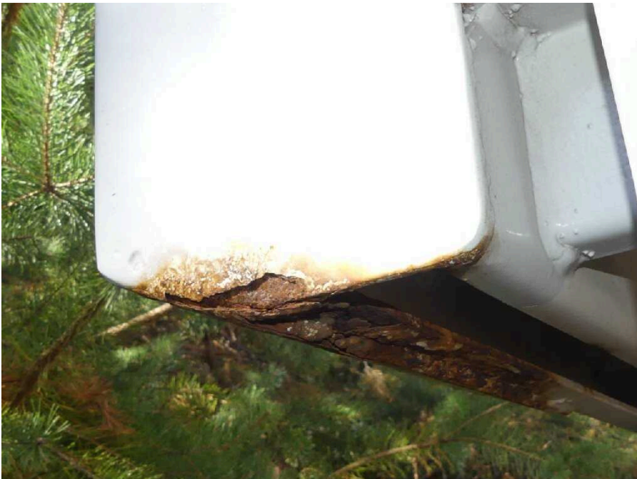
Bild 16 Fahrzeugheck Rahmen hinten rechts korrodiert
