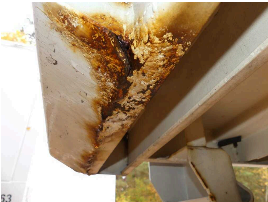
Bild 28 Fahrzeugheck Rahmen hinten links korrodiert
