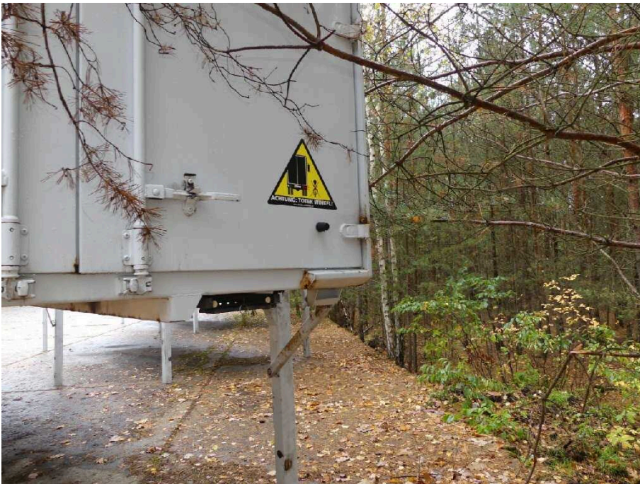
Bild 37 Fahrzeugheck Ecksäule hinten rechts stark korrodiert
