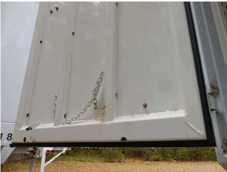
Bild 34 Fahrzeugheck Heckflügeltür links korrodiert
