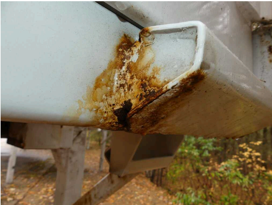
Bild 31 Fahrzeugheck Rahmen hinten rechts korrodiert
