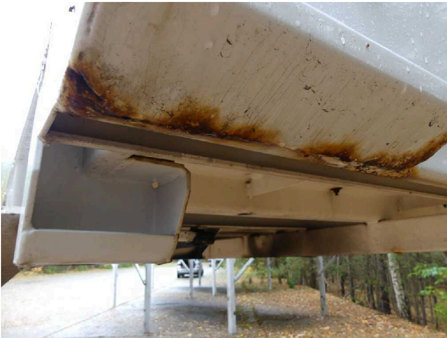
Bild 25 Fahrzeugheck Rahmen hinten links korrodiert
