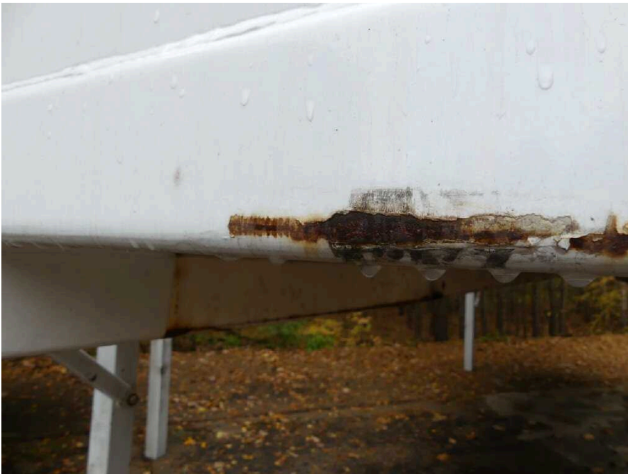
Bild 10 Aufbau Bodenrahmen vorne korrodiert
