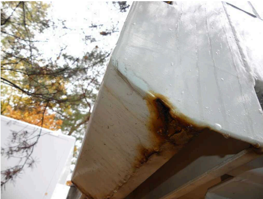
Bild 33 Fahrzeugheck Rahmen hinten rechts korrodiert
