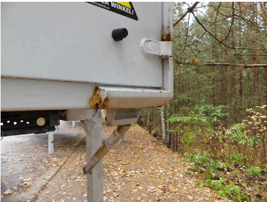
Bild 30 Fahrzeugheck Rahmen hinten rechts korrodiert
