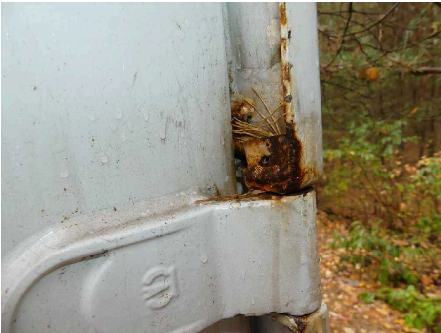
Bild 38 Fahrzeugheck Ecksäule hinten rechts stark korrodiert
