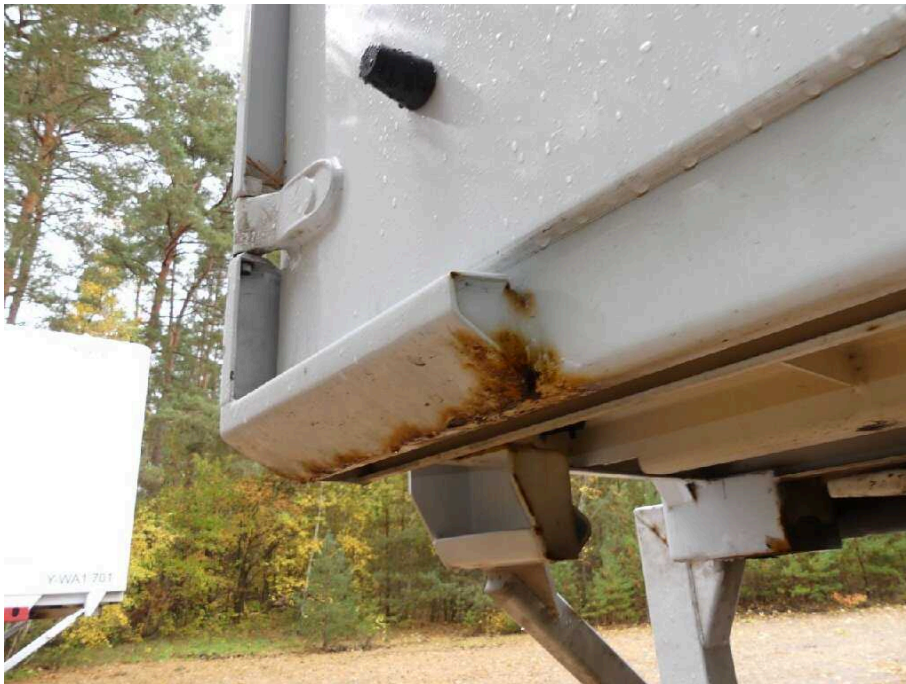
Bild 27 Fahrzeugheck Rahmen hinten links korrodiert
