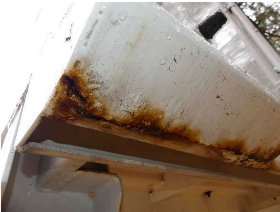
Bild 26 Fahrzeugheck Rahmen hinten links korrodiert
