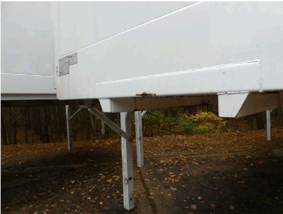
Bild 9 Aufbau Bodenrahmen vorne korrodiert
