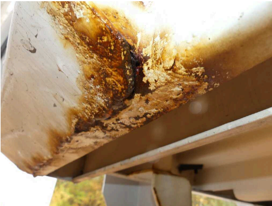
Bild 29 Fahrzeugheck Rahmen hinten links korrodiert
