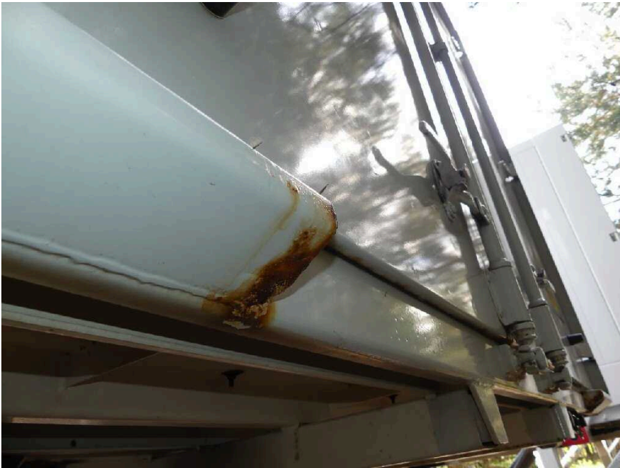
Bild 17 Fahrzeug Rahmen hi.li. korrodiert
