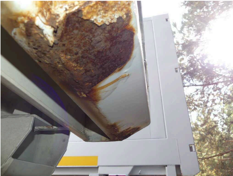
Bild 11 Fahrzeug Rahmen hi.re. korrodiert
