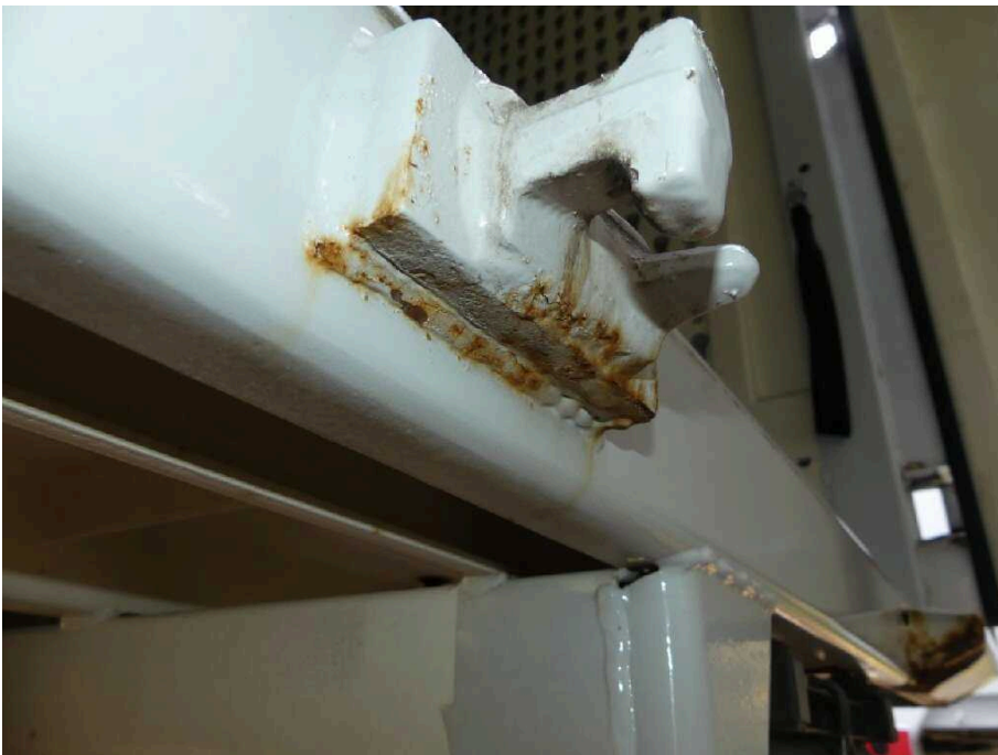
Bild 14 Fahrzeug Rahmen hi.re. korrodiert
