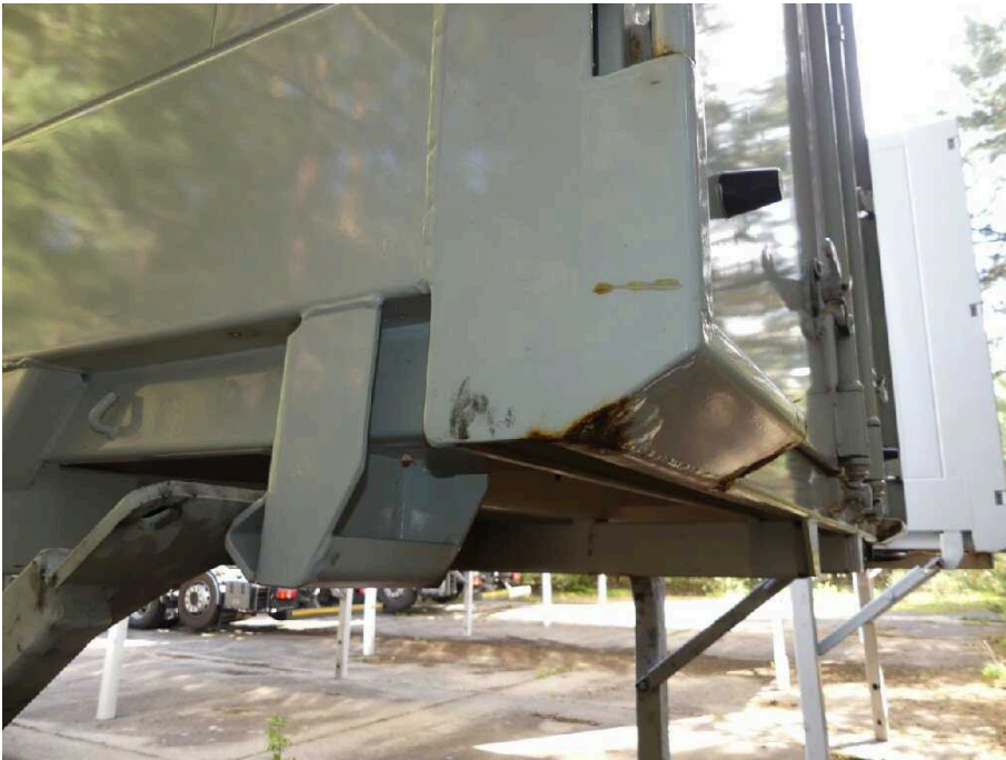
Bild 15 Fahrzeug Rahmen hi.li. korrodiert
