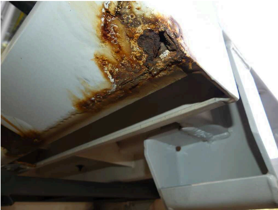
Bild 13 Fahrzeug Rahmen hi.re. korrodiert
