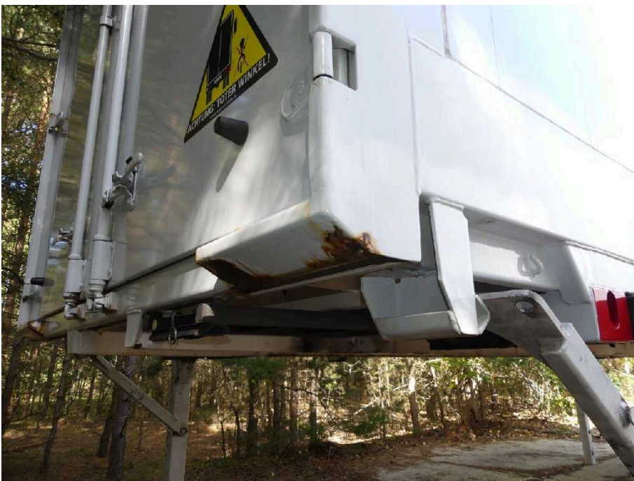
Bild 12 Fahrzeug Rahmen hi.re. korrodiert
