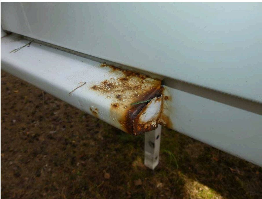
Bild 20 Fahrzeug Rahmen hi.li. korrodiert
