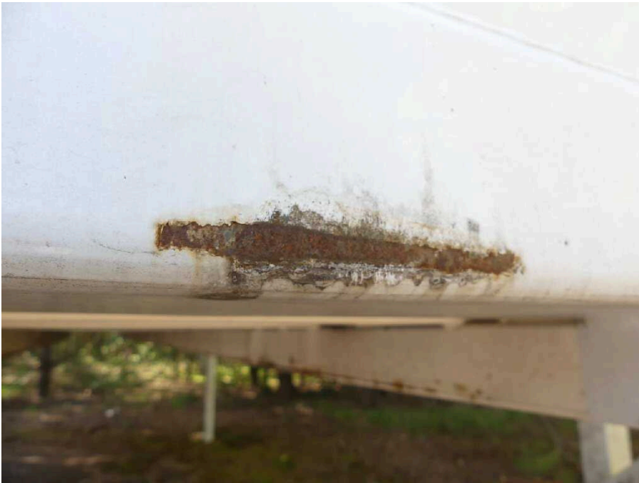
Bild 25 Fahrzeug Rahmen vorn korrodiert
