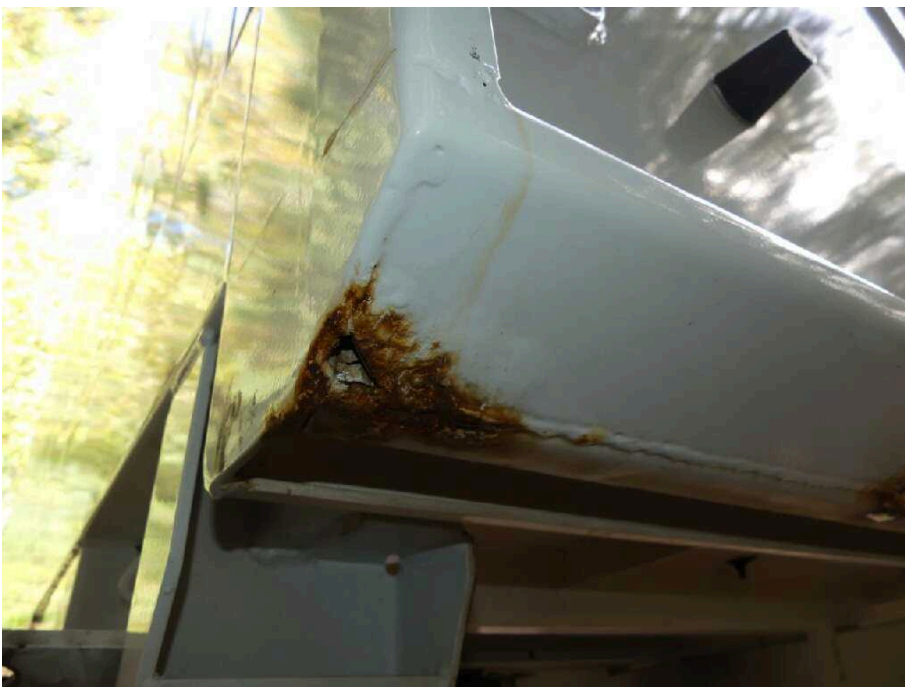
Bild 16 Fahrzeug Rahmen hi.li. korrodiert
