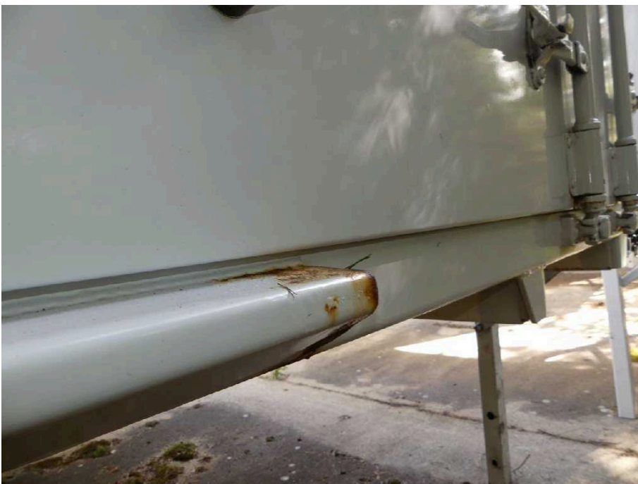
Bild 18 Fahrzeug Rahmen hi.li. korrodiert
