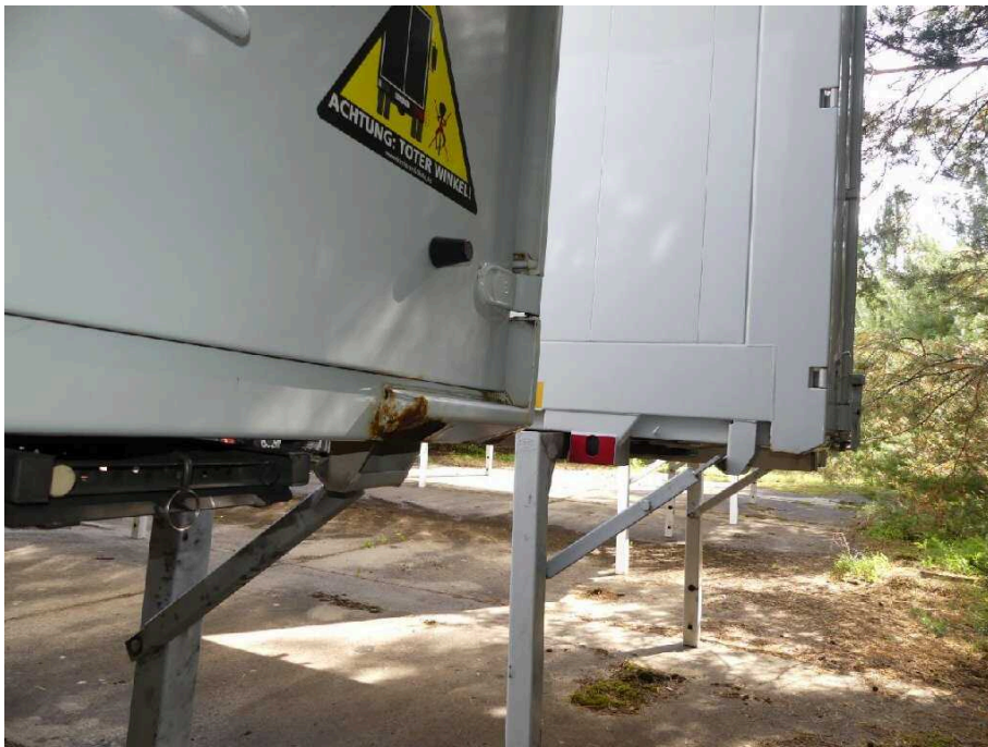
Bild 9 Fahrzeug Rahmen hi.re. korrodiert
