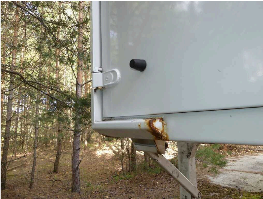
Bild 19 Fahrzeug Rahmen hi.li. korrodiert
