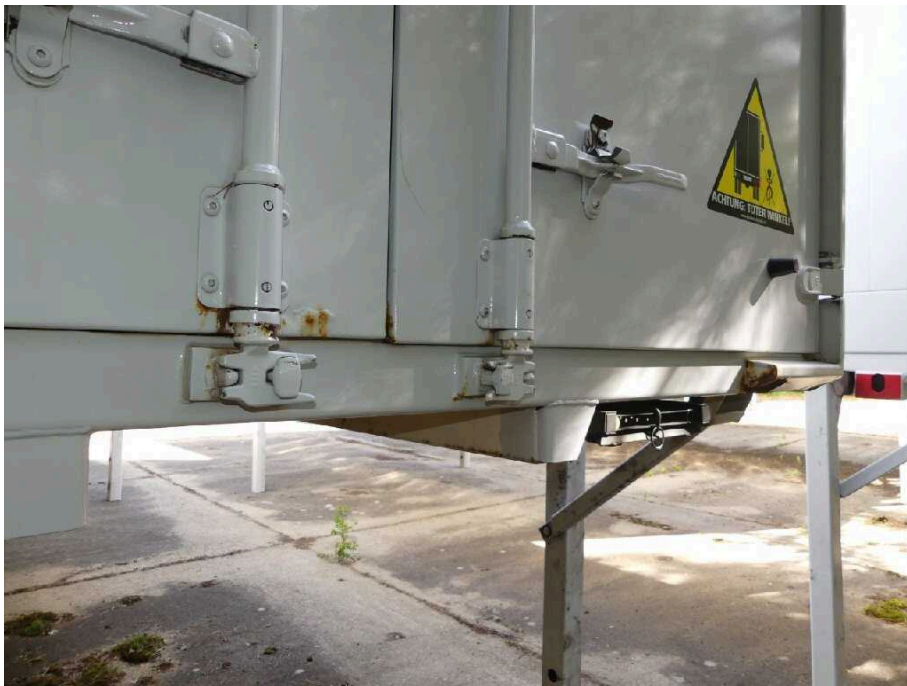
Bild 21 Fahrzeugheck Heckflügeltür links korrodiert
