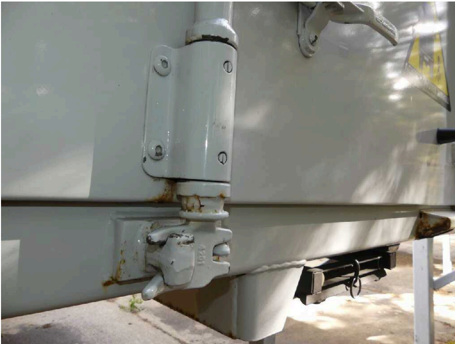
Bild 23 Fahrzeugheck Heckflügeltür links korrodiert
