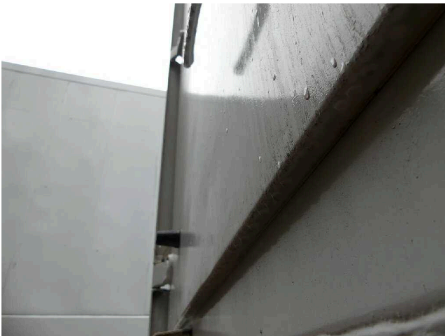
Bild 38 Fahrzeugheck Heckflügeltür links deformiert
