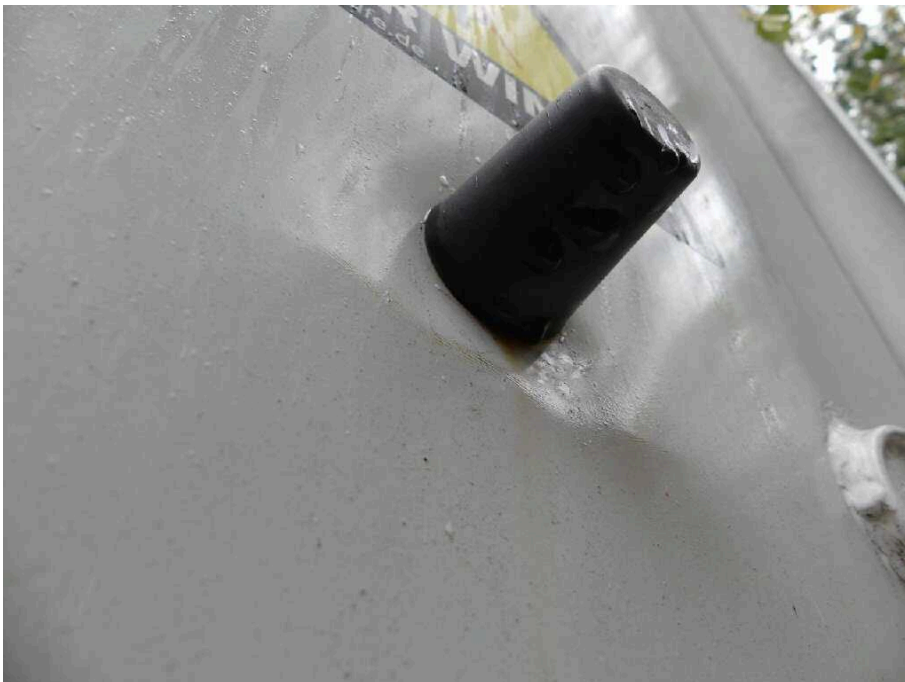
Bild 34 Fahrzeugheck Heckflügeltür rechts eingedrückt
