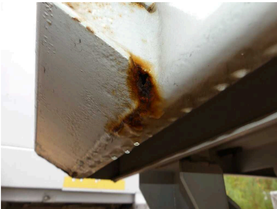
Bild 28 Fahrzeugheck Rahmen hinten links korrodiert
