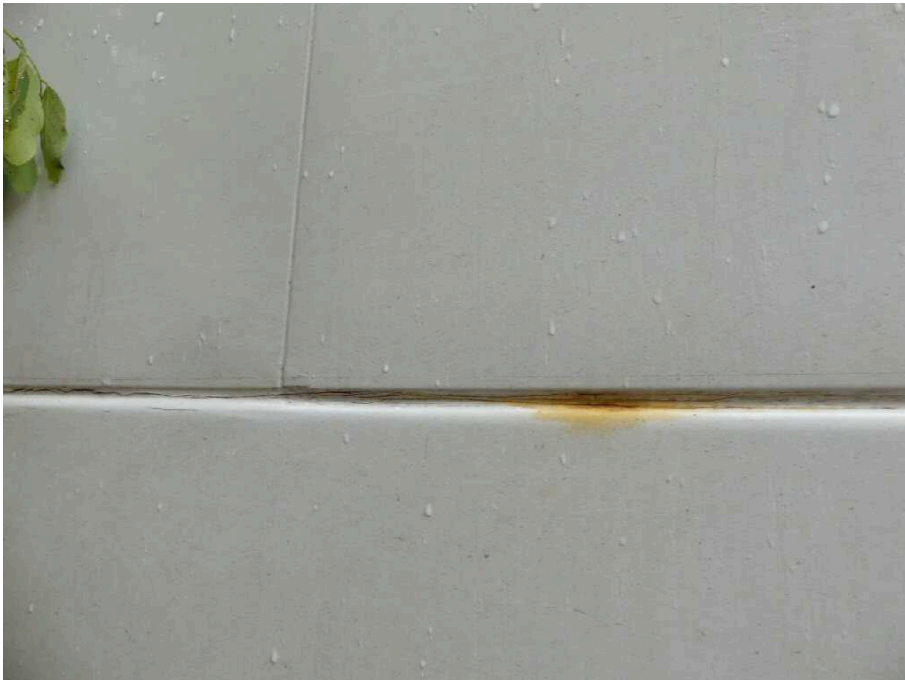
Bild 14 Fahrzeug Fahrzeug aussen rechts, korrodiert und verkratzt
