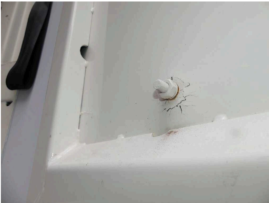
Bild 36 Fahrzeugheck Heckflügeltür rechts eingedrückt
