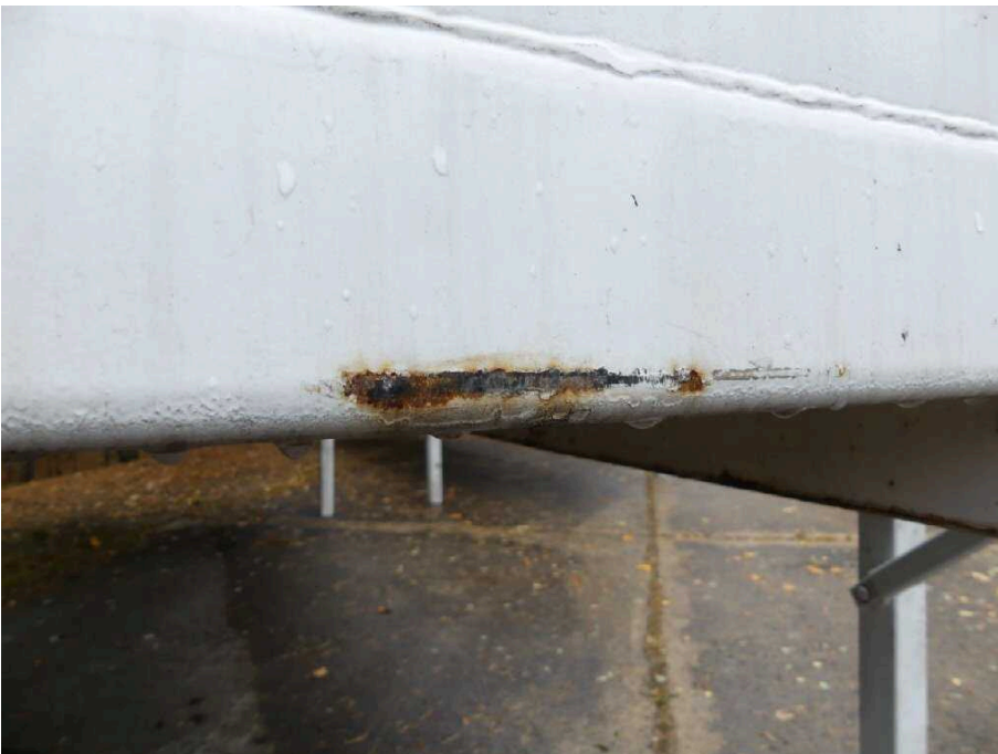
Bild 10 Aufbau Bodenrahmen vorne korrodiert
