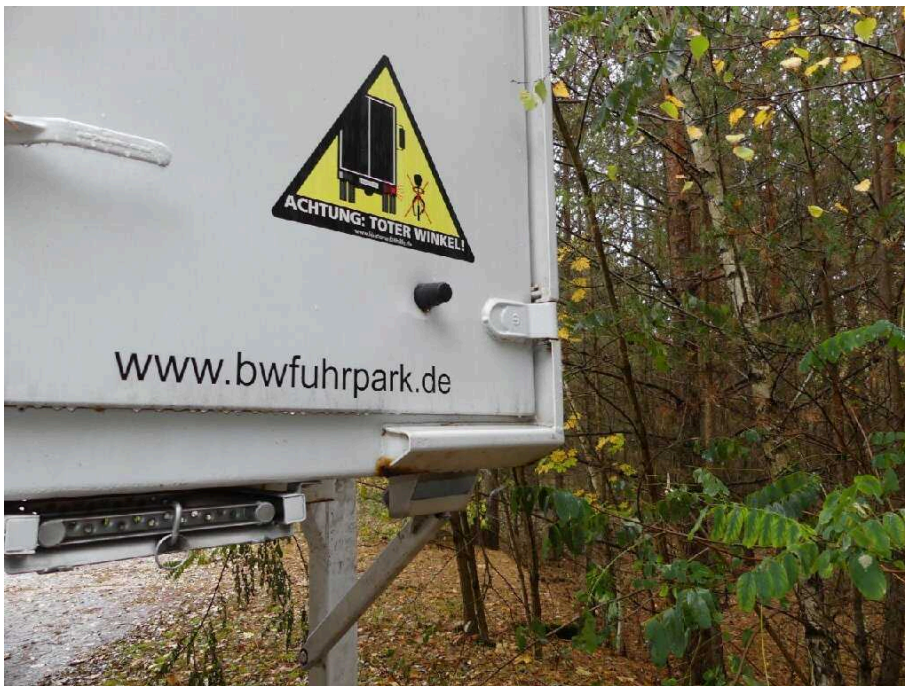
Bild 31 Fahrzeugheck Heckflügeltür rechts eingedrückt
