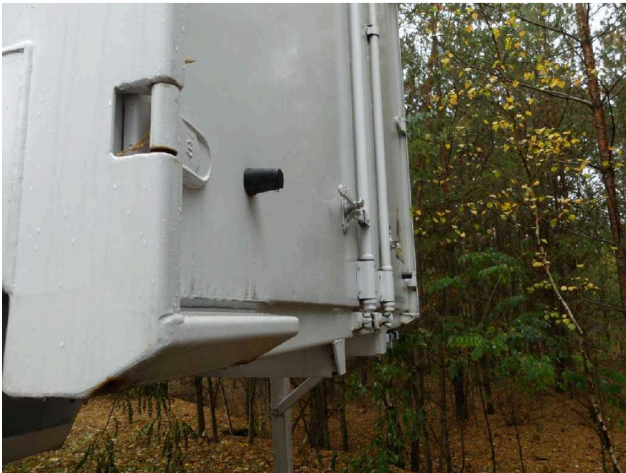
Bild 39 Fahrzeugheck Heckflügeltür links deformiert
