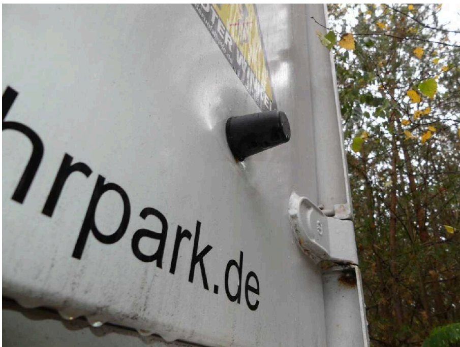
Bild 32 Fahrzeugheck Heckflügeltür rechts eingedrückt
