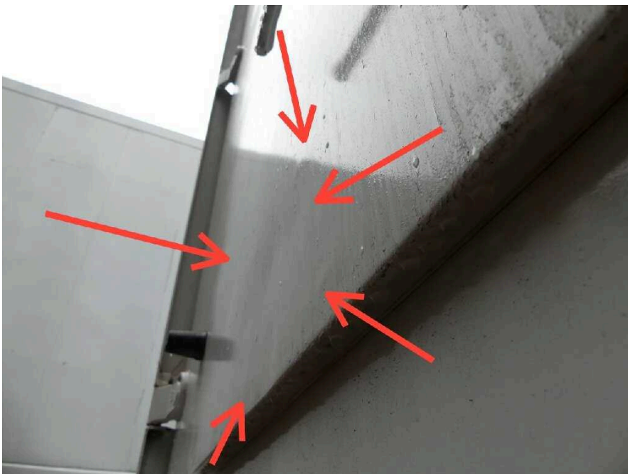
Bild 40 Fahrzeugheck Heckflügeltür links deformiert
