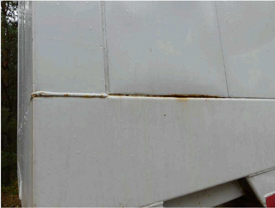
Bild 17 Fahrzeug Fahrzeug aussen links, korrodiert und verkratzt
