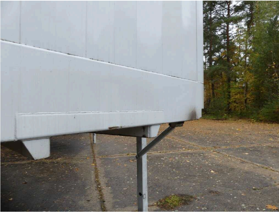
Bild 9 Aufbau Bodenrahmen vorne korrodiert
