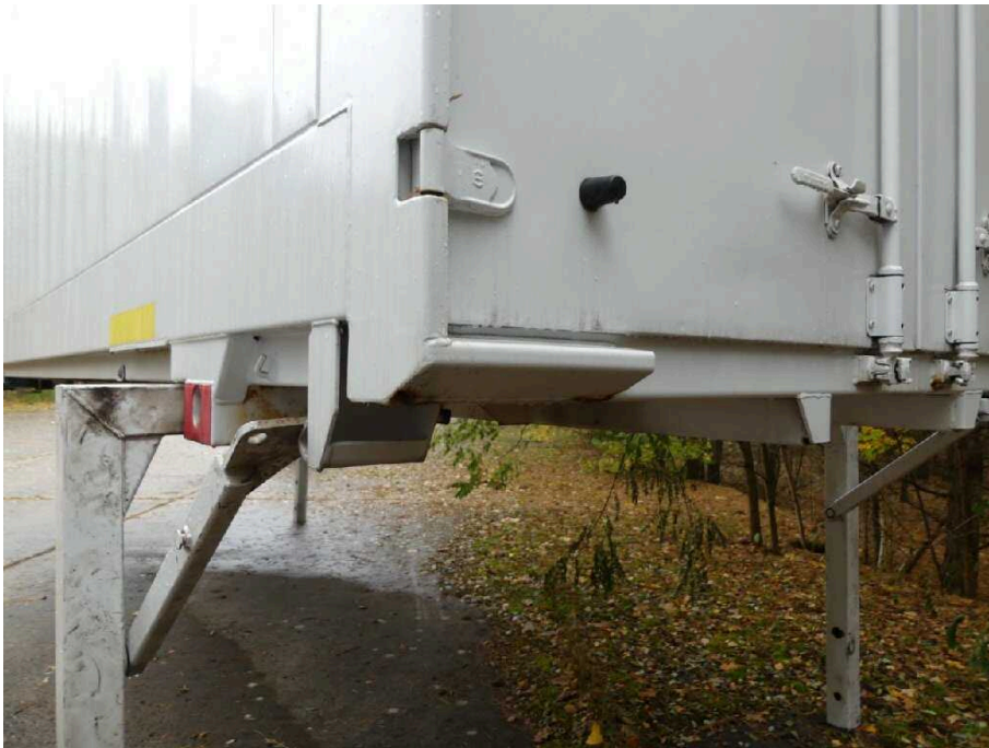
Bild 25 Fahrzeugheck Rahmen hinten links korrodiert
