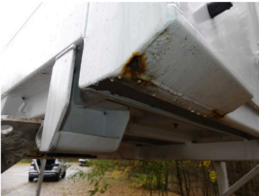
Bild 26 Fahrzeugheck Rahmen hinten links korrodiert
