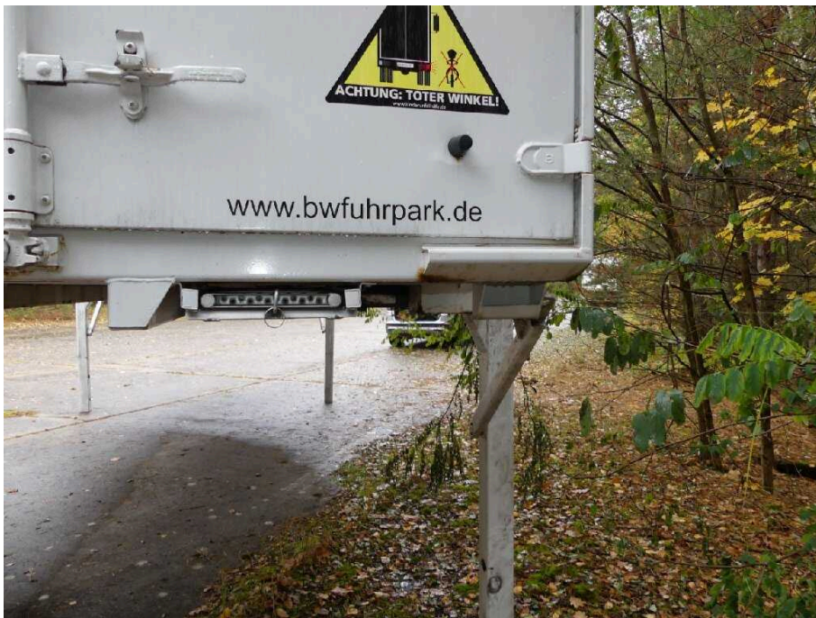
Bild 29 Fahrzeugheck Rahmen hinten rechts korrodiert
