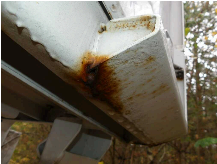
Bild 30 Fahrzeugheck Rahmen hinten rechts korrodiert
