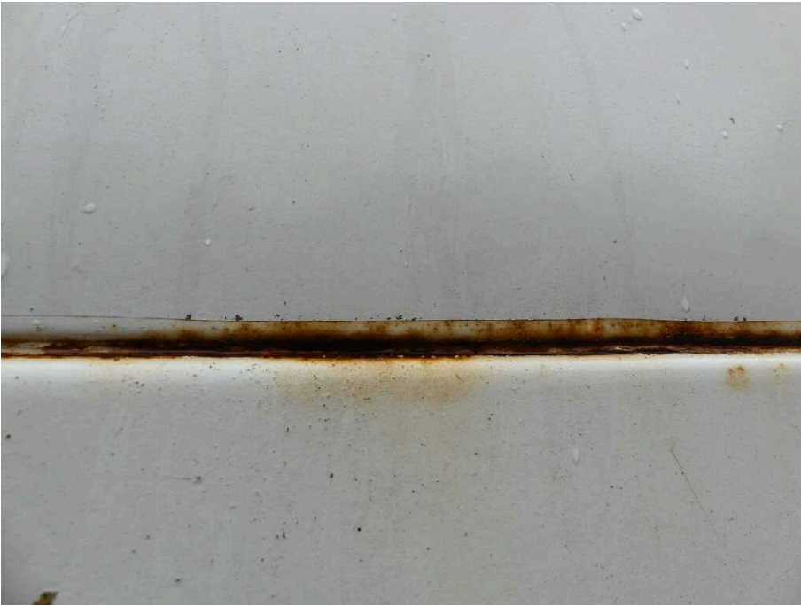
Bild 19 Fahrzeug Fahrzeug aussen links, korrodiert und verkratzt
