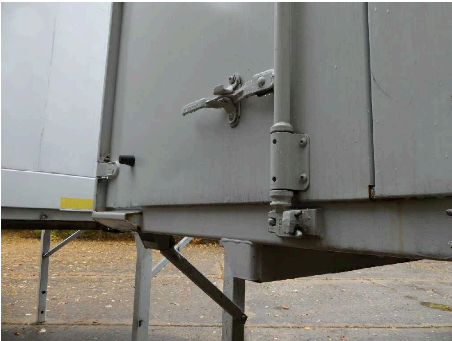
Bild 37 Fahrzeugheck Heckflügeltür links deformiert
