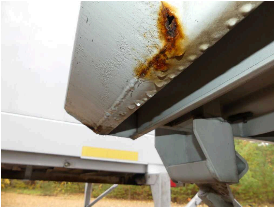
Bild 27 Fahrzeugheck Rahmen hinten links korrodiert
