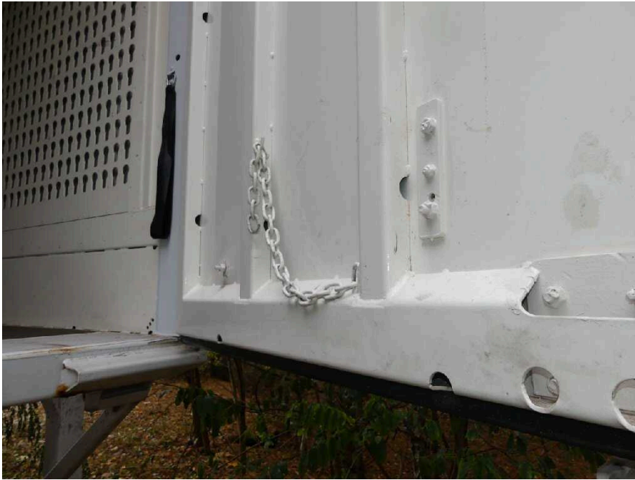
Bild 35 Fahrzeugheck Heckflügeltür rechts eingedrückt
