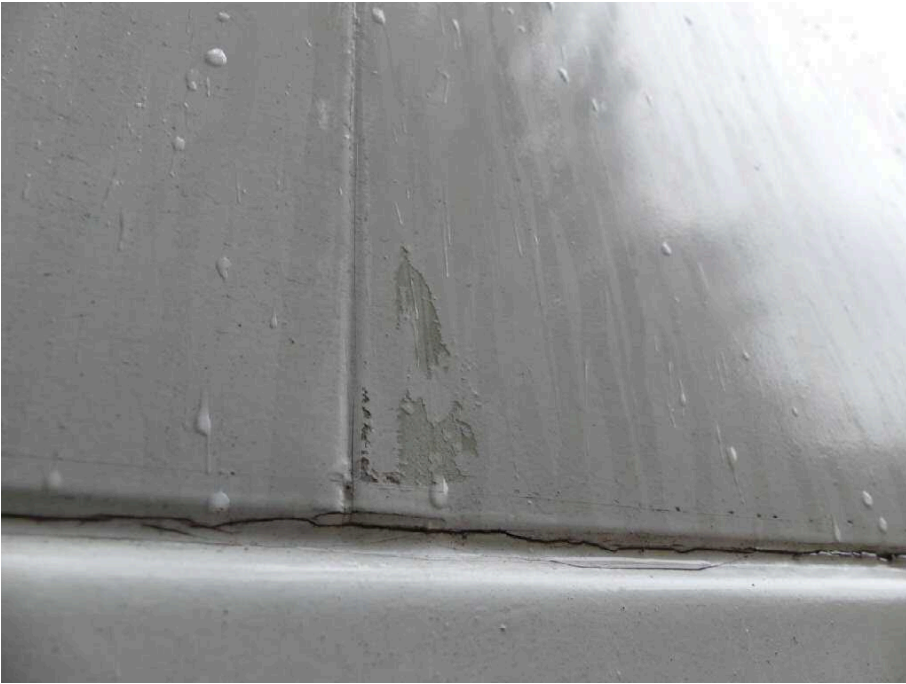
Bild 15 Fahrzeug aussen rechts, korrodiert und verkratzt
