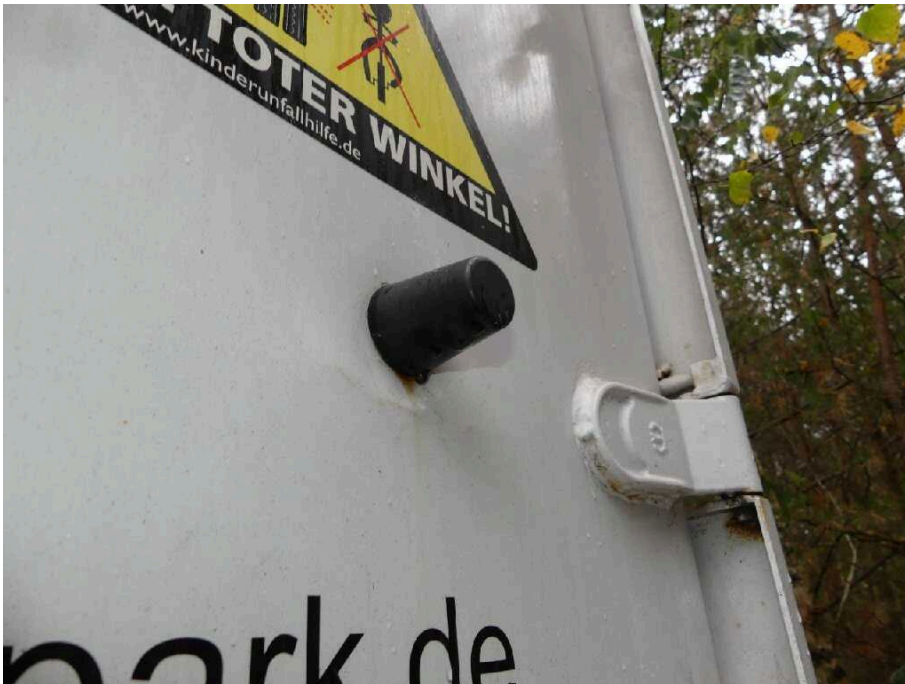
Bild 33 Fahrzeugheck Heckflügeltür rechts eingedrückt
