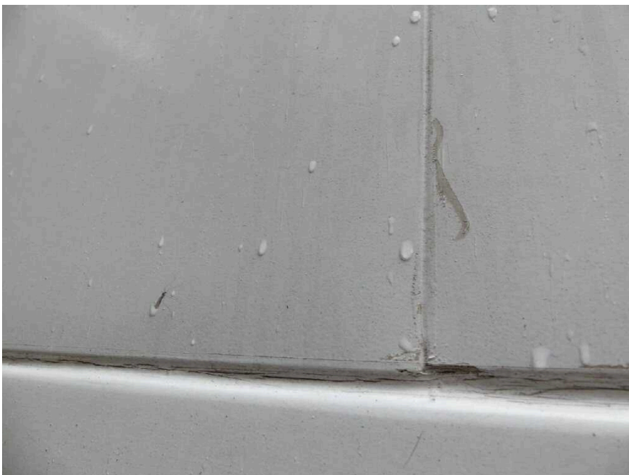
Bild 12 Fahrzeug Fahrzeug aussen rechts, korrodiert und verkratzt
