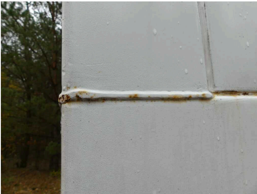
Bild 18 Fahrzeug Fahrzeug aussen links, korrodiert und verkratzt
