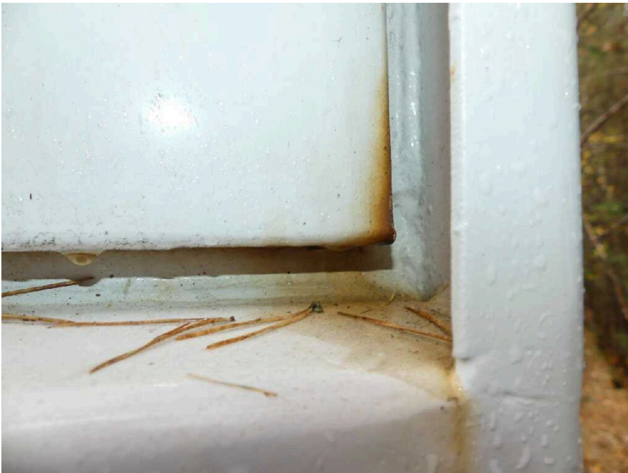
Bild 40 Fahrzeugheck Heckflügeltür rechts korrodiert
