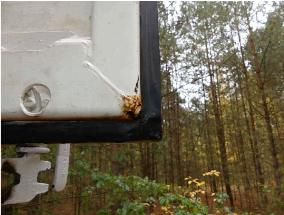
Bild 41 Fahrzeugheck Heckflügeltür rechts korrodiert
