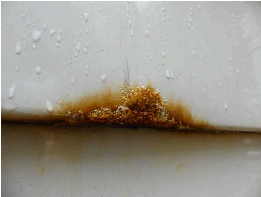
Bild 29 Fahrzeugheck Heckflügeltür links stark korrodiert
