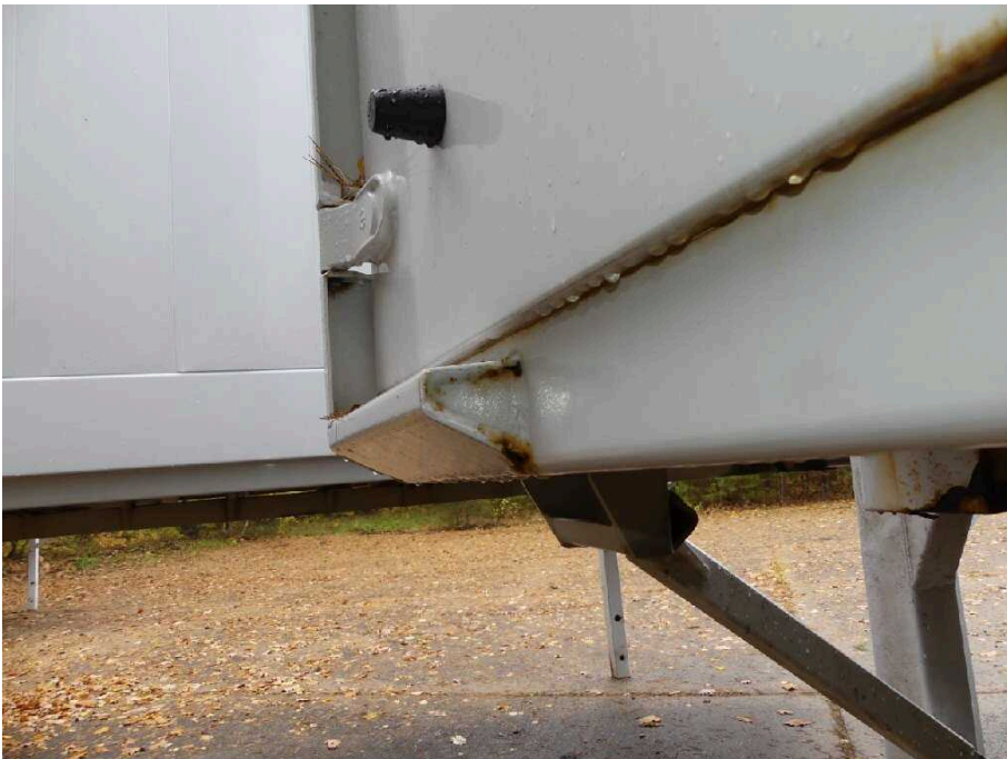
Bild 32 Fahrzeugheck Rahmen hinten links korrodiert
