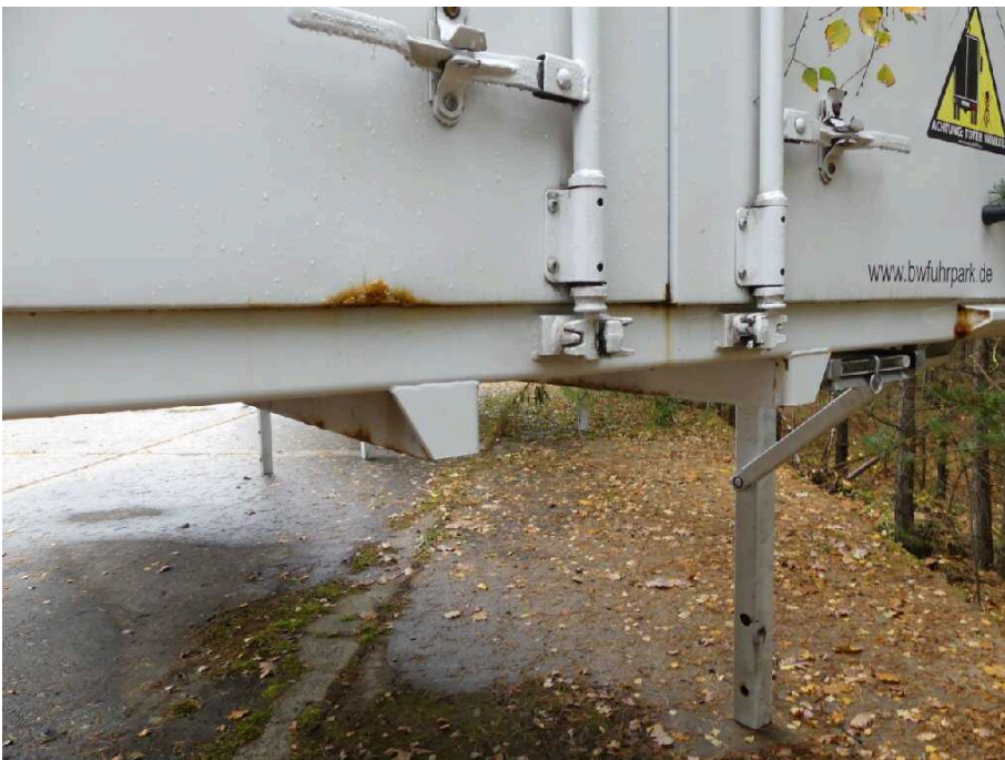
Bild 28 Fahrzeugheck Heckflügeltür links stark korrodiert
