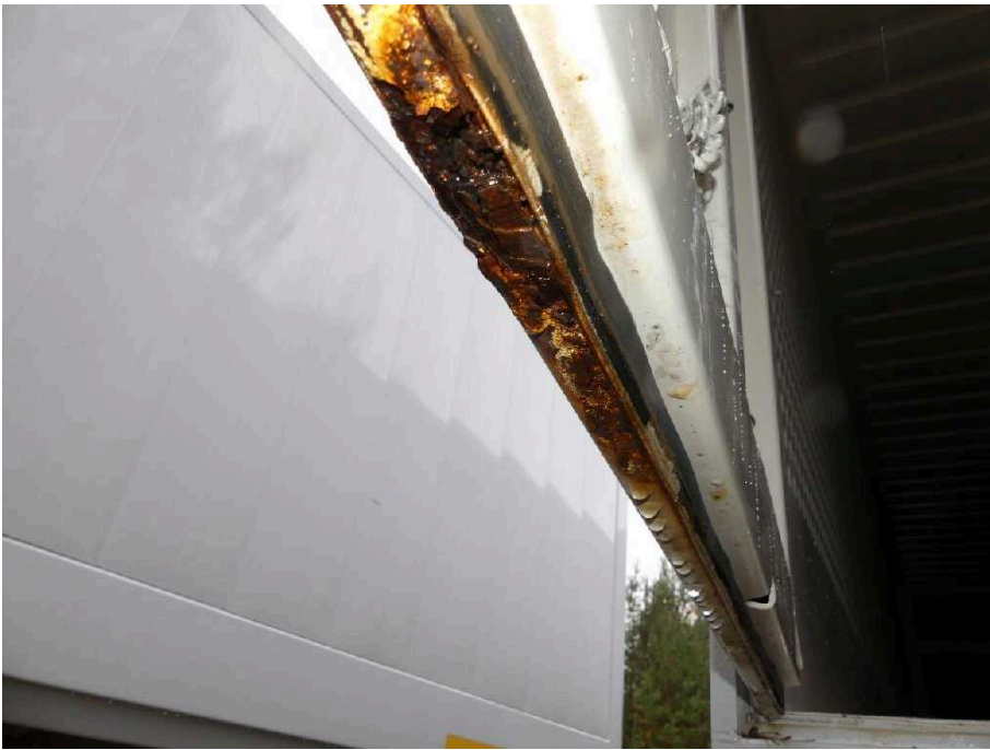
Bild 31 Fahrzeugheck Heckflügeltür links stark korrodiert
