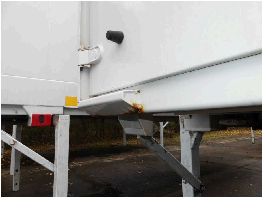
Bild 20 Fahrzeugheck Rahmen hinten links stark korrodiert
