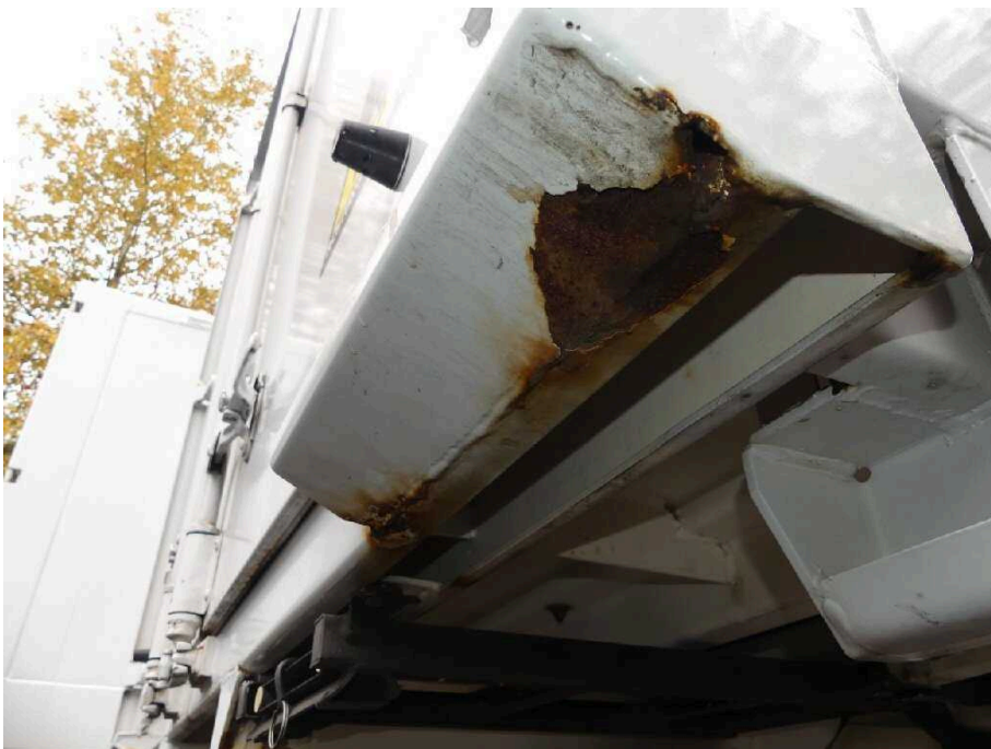
Bild 10 Fahrzeugheck Rahmen hinten rechts stark korrodiert
