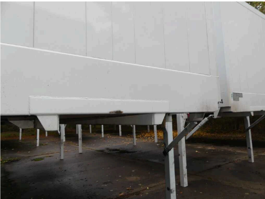
Bild 24 Aufbau Bodenrahmen vorne korrodiert
