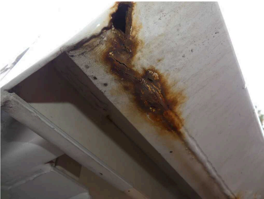
Bild 23 Fahrzeugheck Rahmen hinten links stark korrodiert
