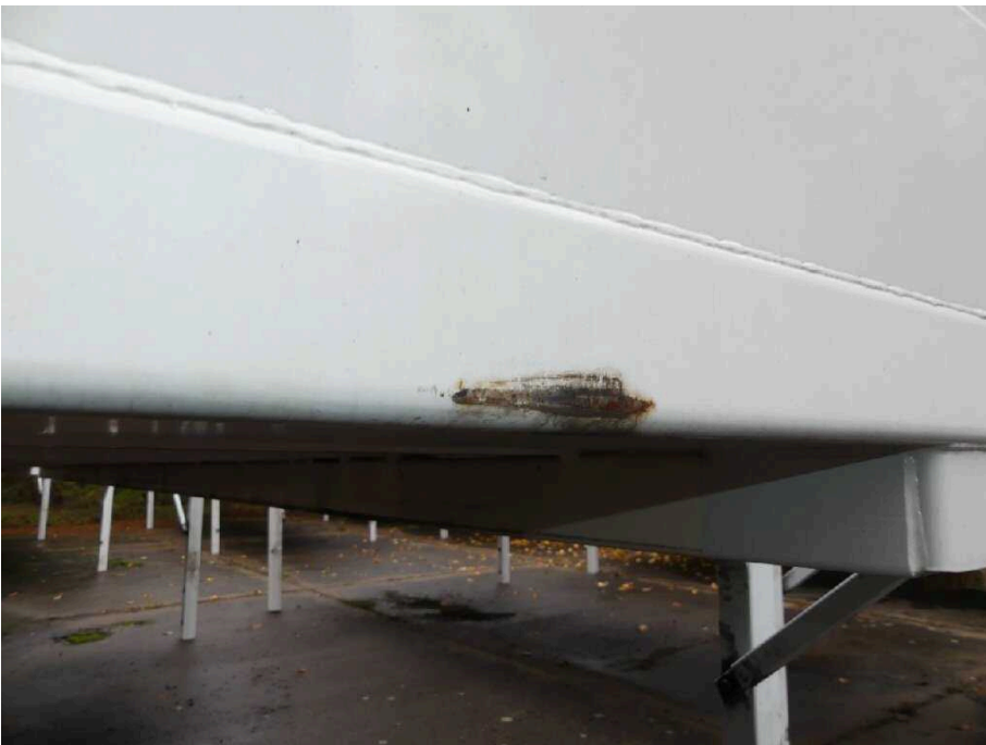
Bild 25 Aufbau Bodenrahmen vorne korrodiert
