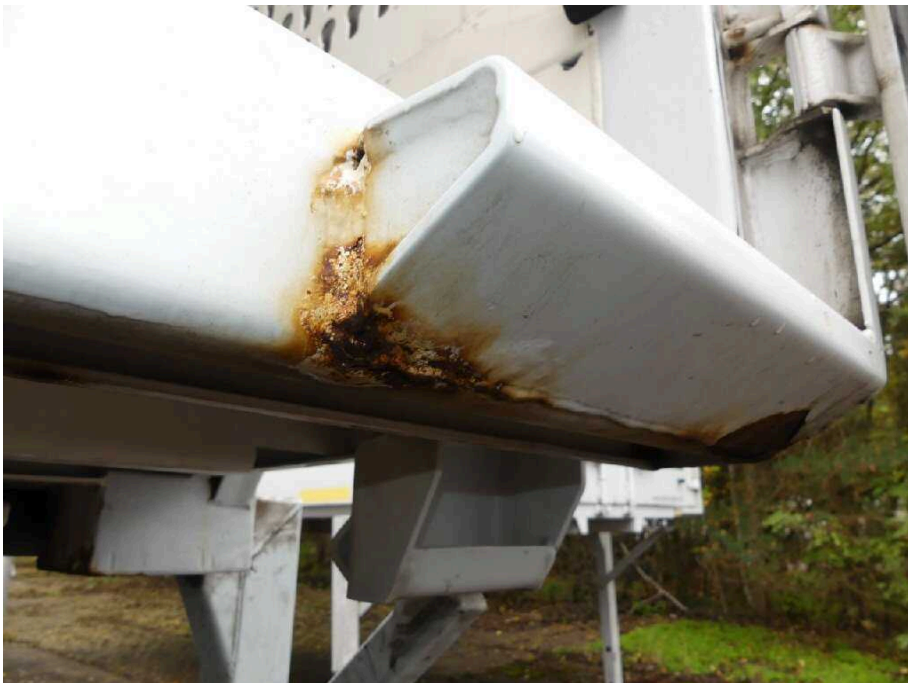
Bild 12 Fahrzeugheck Rahmen hinten rechts stark korrodiert
