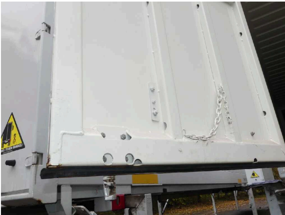
Bild 19 Fahrzeugheck Heckflügeltür links korrodiert
