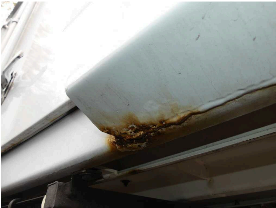
Bild 11 Fahrzeugheck Rahmen hinten rechts stark korrodiert
