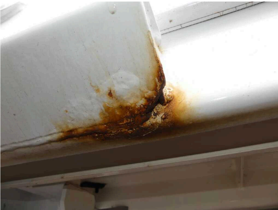
Bild 21 Fahrzeugheck Rahmen hinten links stark korrodiert
