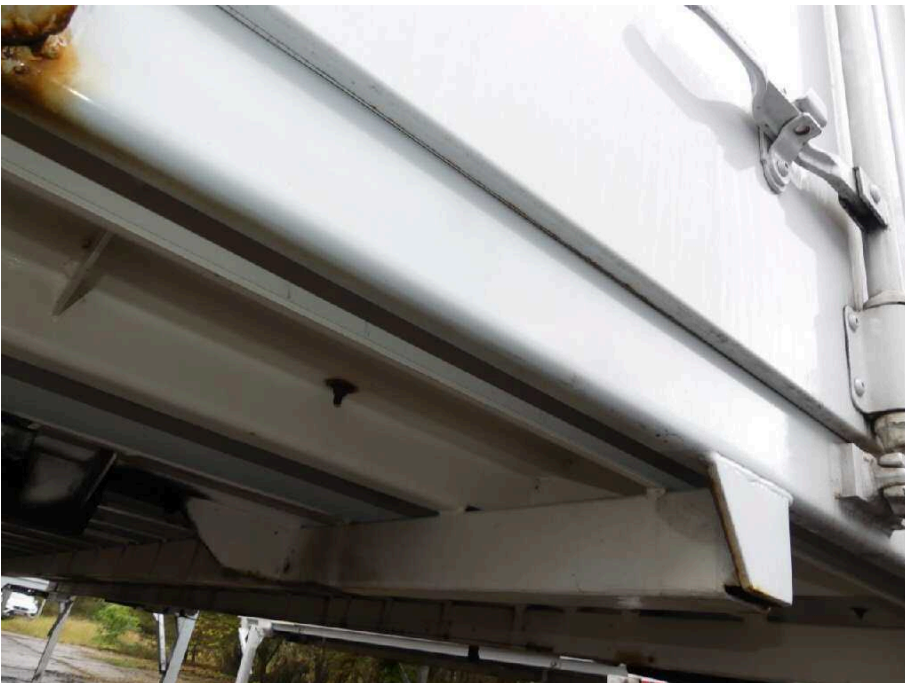
Bild 16 Fahrzeugheck Heckflügeltür links korrodiert
