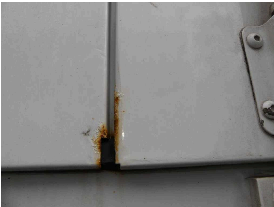
Bild 14 Fahrzeugheck Heckflügeltür links korrodiert
