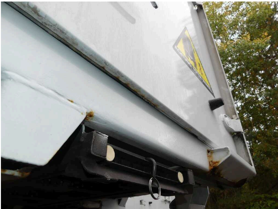
Bild 28 Fahrzeugheck Heckflügeltür rechts verkratzt und stark korrodiert
