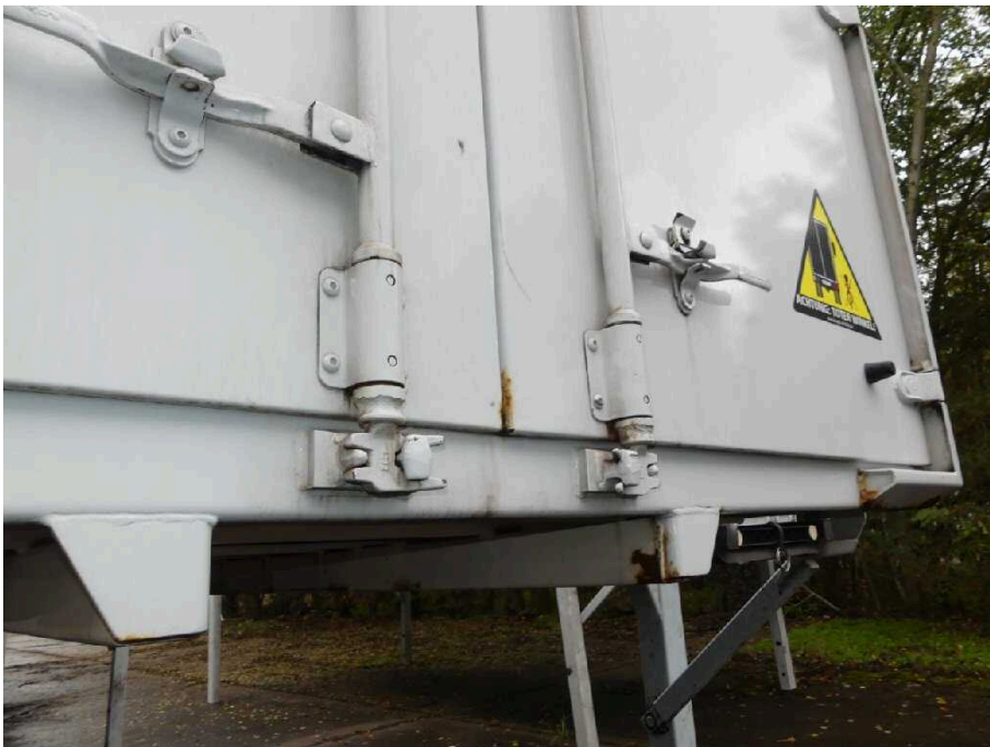
Bild 27 Fahrzeugheck Heckflügeltür rechts verkratzt und stark korrodiert
