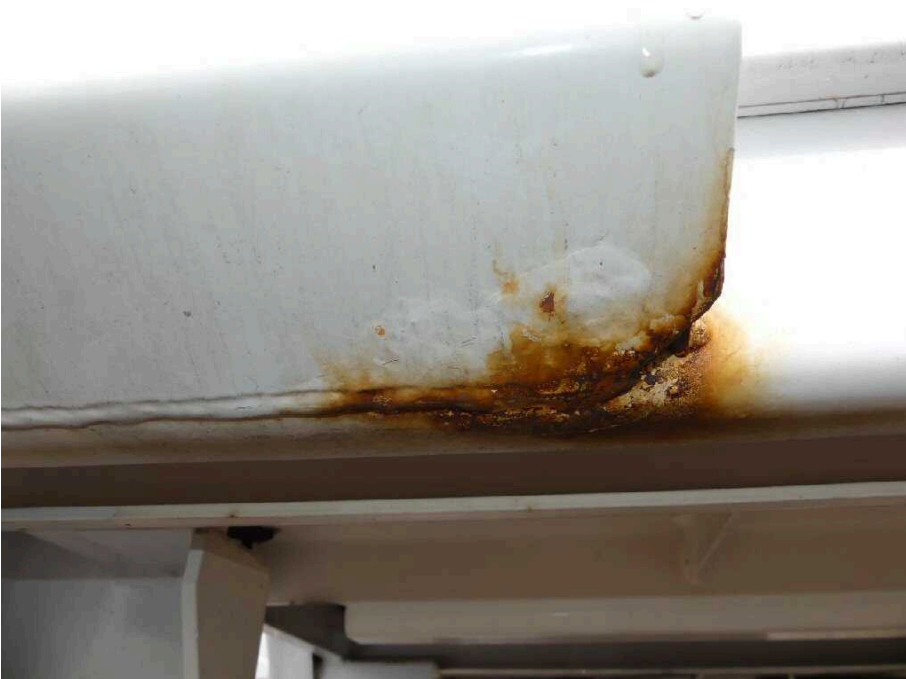
Bild 22 Fahrzeugheck Rahmen hinten links stark korrodiert
