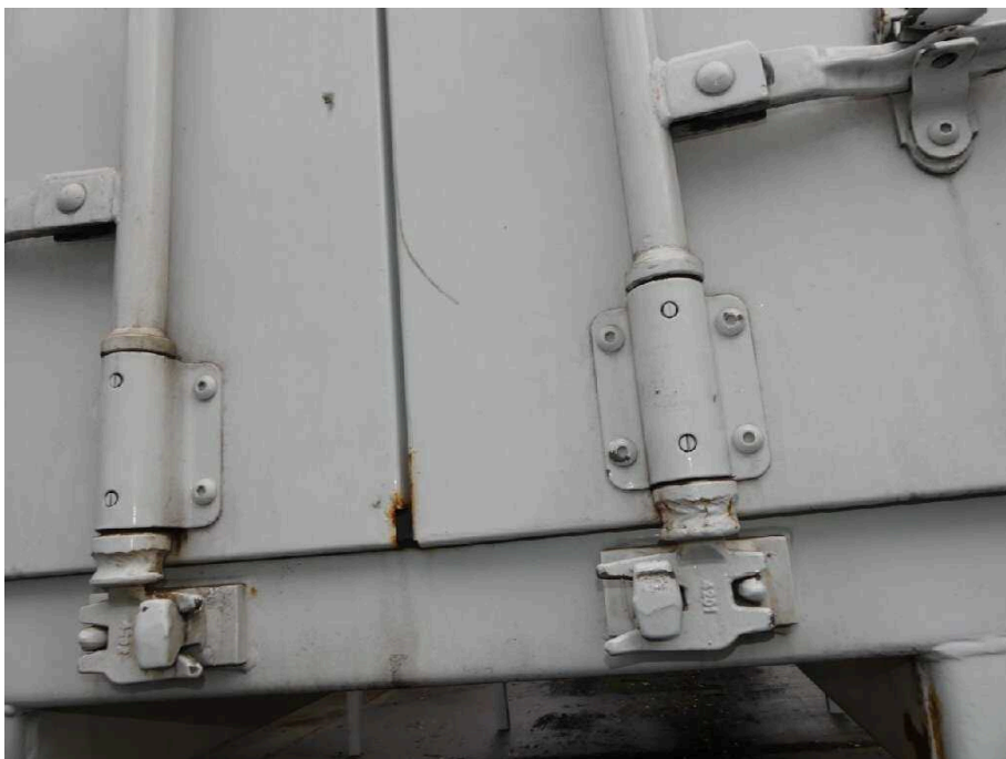
Bild 13 Fahrzeugheck Heckflügeltür links korrodiert
