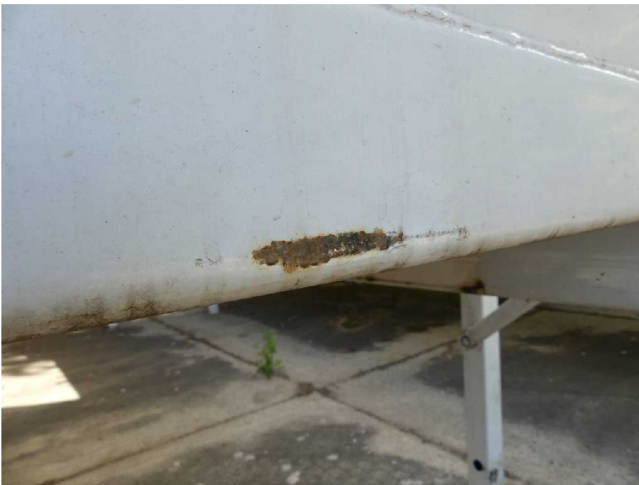
Bild 15 Fahrzeug Rahmen vorn korrodiert
