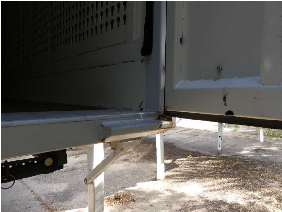
Bild 22 Fahrzeugheck Heckflügeltür rechts innen korrodiert
