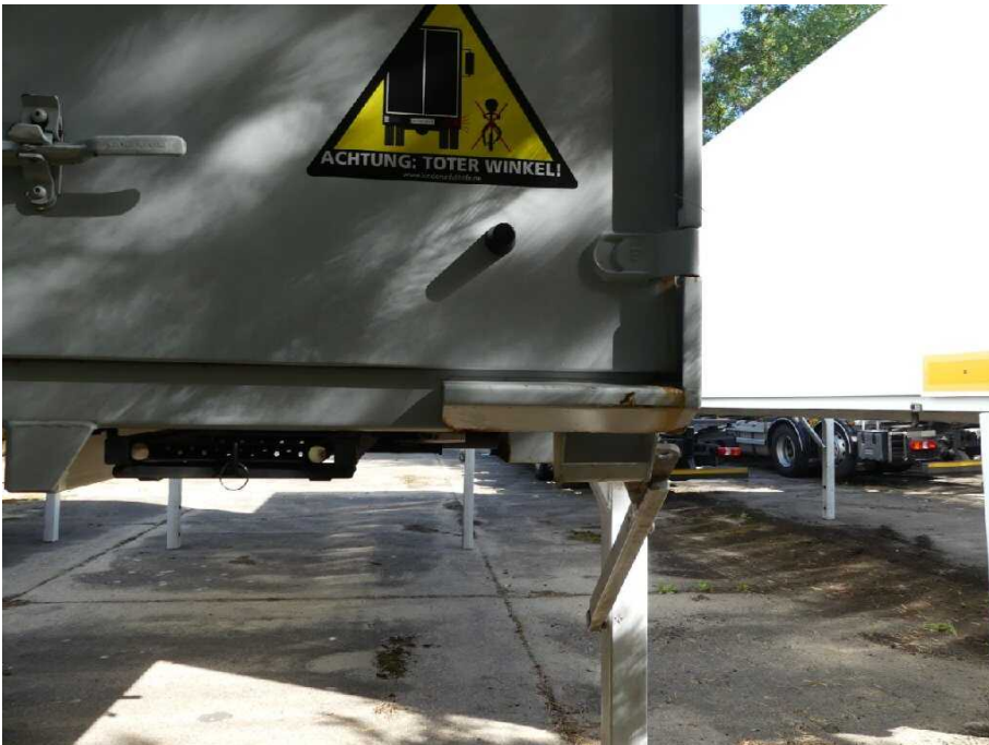
Bild 16 Fahrzeug Rahmen hinten rechts korrodiert
