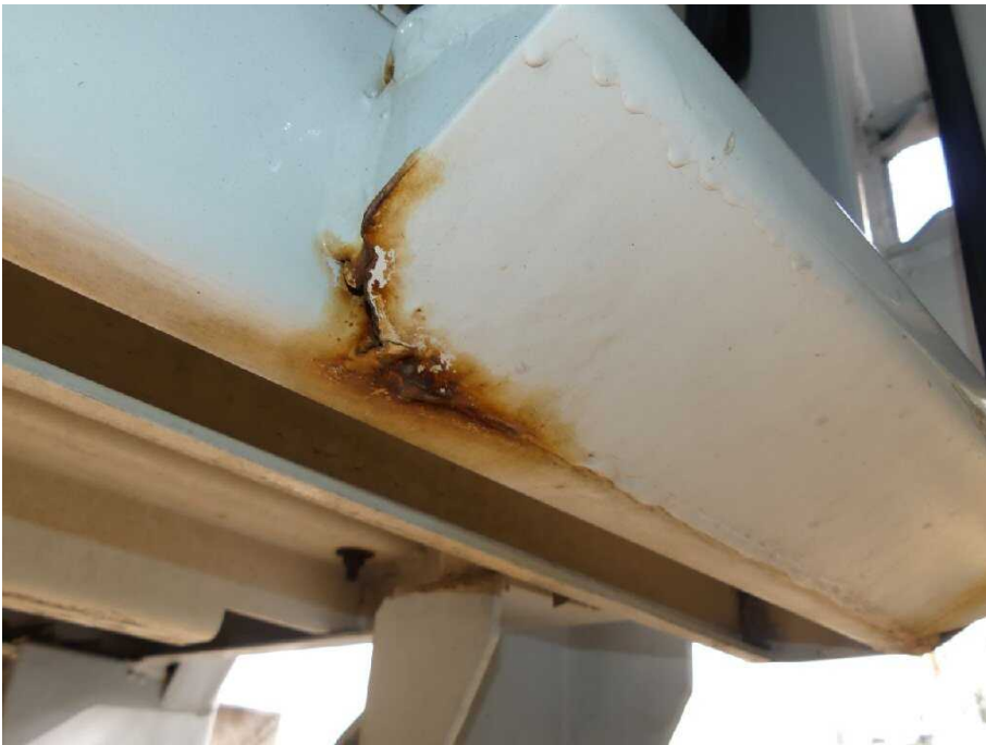
Bild 21 Fahrzeug Rahmen hinten rechts korrodiert
