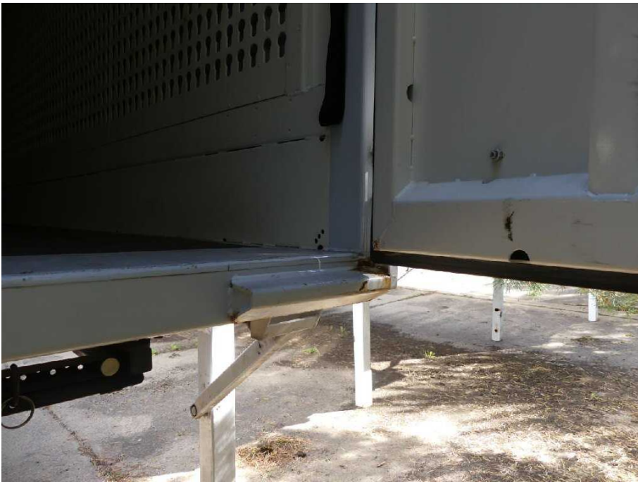
Bild 19 Fahrzeug Rahmen hinten rechts korrodiert
