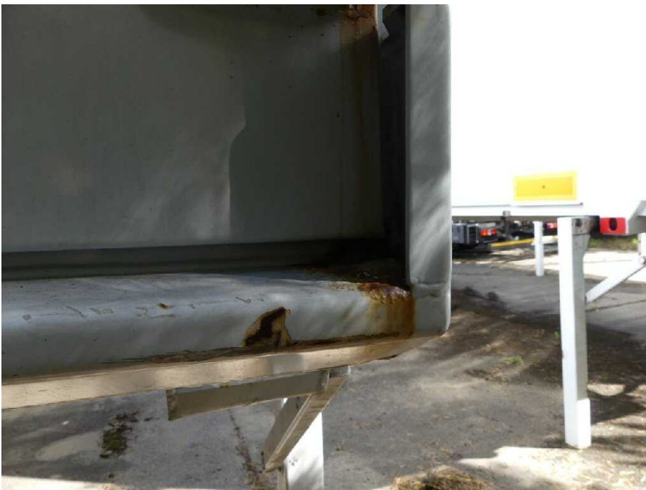
Bild 17 Fahrzeug Rahmen hinten rechts korrodiert
