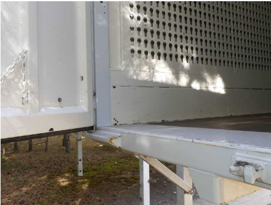
Bild 11 Fahrzeug Rahmen hi.li. korrodiert
