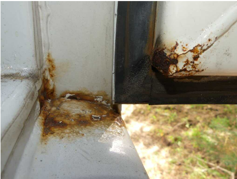
Bild 23 Fahrzeugheck Heckflügeltür rechts innen korrodiert
