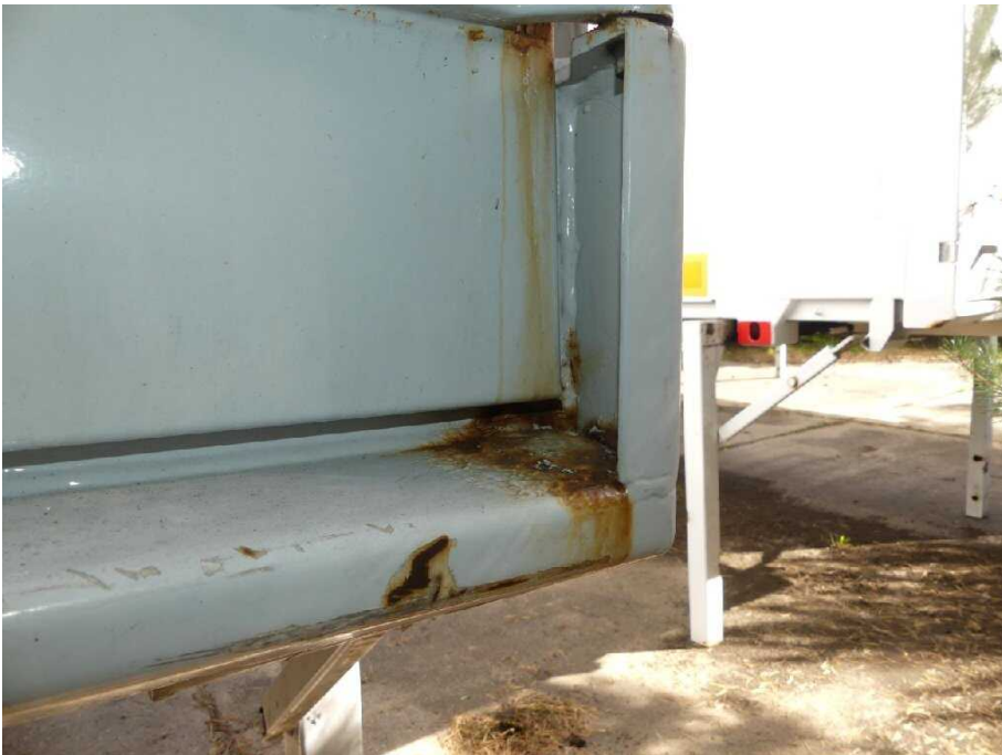
Bild 18 Fahrzeug Rahmen hinten rechts korrodiert
