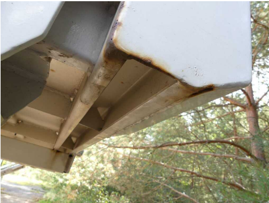
Bild 10 Fahrzeug Rahmen hi.li. korrodiert
