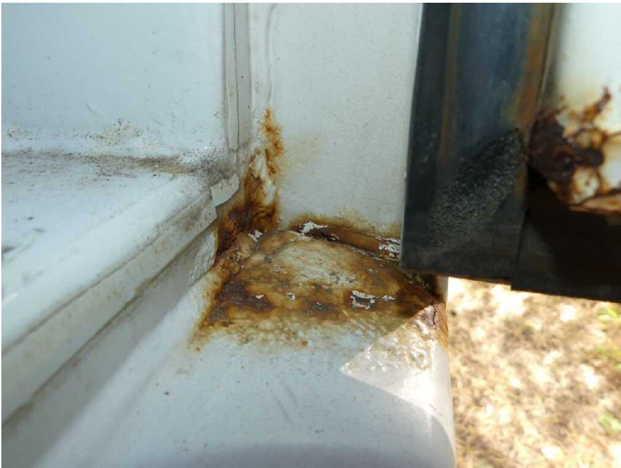
Bild 20 Fahrzeug Rahmen hinten rechts korrodiert
