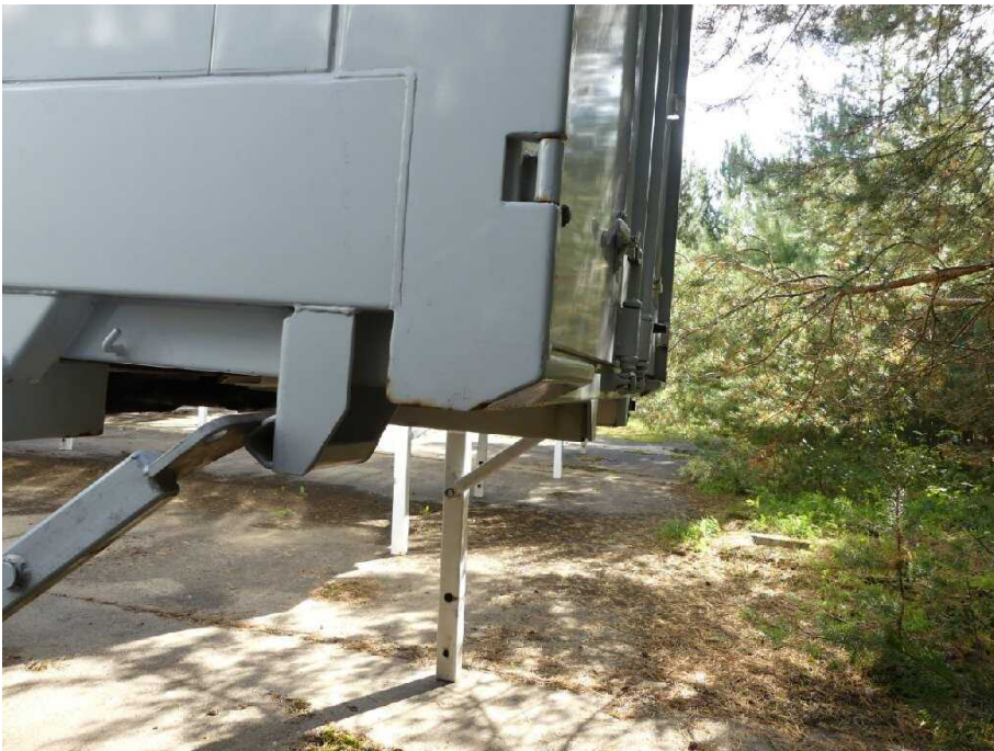
Bild 9 Fahrzeug Rahmen hi.li. korrodiert
