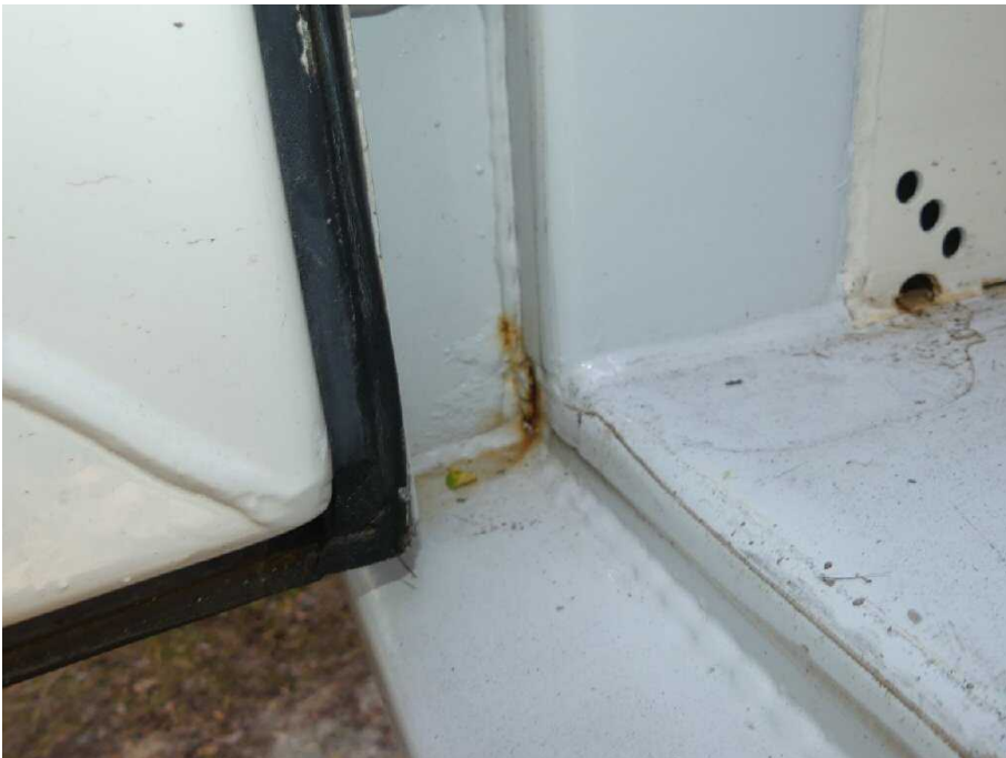
Bild 12 Fahrzeug Rahmen hi.li. korrodiert
