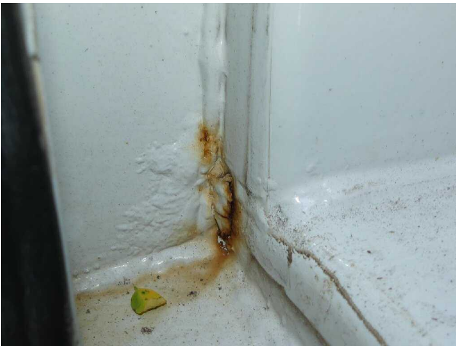
Bild 13 Fahrzeug Rahmen hi.li. korrodiert
