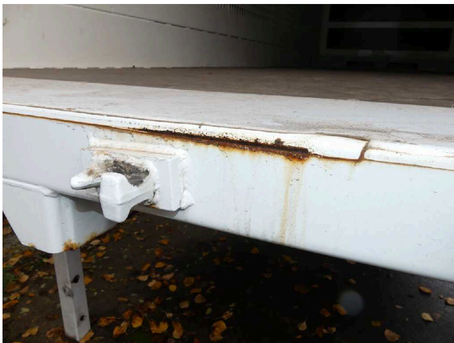
Bild 32 Fahrzeugheck Rahmen hinten Mitte stark korrodiert
