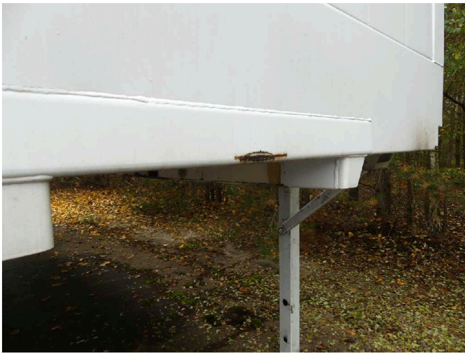
Bild 9 Aufbau Bodenrahmen vorne korrodiert
