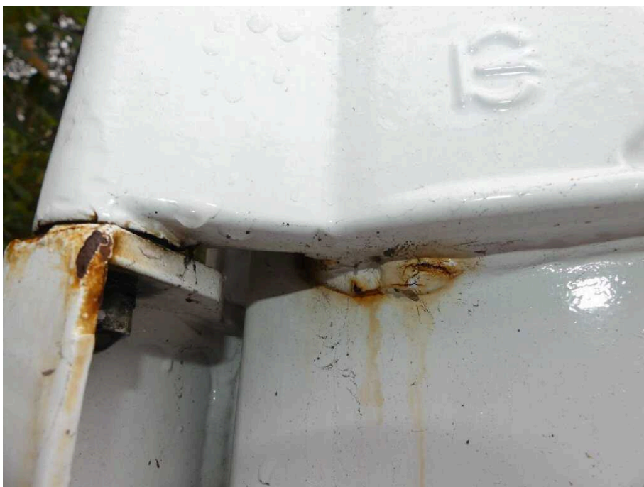
Bild 20 Fahrzeugheck Heckflügeltür links stark korrodiert
