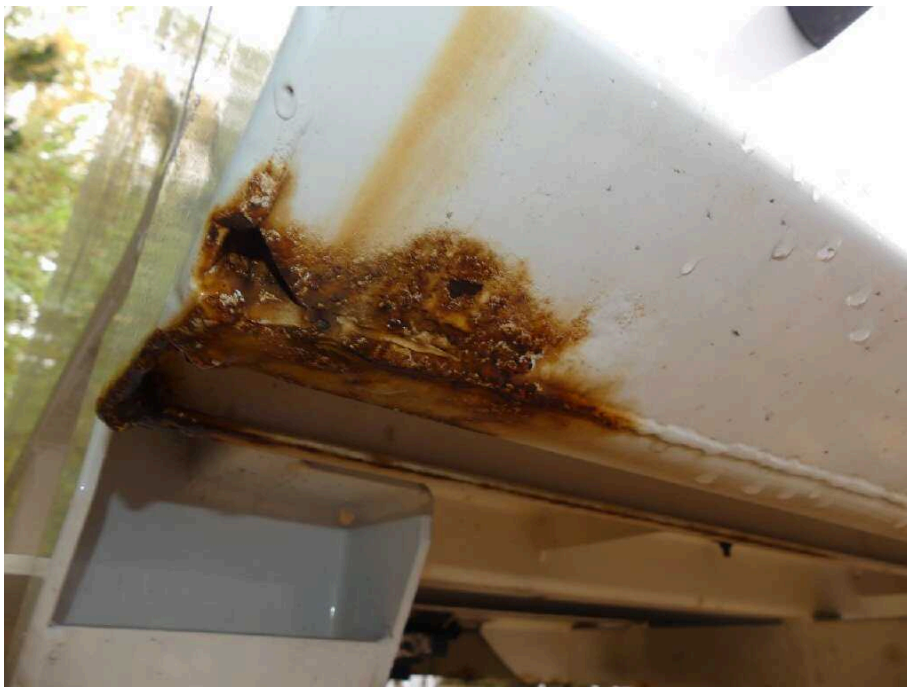
Bild 29 Fahrzeugheck Rahmen hinten links stark korrodiert
