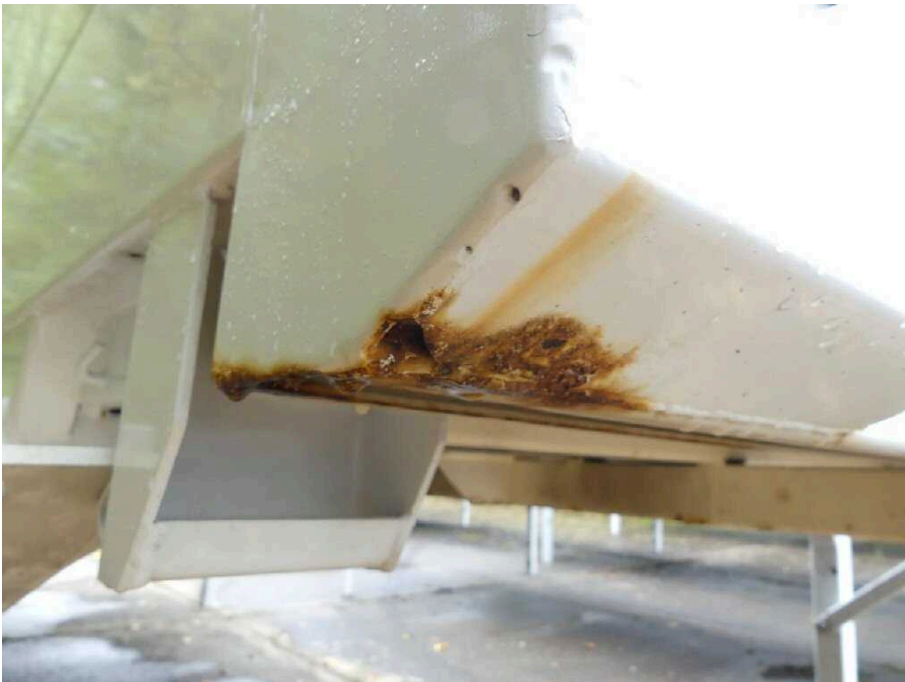
Bild 26 Fahrzeugheck Rahmen hinten links stark korrodiert
