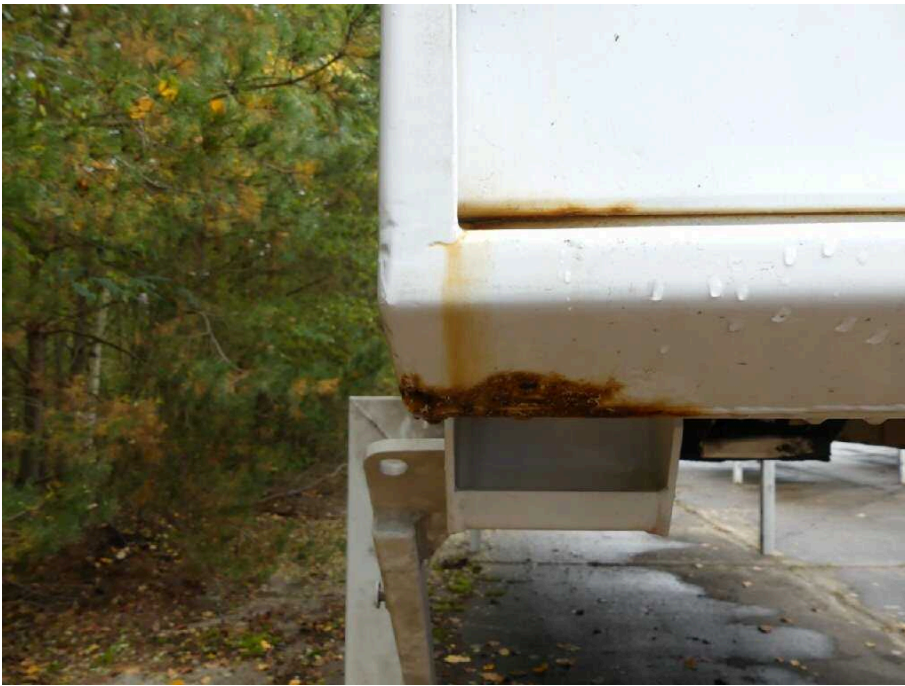
Bild 17 Fahrzeugheck Heckflügeltür links stark korrodiert
