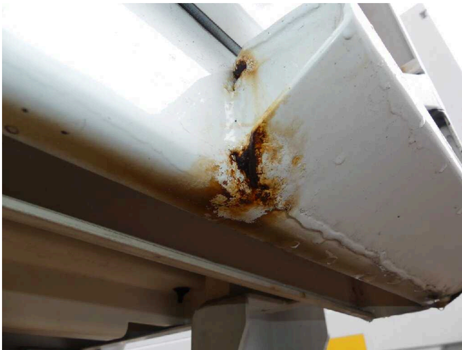
Bild 35 Fahrzeugheck Rahmen hinten rechts stark korrodiert
