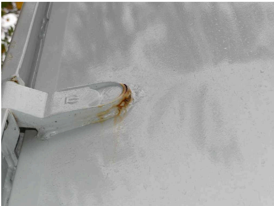
Bild 22 Fahrzeugheck Heckflügeltür links stark korrodiert
