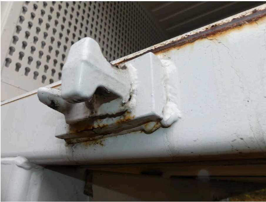
Bild 33 Fahrzeugheck Rahmen hinten Mitte stark korrodiert
