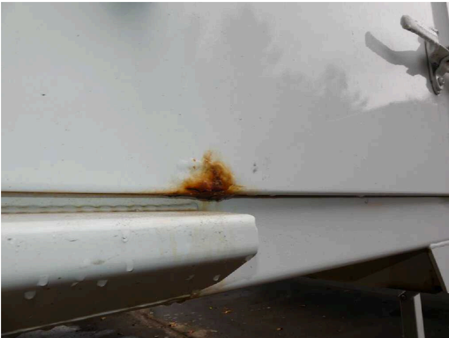
Bild 18 Fahrzeugheck Heckflügeltür links stark korrodiert
