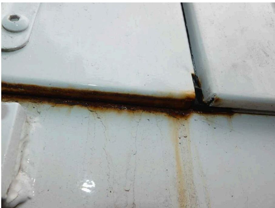
Bild 24 Fahrzeugheck Heckflügeltür links stark korrodiert
