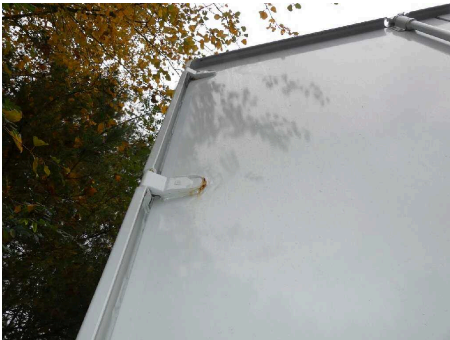
Bild 21 Fahrzeugheck Heckflügeltür links stark korrodiert
