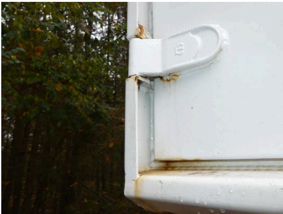
Bild 19 Fahrzeugheck Heckflügeltür links stark korrodiert
