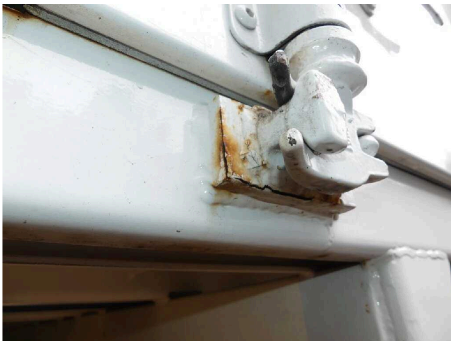
Bild 31 Fahrzeugheck Rahmen hinten Mitte stark korrodiert
