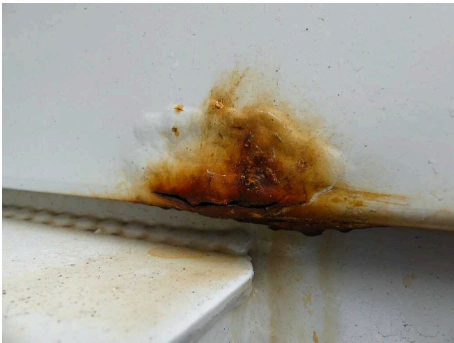
Bild 15 Fahrzeugheck Heckflügeltür links stark korrodiert
