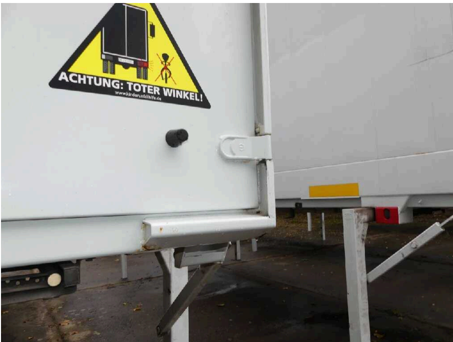
Bild 34 Fahrzeugheck Rahmen hinten rechts stark korrodiert
