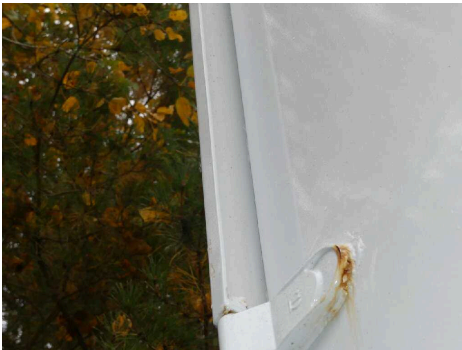
Bild 23 Fahrzeugheck Heckflügeltür links stark korrodiert
