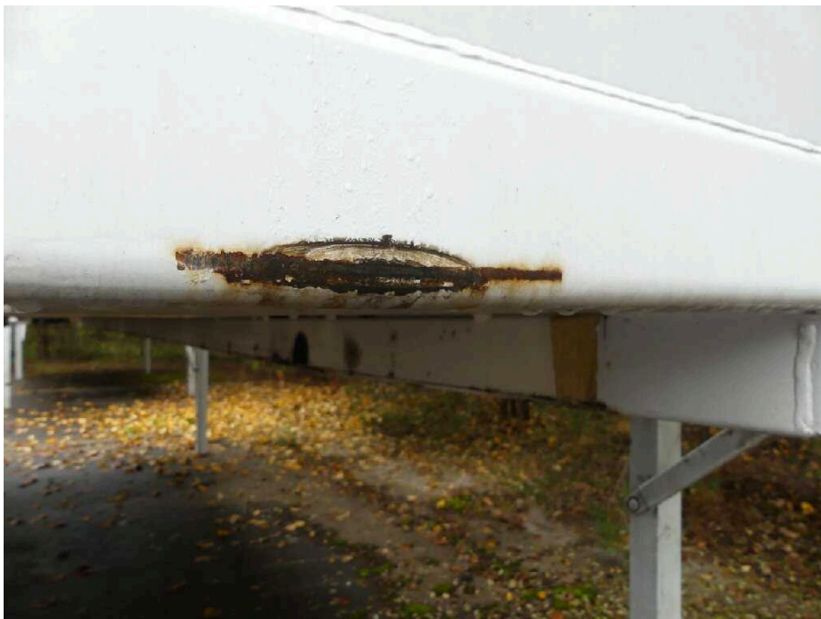
Bild 10 Aufbau Bodenrahmen vorne korrodiert
