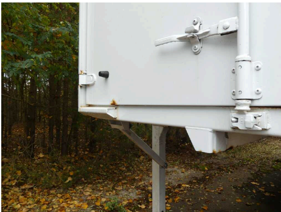
Bild 14 Fahrzeugheck Heckflügeltür links stark korrodiert
