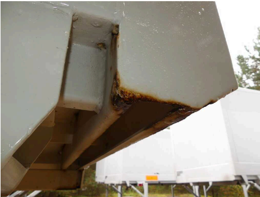
Bild 28 Fahrzeugheck Rahmen hinten links stark korrodiert
