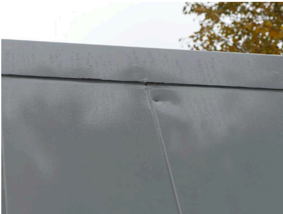
Bild 13 Fahrzeug Rahmen Vorn oben deformiert
