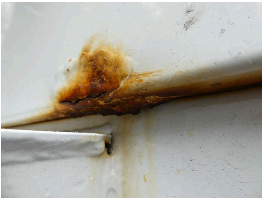
Bild 16 Fahrzeugheck Heckflügeltür links stark korrodiert
