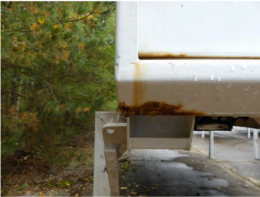
Bild 25 Fahrzeugheck Rahmen hinten links stark korrodiert
