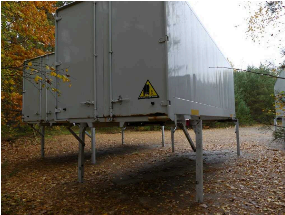
Bild 11 Fahrzeugheck Heckflügeltür rechts stark korrodiert
