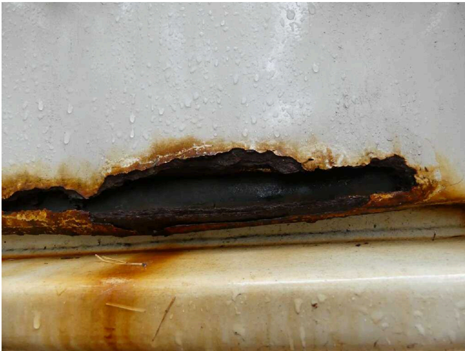
Bild 13 Fahrzeugheck Heckflügeltür rechts stark korrodiert
