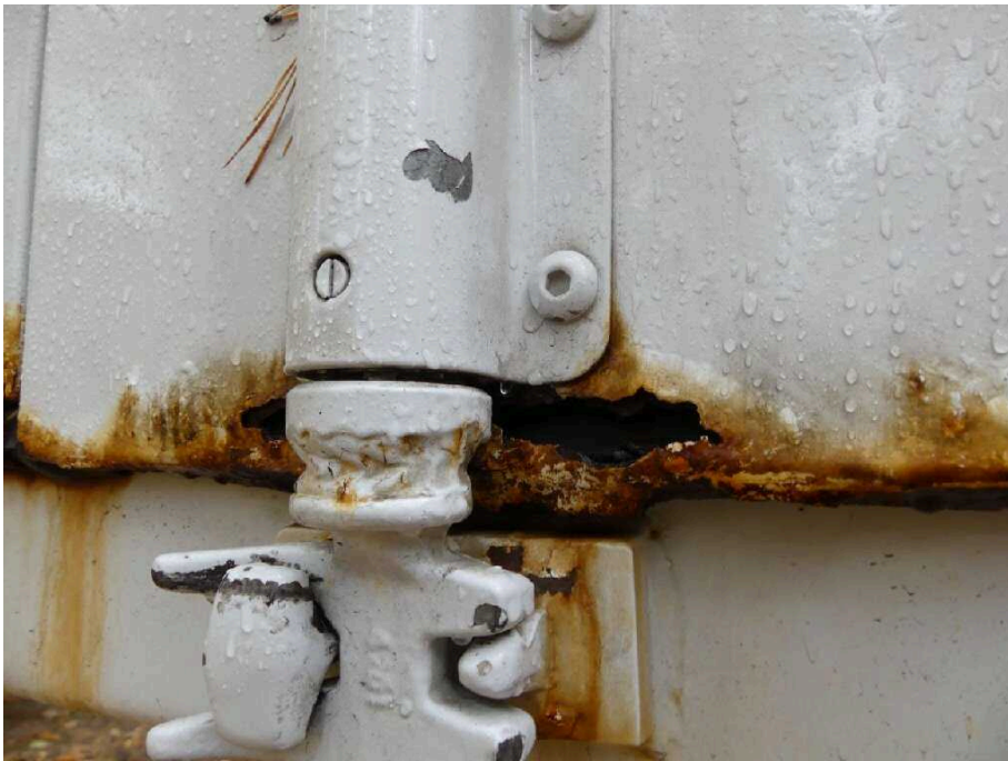
Bild 15 Fahrzeugheck Heckflügeltür rechts stark korrodiert
