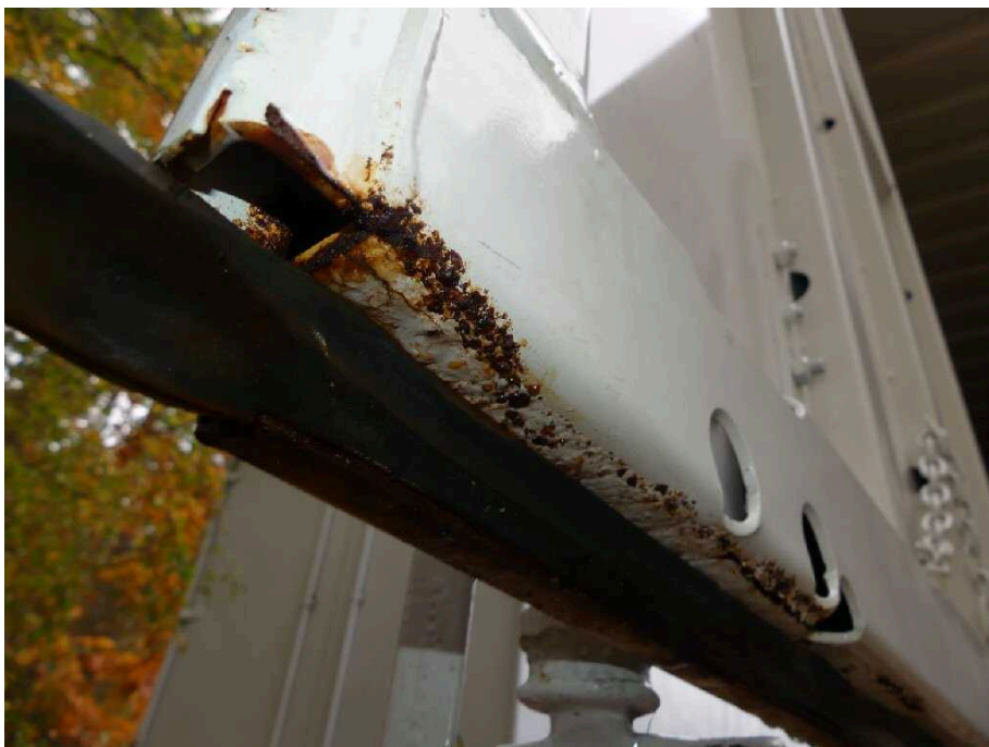
Bild 34 Fahrzeugheck Heckflügeltür links korrodiert
