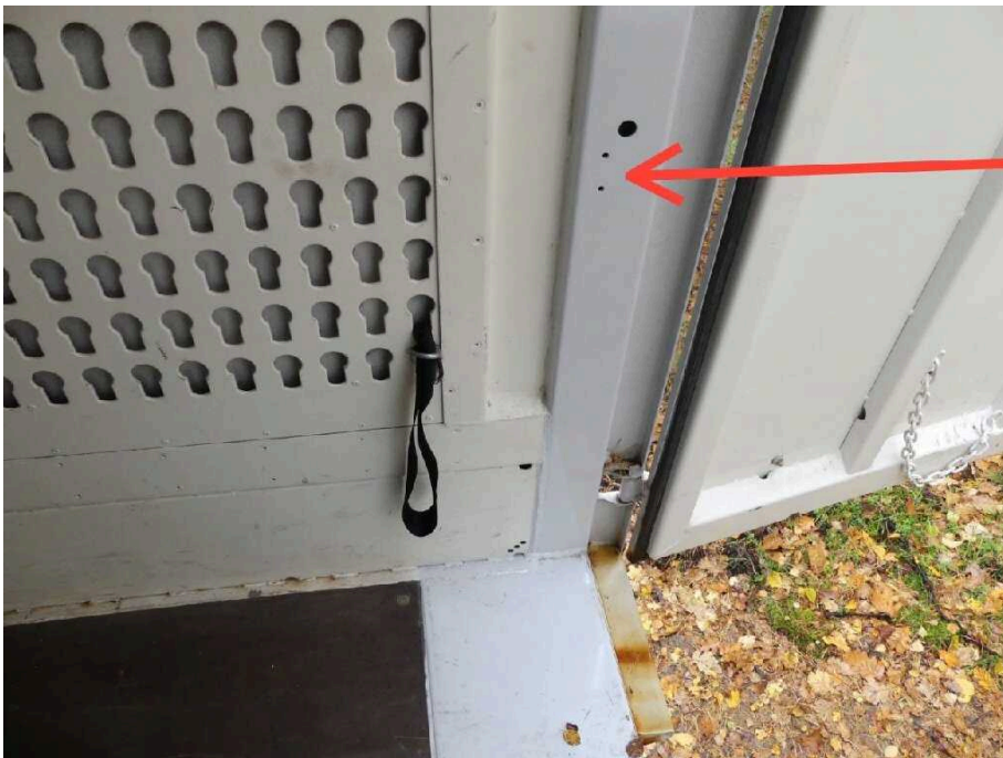
Bild 44 Fahrzeugheck Laderaum Halteband, falsch Montiert lose
