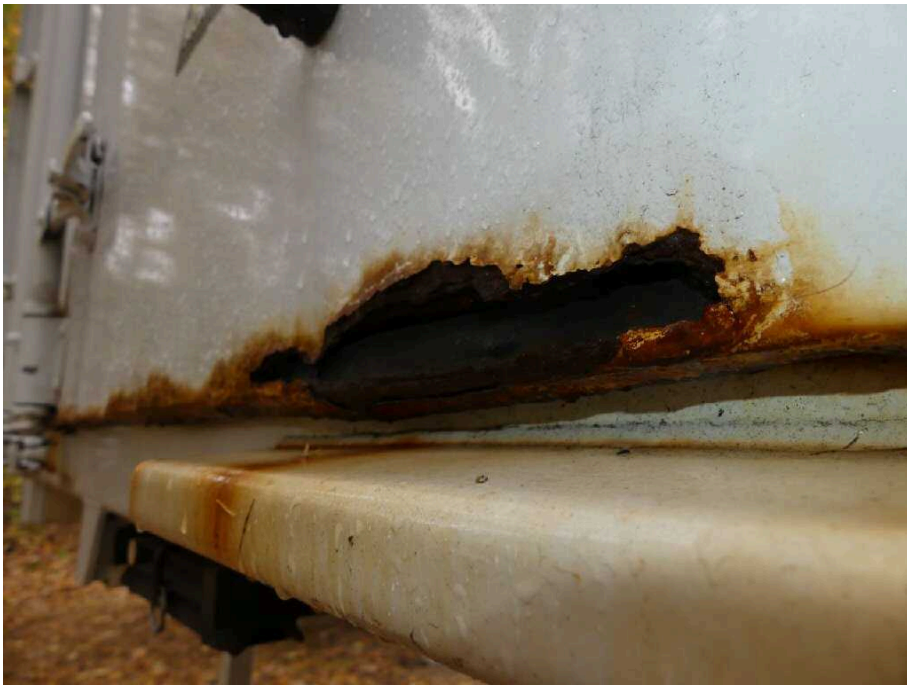
Bild 21 Fahrzeugheck Heckflügeltür rechts stark korrodiert
