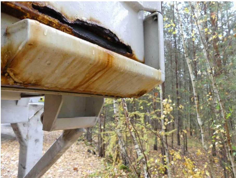
Bild 24 Fahrzeugheck Rahmen hinten rechts korrodiert
