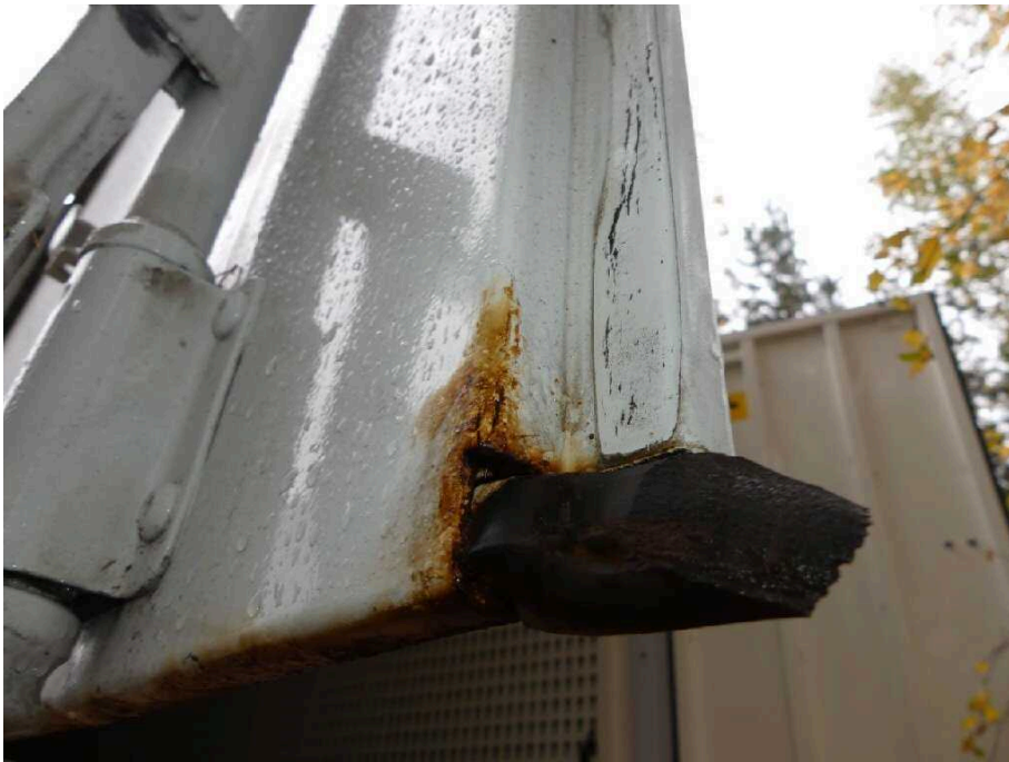
Bild 37 Fahrzeugheck Heckflügeltür links korrodiert
