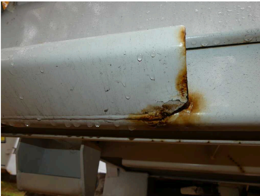
Bild 40 Fahrzeugheck Rahmen hinten links korrodiert
