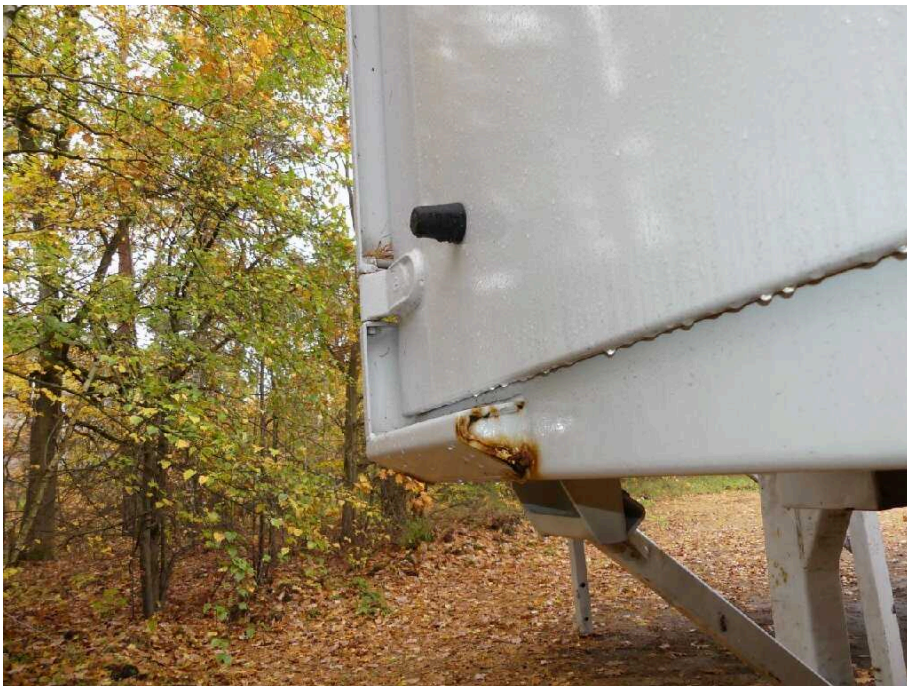
Bild 38 Fahrzeugheck Rahmen hinten links korrodiert
