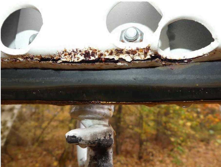
Bild 35 Fahrzeugheck Heckflügeltür links korrodiert
