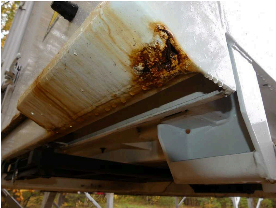
Bild 27 Fahrzeugheck Rahmen hinten rechts korrodiert
