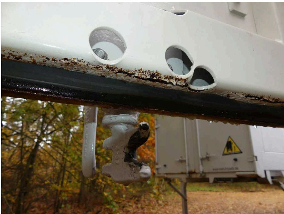
Bild 33 Fahrzeugheck Heckflügeltür links korrodiert
