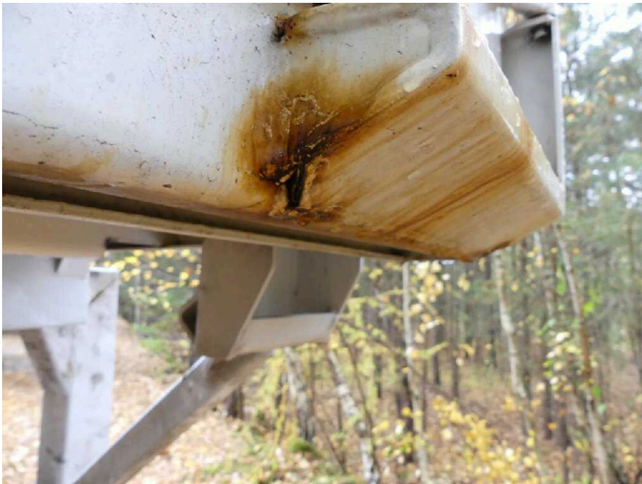
Bild 25 Fahrzeugheck Rahmen hinten rechts korrodiert
