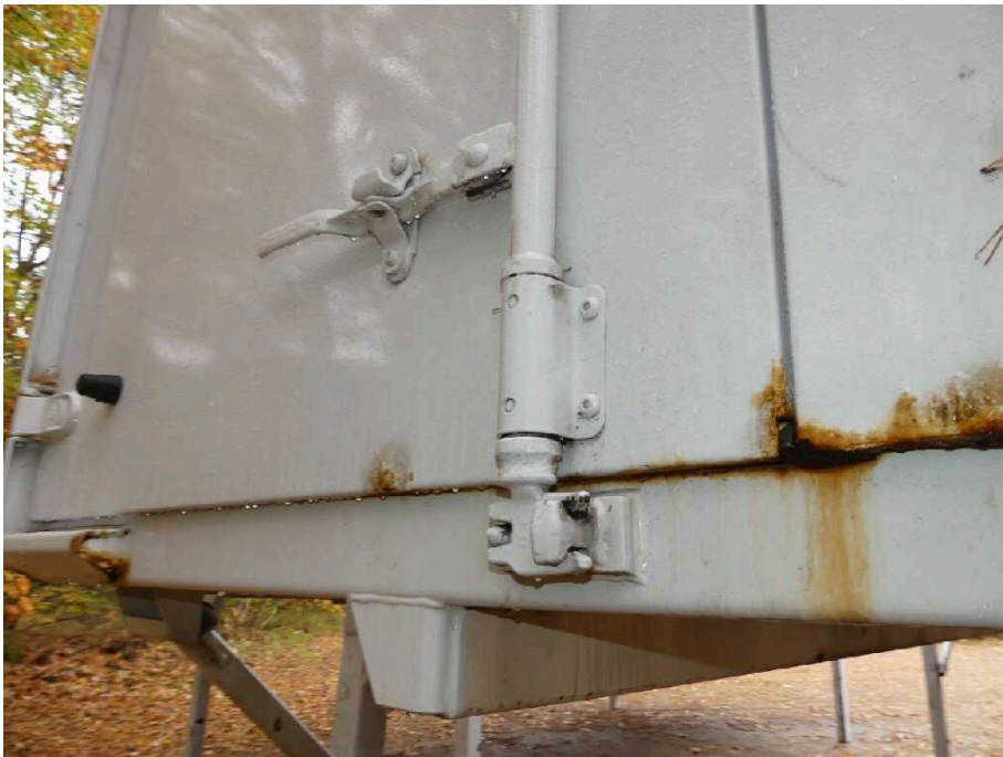
Bild 29 Fahrzeugheck Heckflügeltür links korrodiert
