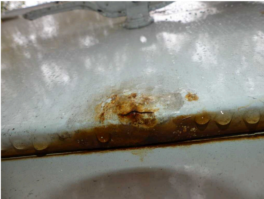
Bild 31 Fahrzeugheck Heckflügeltür links korrodiert
