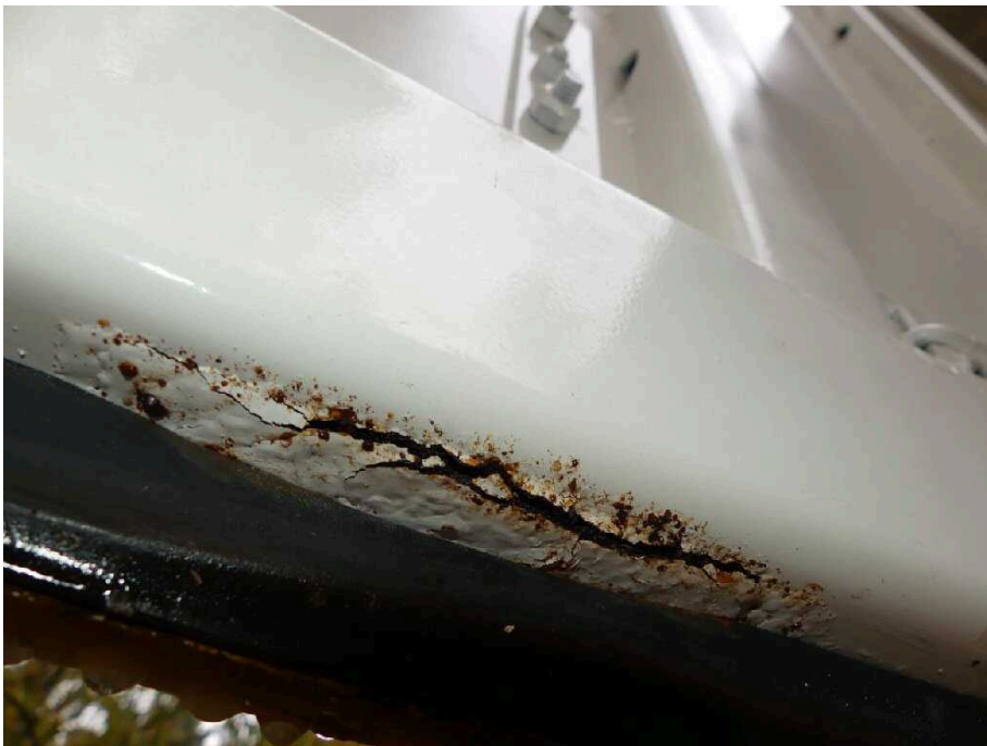
Bild 36 Fahrzeugheck Heckflügeltür links korrodiert
