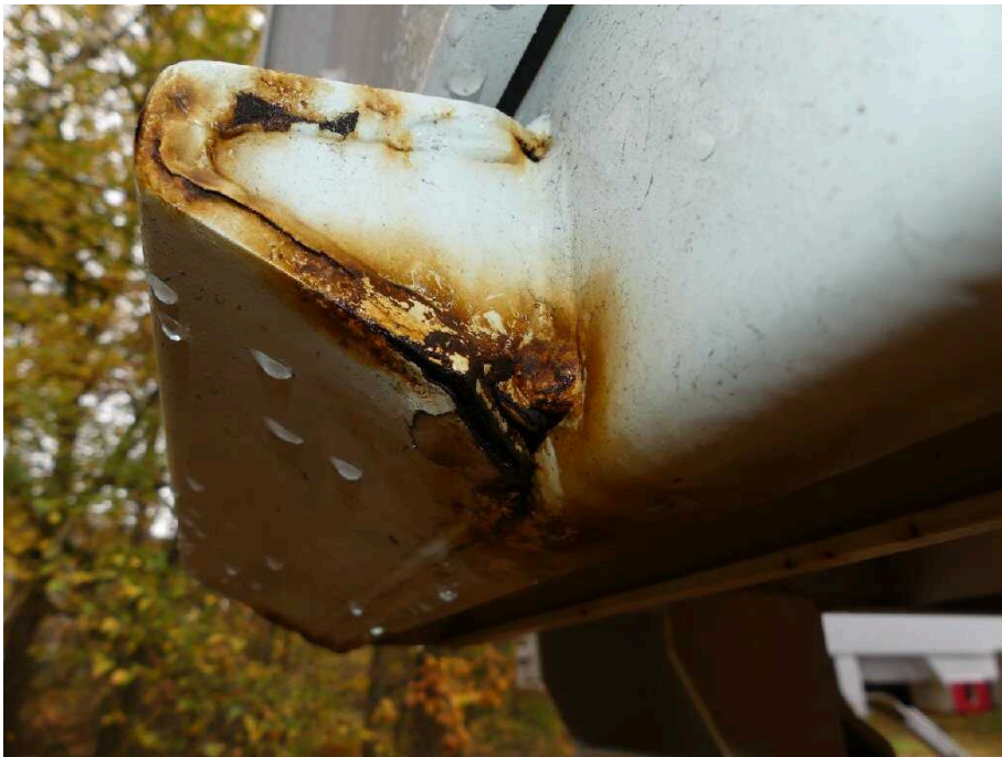
Bild 39 Fahrzeugheck Rahmen hinten links korrodiert
