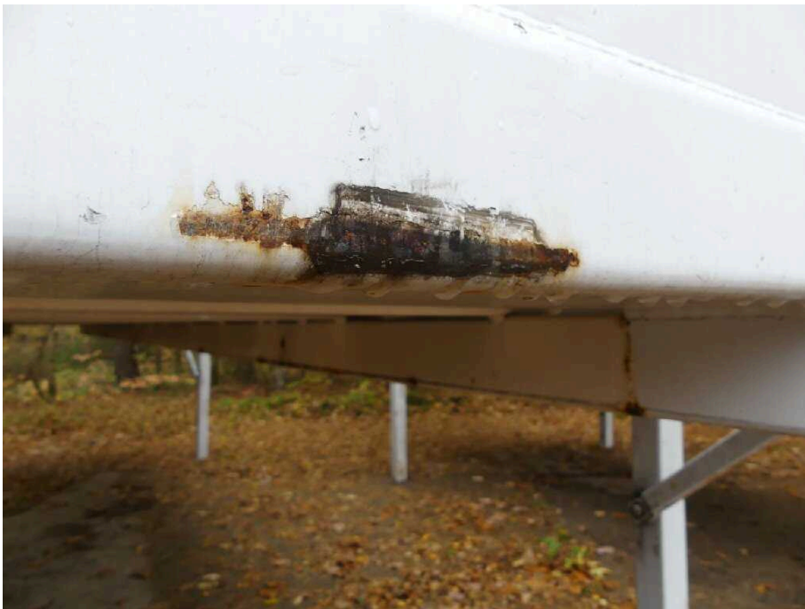
Bild 10 Aufbau Bodenrahmen vorne korrodiert
