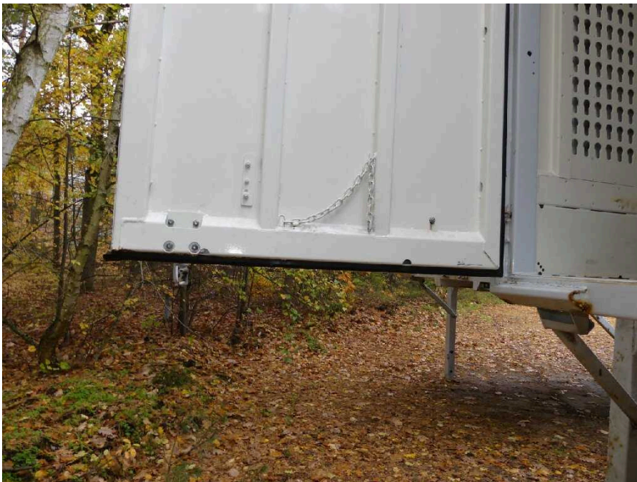
Bild 32 Fahrzeugheck Heckflügeltür links korrodiert
