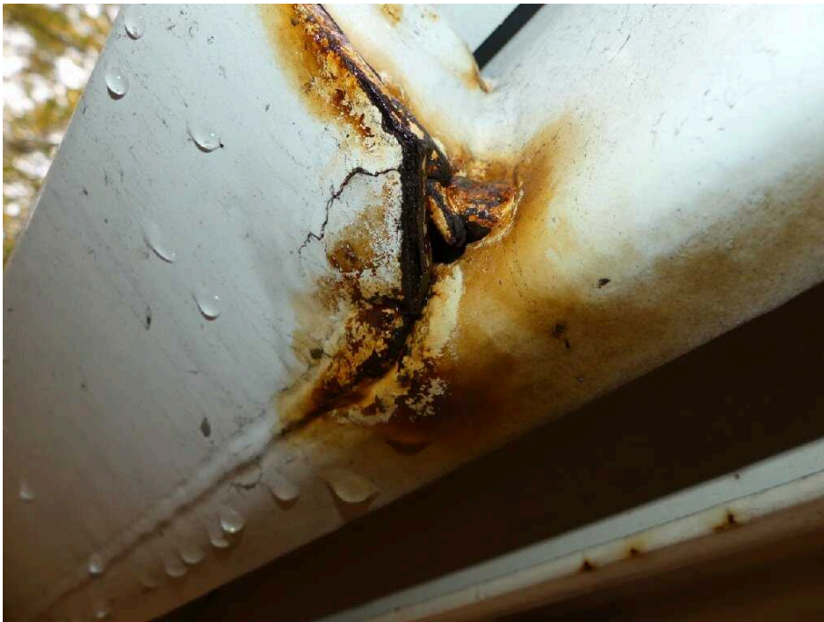
Bild 41 Fahrzeugheck Rahmen hinten links korrodiert
