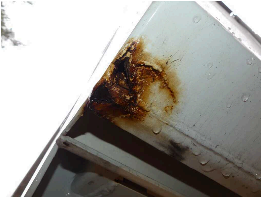
Bild 43 Fahrzeugheck Rahmen hinten links korrodiert
