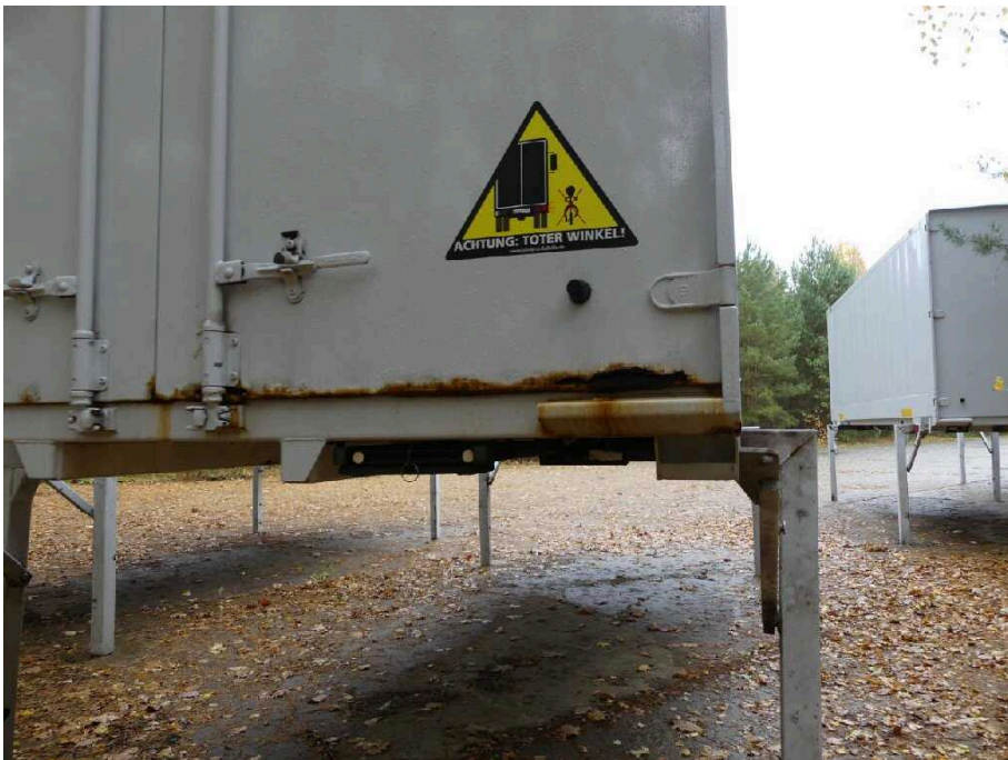
Bild 12 Fahrzeugheck Heckflügeltür rechts stark korrodiert
