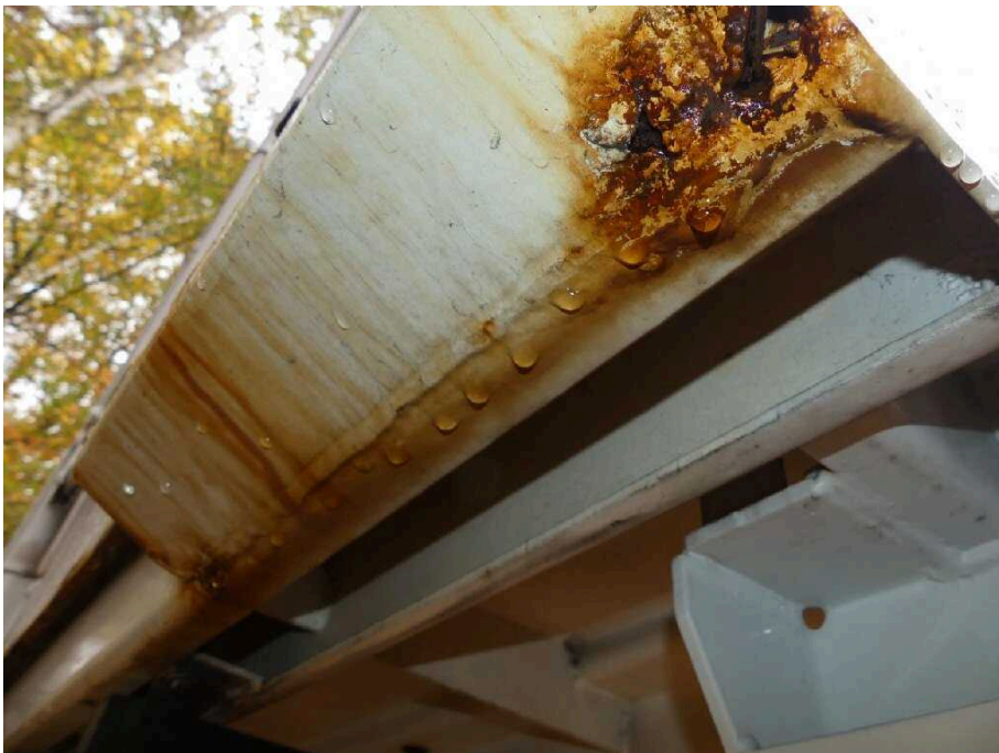
Bild 28 Fahrzeugheck Rahmen hinten rechts korrodiert
