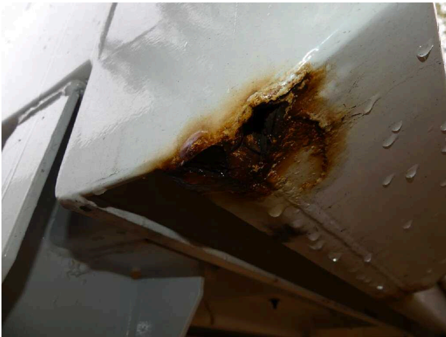
Bild 42 Fahrzeugheck Rahmen hinten links korrodiert
