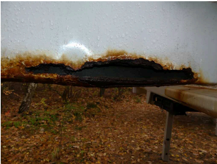
Bild 20 Fahrzeugheck Heckflügeltür rechts stark korrodiert
