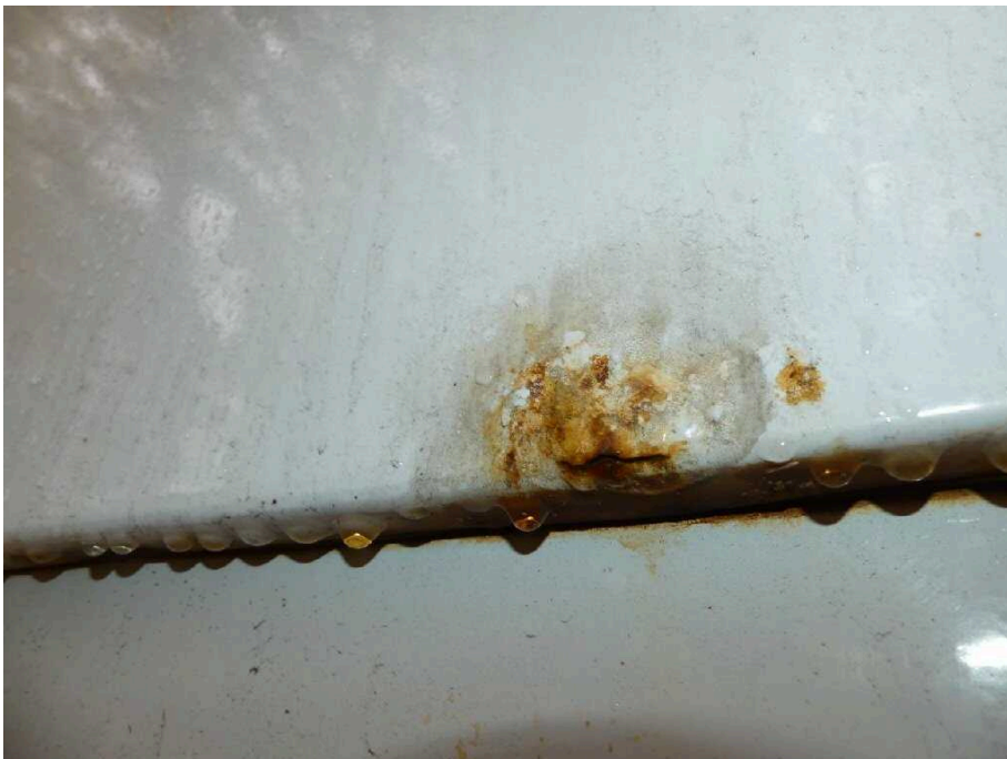
Bild 30 Fahrzeugheck Heckflügeltür links korrodiert
