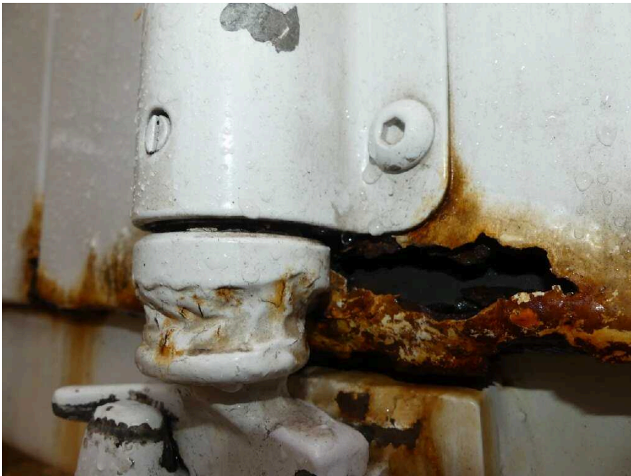
Bild 17 Fahrzeugheck Heckflügeltür rechts stark korrodiert
