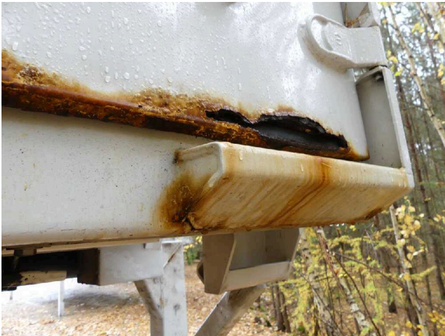
Bild 23 Fahrzeugheck Rahmen hinten rechts korrodiert
