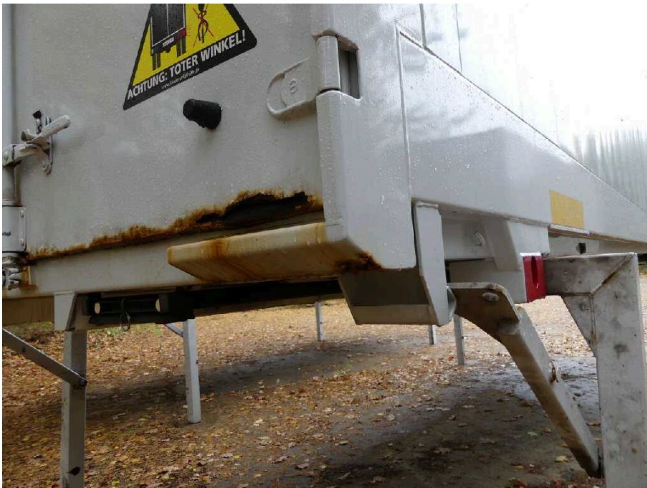
Bild 26 Fahrzeugheck Rahmen hinten rechts korrodiert
