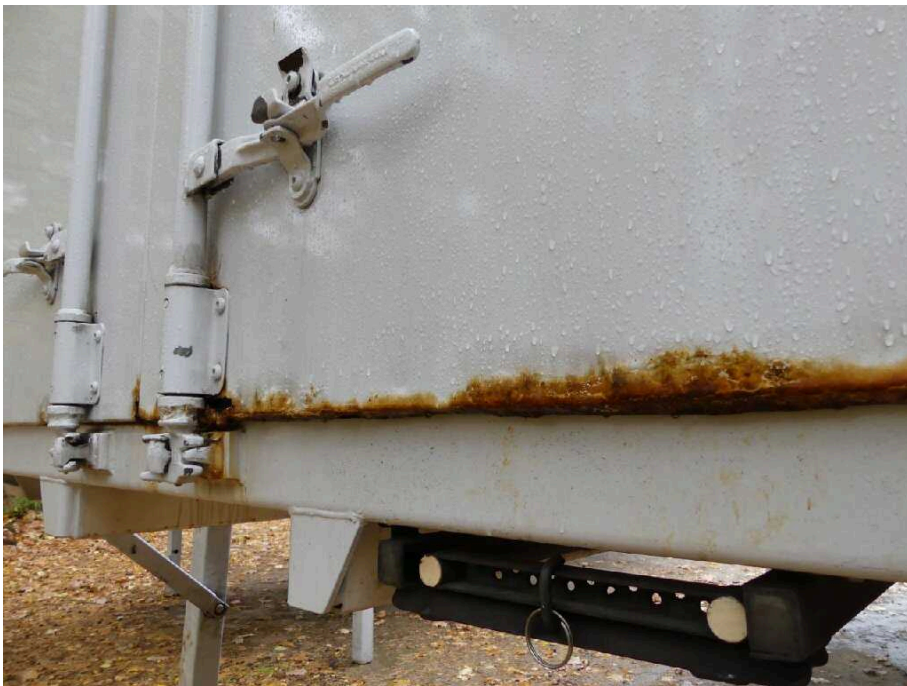
Bild 14 Fahrzeugheck Heckflügeltür rechts stark korrodiert
