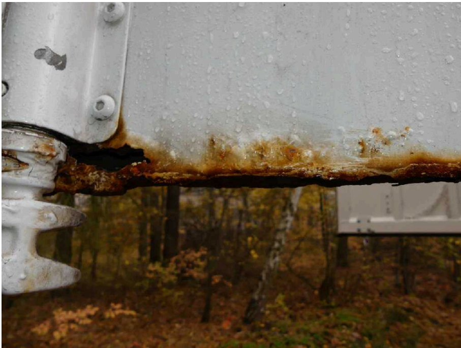
Bild 19 Fahrzeugheck Heckflügeltür rechts stark korrodiert
