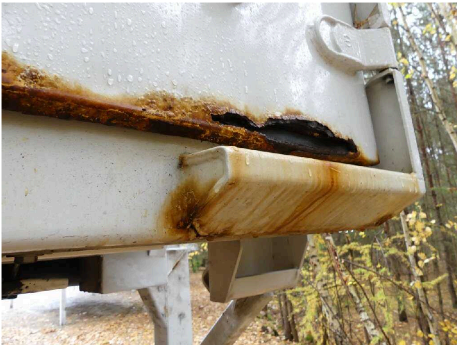
Bild 16 Fahrzeugheck Heckflügeltür rechts stark korrodiert
