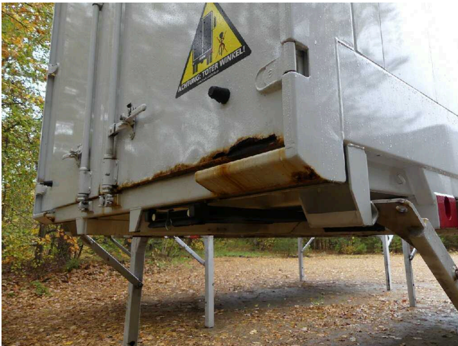
Bild 22 Fahrzeugheck Rahmen hinten rechts korrodiert
