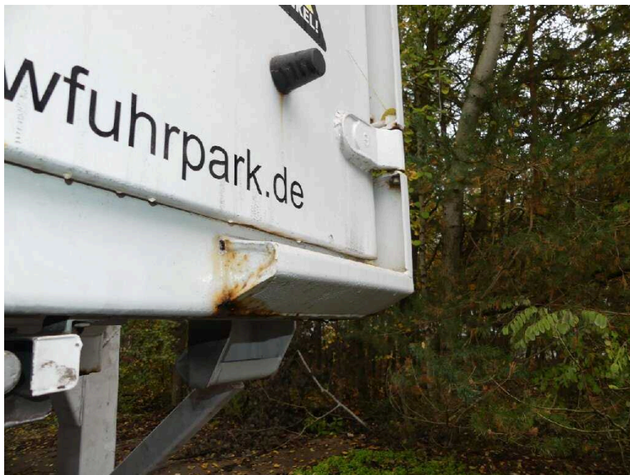
Bild 31 Fahrzeugheck Fahrzeug hinten Rahmen hinten rechts beschädigt
