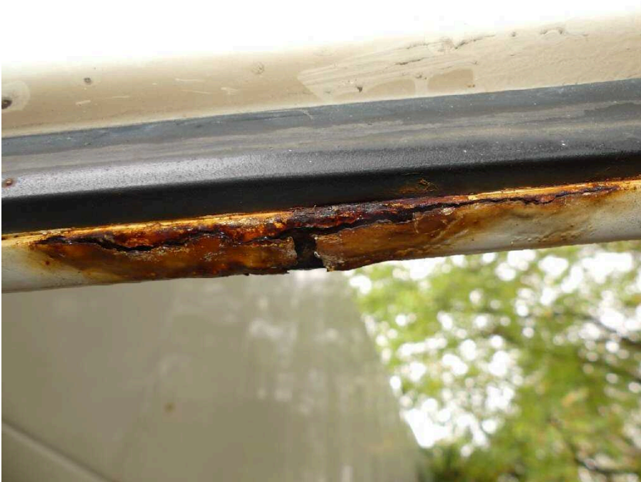
Bild 39 Fahrzeugheck Heckflügeltür links stark korrodiert
