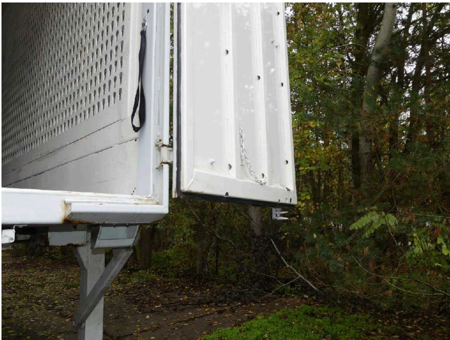
Bild 28 Fahrzeugheck Heckflügeltür rechts stark korrodiert
