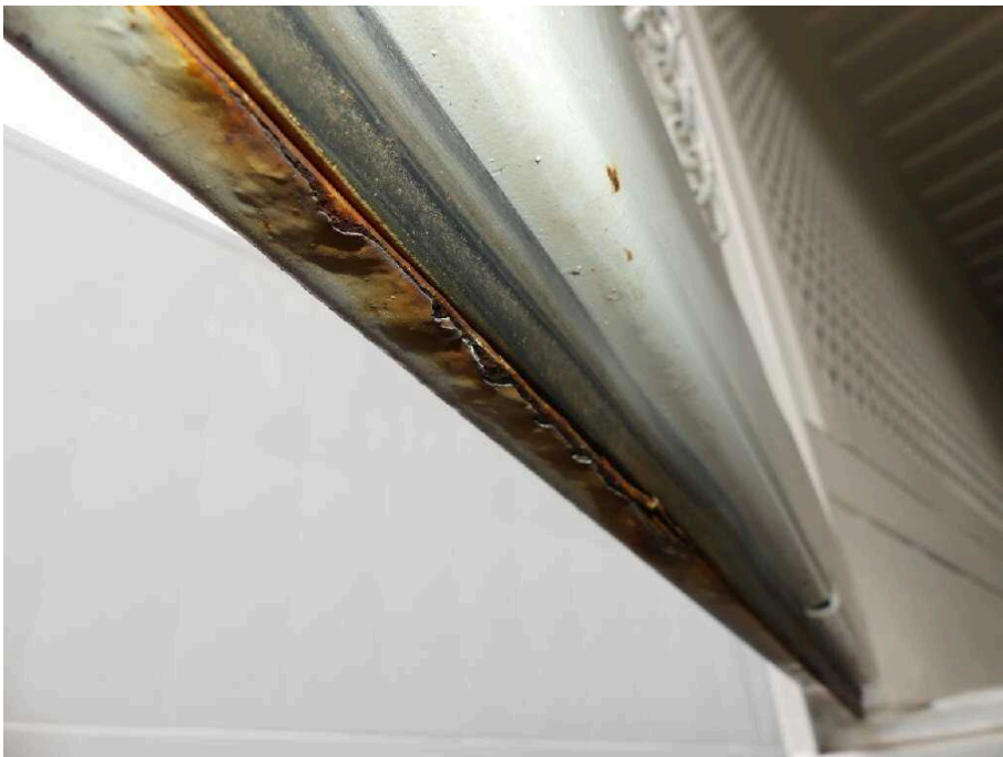
Bild 36 Fahrzeugheck Heckflügeltür links stark korrodiert
