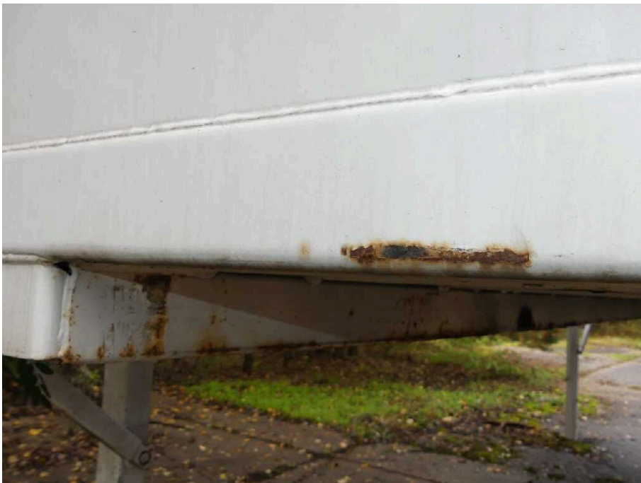
Bild 10 Aufbau Bodenrahmen vorne korrodiert
