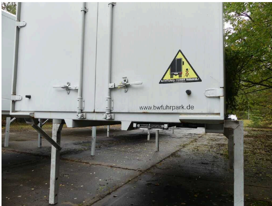
Bild 25 Fahrzeugheck Heckflügeltür rechts stark korrodiert
