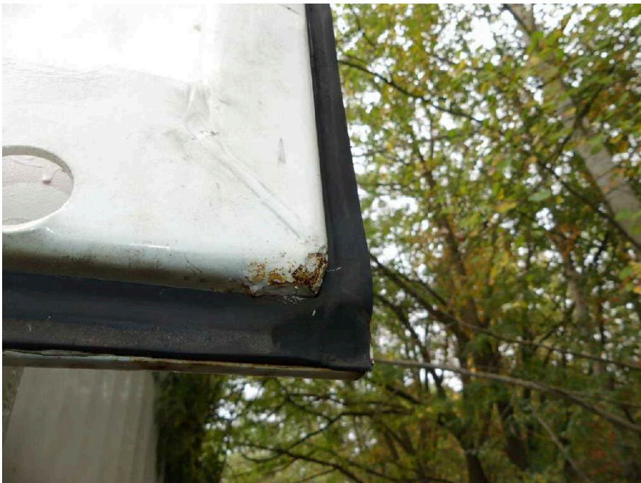
Bild 30 Fahrzeugheck Heckflügeltür rechts stark korrodiert
