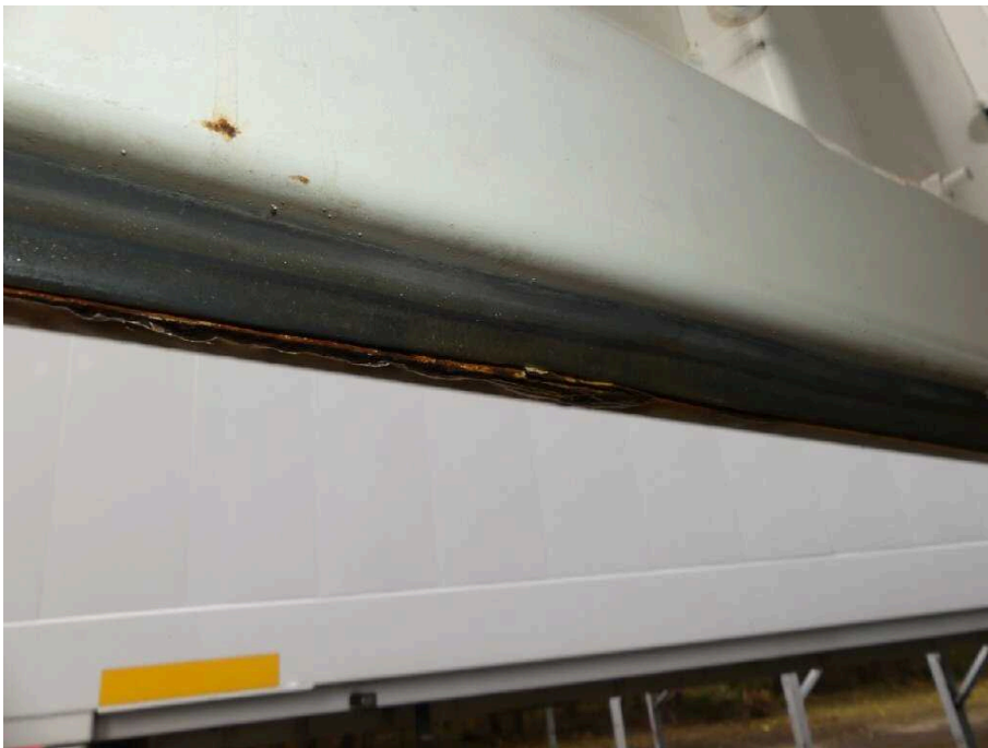
Bild 35 Fahrzeugheck Heckflügeltür links stark korrodiert
