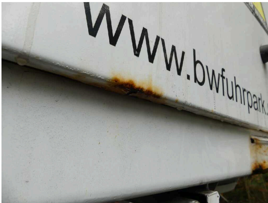
Bild 26 Fahrzeugheck Heckflügeltür rechts stark korrodiert
