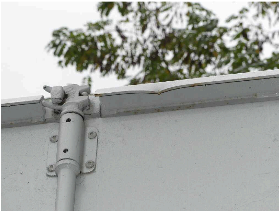
Bild 51 Dach Dach hinten rechts eingedrückt
