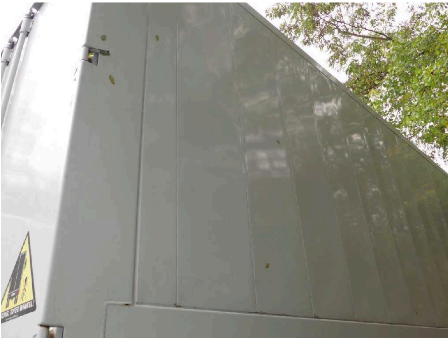
Bild 40 Fahrzeug aussen rechts, Lackablösung und korrodiert
