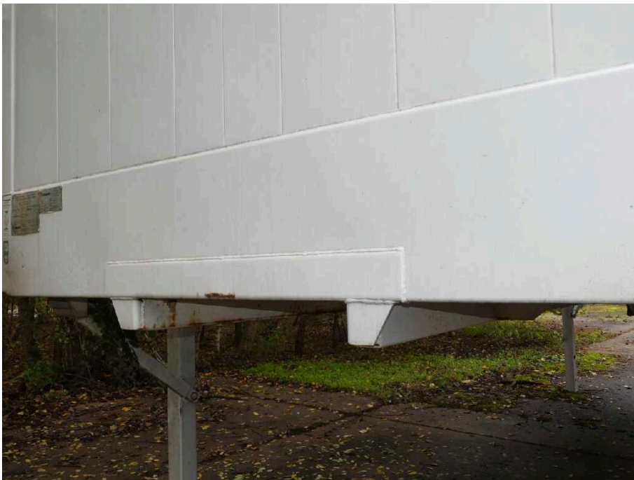
Bild 9 Aufbau Bodenrahmen vorne korrodiert
