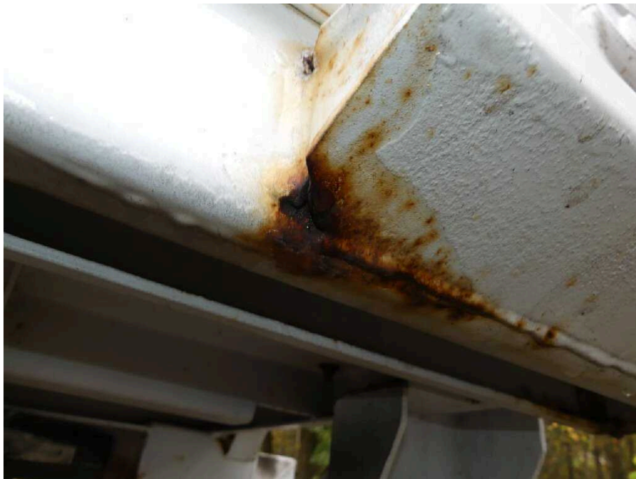
Bild 32 Fahrzeugheck Fahrzeug hinten Rahmen hinten rechts beschädigt
