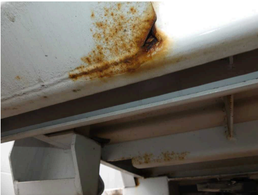
Bild 49 Fahrzeugheck Fahrzeug hinten Rahmen links korrodiert
