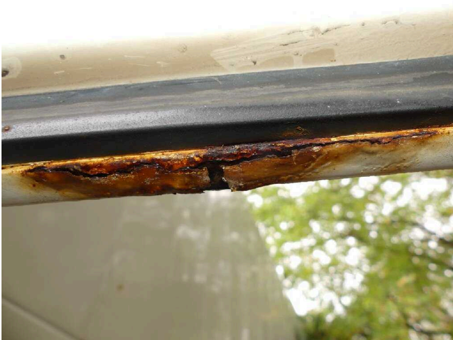
Bild 29 Fahrzeugheck Heckflügeltür rechts stark korrodiert
