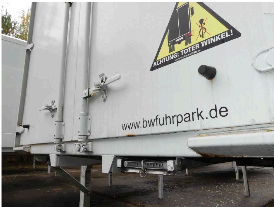
Bild 27 Fahrzeugheck Heckflügeltür rechts stark korrodiert
