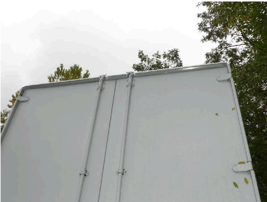
Bild 50 Dach Dach hinten rechts eingedrückt
