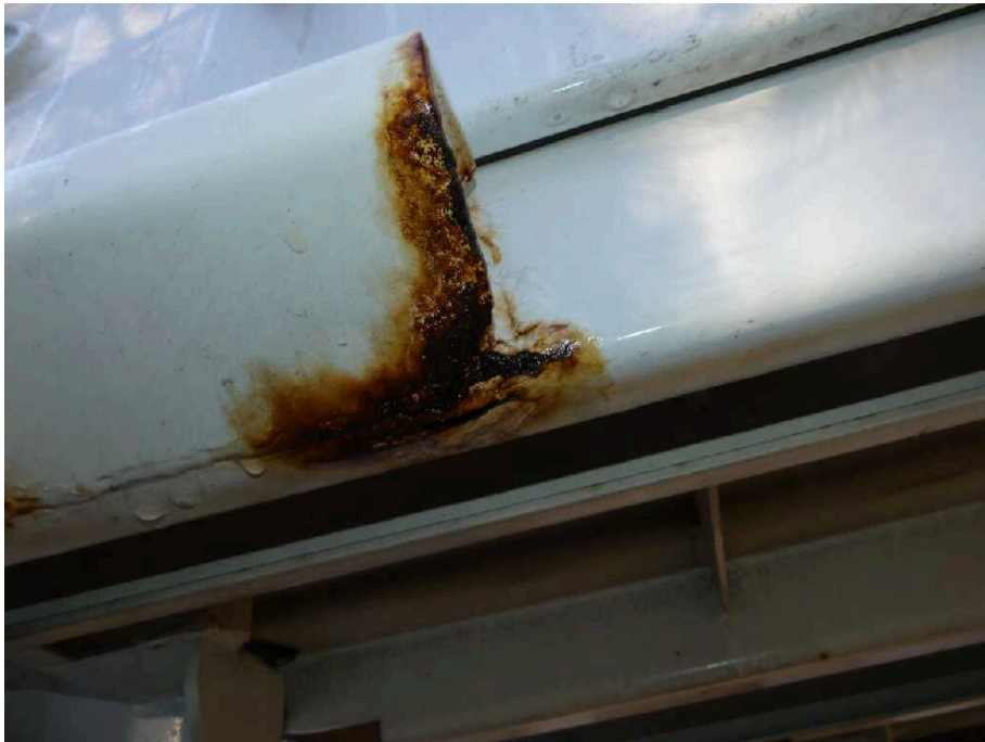
Bild 39 Fahrzeugheck Rahmen hinten links korrodiert
