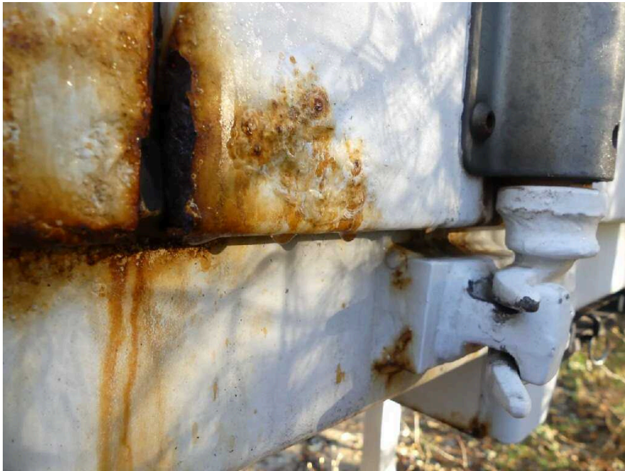
Bild 43 Fahrzeugheck Heckflügeltür rechts korrodiert
