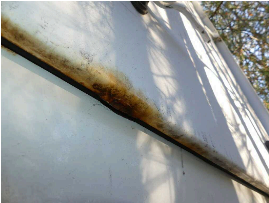
Bild 44 Fahrzeugheck Heckflügeltür rechts korrodiert
