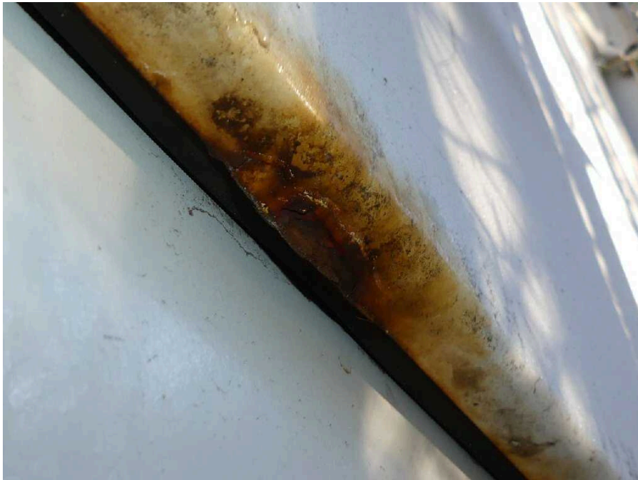
Bild 45 Fahrzeugheck Heckflügeltür rechts korrodiert
