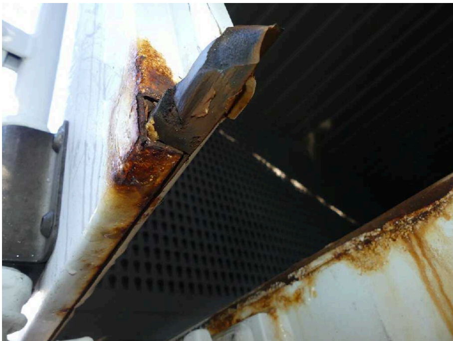
Bild 58 Fahrzeugheck Heckflügeltür links korrodiert
