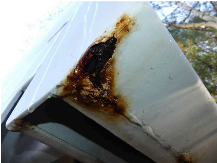
Bild 38 Fahrzeugheck Rahmen hinten links korrodiert
