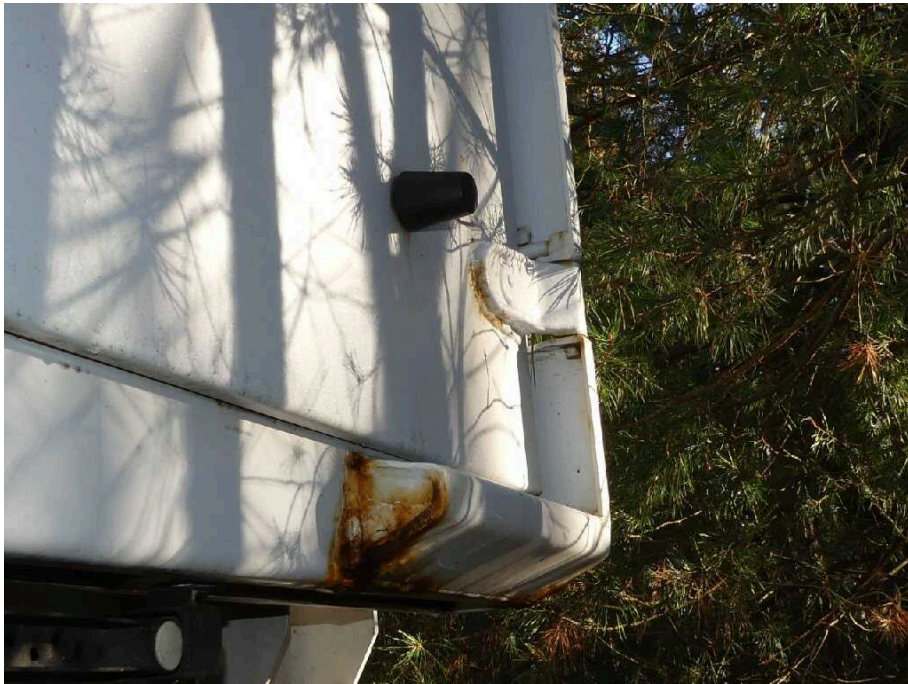
Bild 51 Fahrzeugheck Rahmen hinten rechts korrodiert
