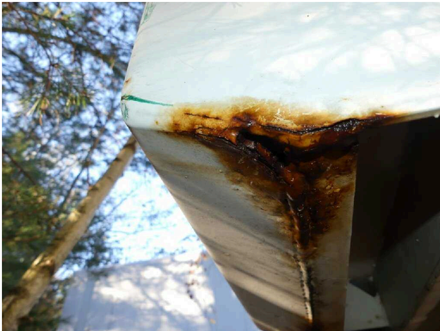
Bild 54 Fahrzeugheck Rahmen hinten rechts korrodiert
