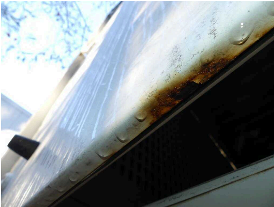
Bild 59 Fahrzeugheck Heckflügeltür links korrodiert
