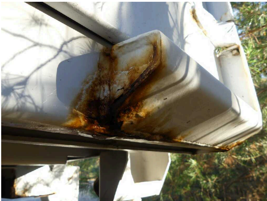
Bild 50 Fahrzeugheck Rahmen hinten rechts korrodiert
