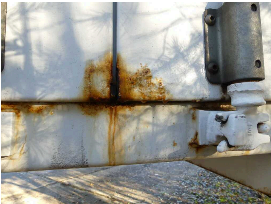
Bild 42 Fahrzeugheck Heckflügeltür rechts korrodiert
