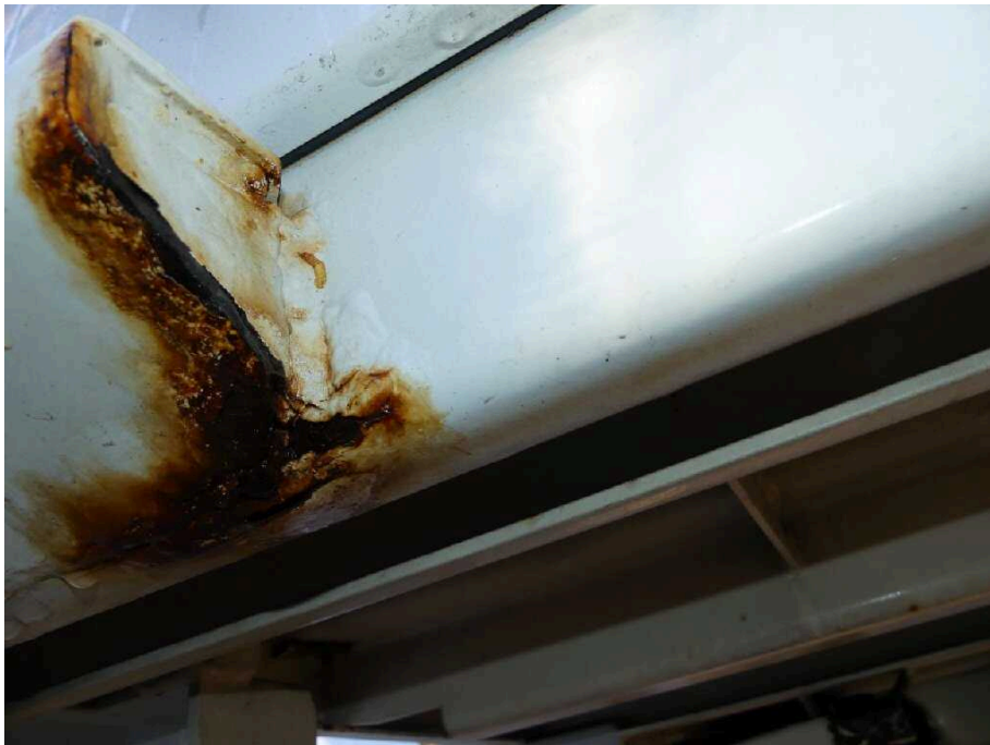
Bild 40 Fahrzeugheck Rahmen hinten links korrodiert
