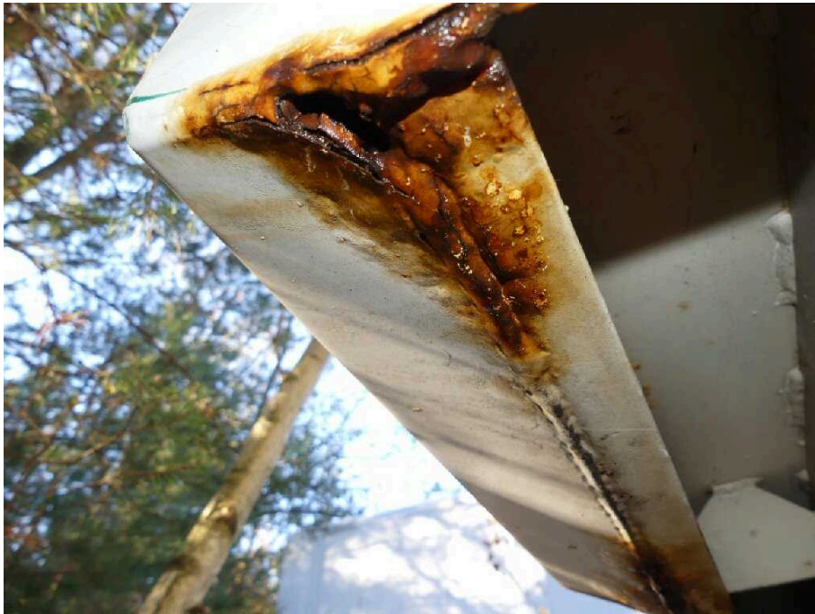
Bild 55 Fahrzeugheck Rahmen hinten rechts korrodiert
