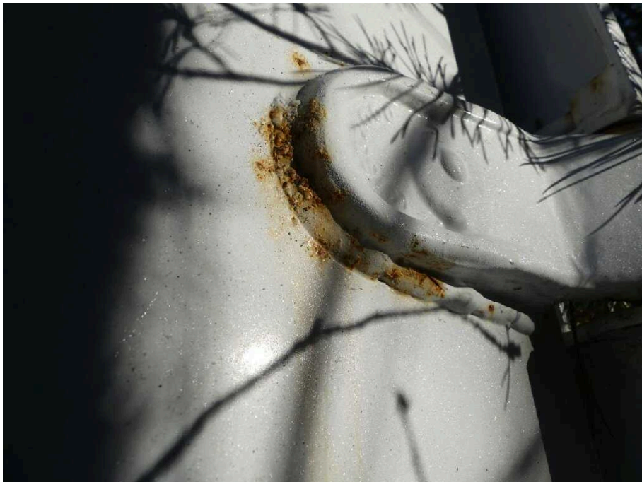
Bild 48 Fahrzeugheck Heckflügeltür rechts korrodiert
