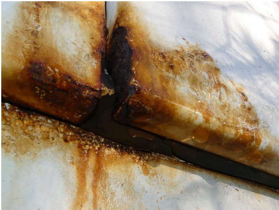
Bild 46 Fahrzeugheck Heckflügeltür rechts korrodiert
