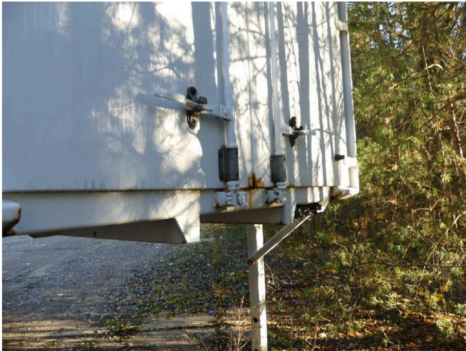
Bild 41 Fahrzeugheck Heckflügeltür rechts korrodiert
