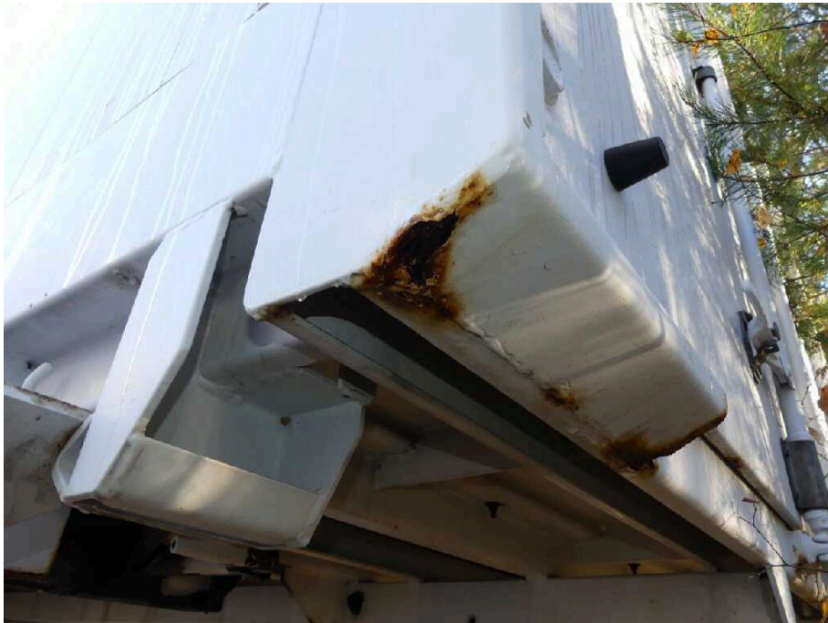
Bild 37 Fahrzeugheck Rahmen hinten links korrodiert
