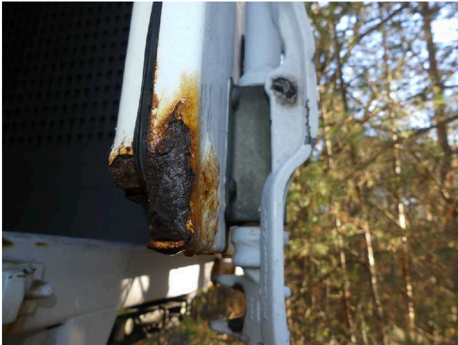
Bild 47 Fahrzeugheck Heckflügeltür rechts korrodiert
