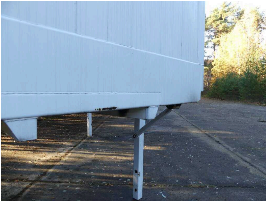
Bild 9 Aufbau Bodenrahmen vorne korrodiert
