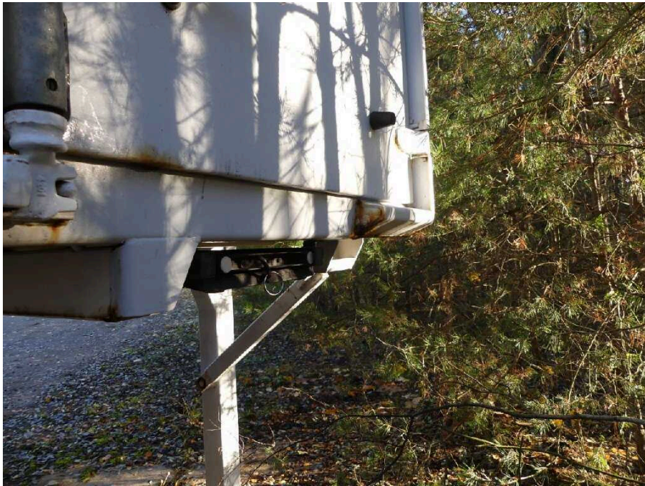
Bild 49 Fahrzeugheck Rahmen hinten rechts korrodiert
