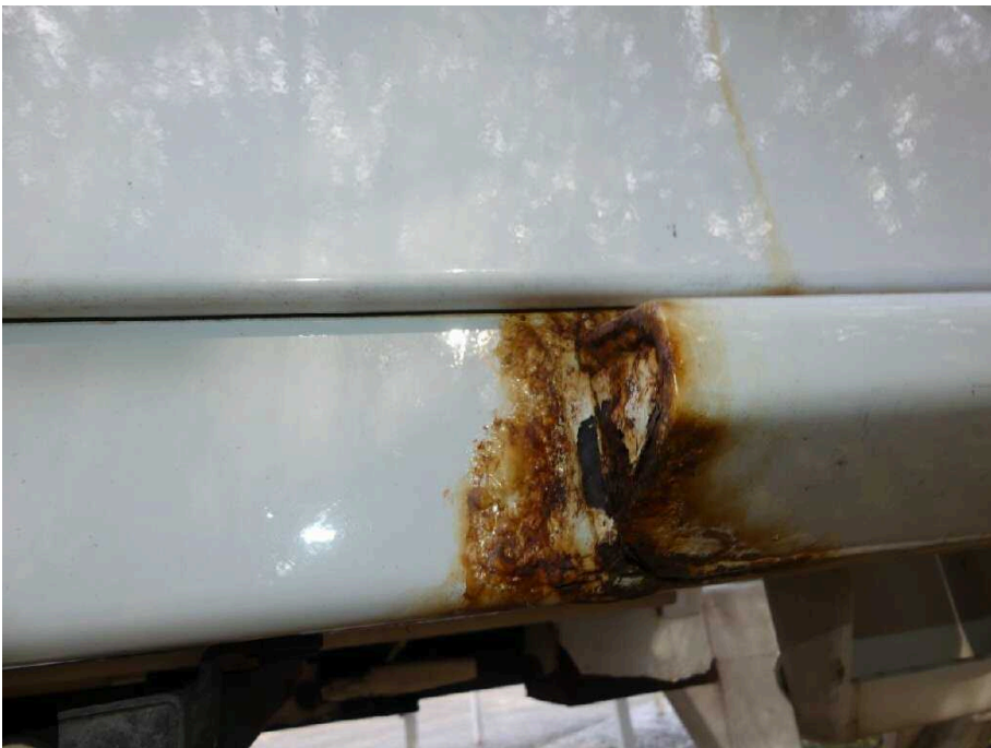
Bild 16 Fahrzeugheck Rahmen hinten hinten rechts korrodiert
