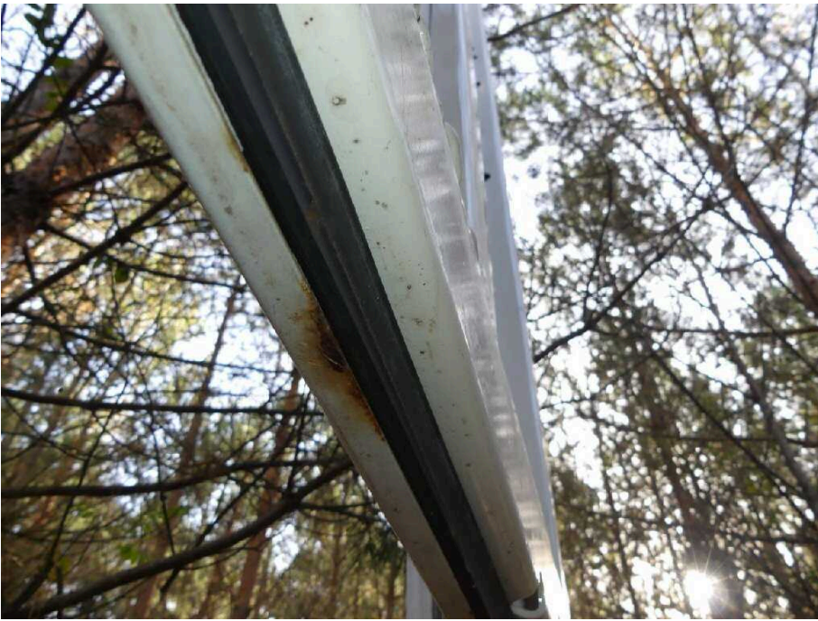
Bild 39 Fahrzeugheck Heckflügeltür rechts korrodiert
