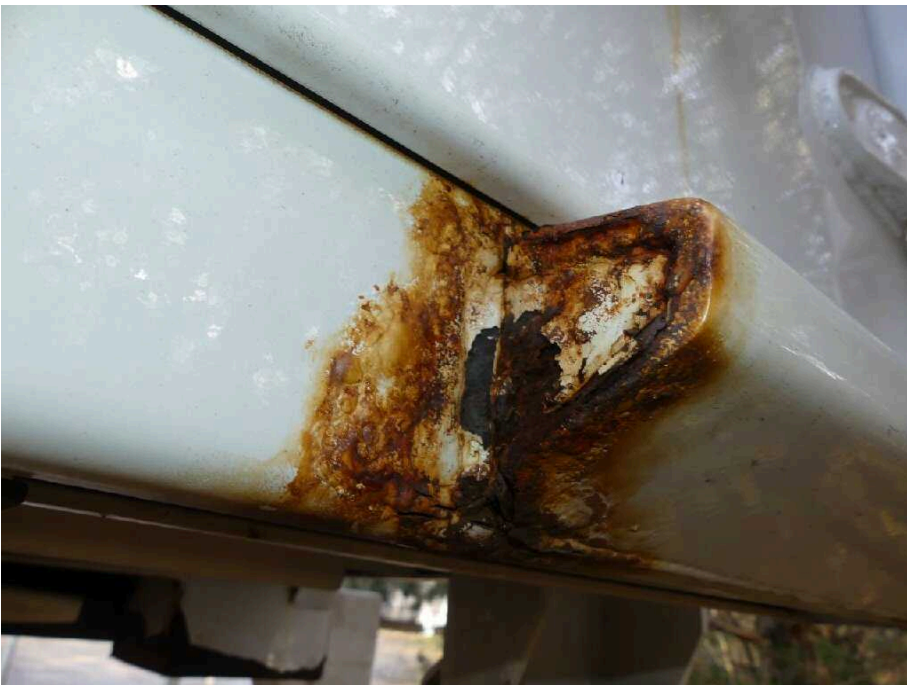
Bild 18 Fahrzeugheck Rahmen hinten hinten rechts korrodiert
