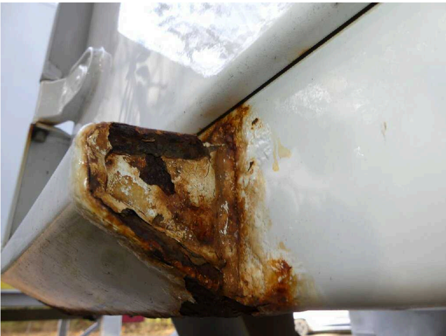
Bild 20 Fahrzeugheck Rahmen hinten links korrodiert
