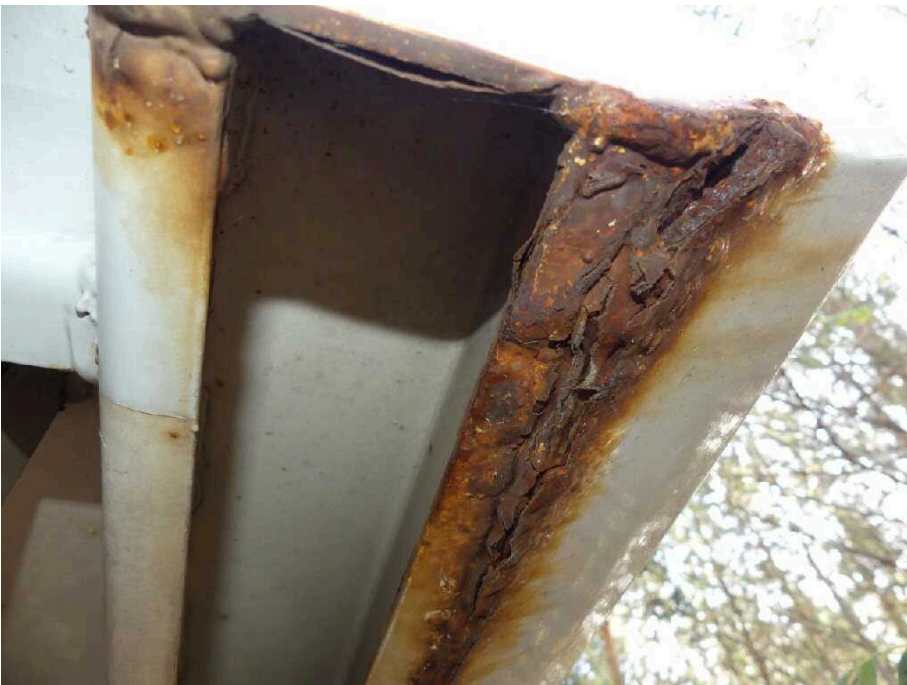
Bild 26 Fahrzeugheck Rahmen hinten links korrodiert
