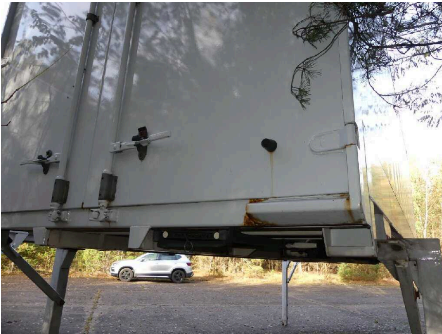
Bild 15 Fahrzeugheck Rahmen hinten hinten rechts korrodiert
