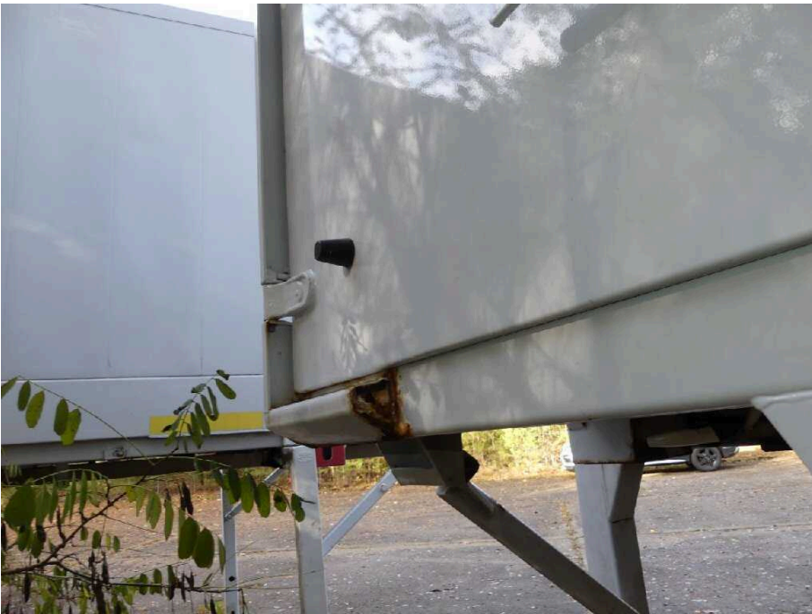
Bild 19 Fahrzeugheck Rahmen hinten links korrodiert
