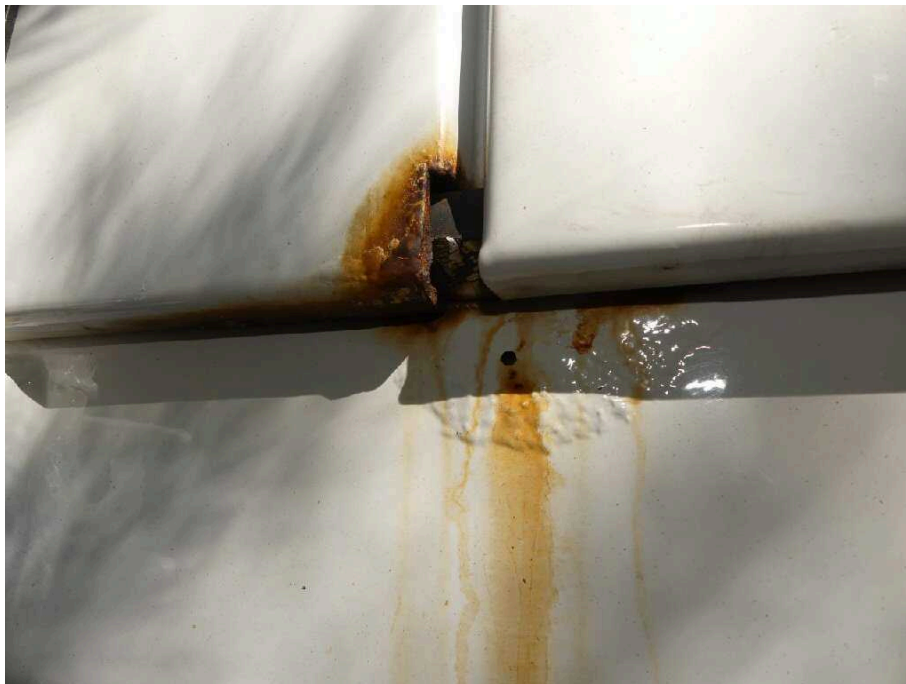
Bild 20 Fahrzeugheck Rahmen hinten Mitte korrodiert
