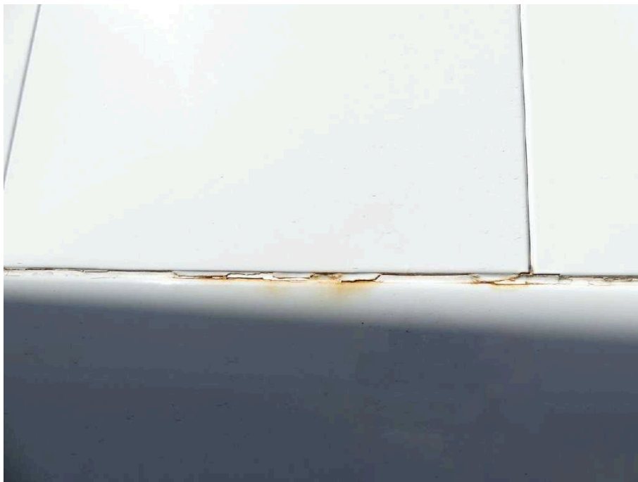
Bild 13 Fahrzeug Fahrzeugrahmen rechts korrodiert
