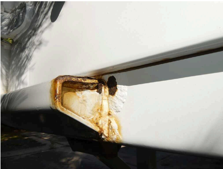
Bild 24 Fahrzeugheck Rahmen hinten links korrodiert
