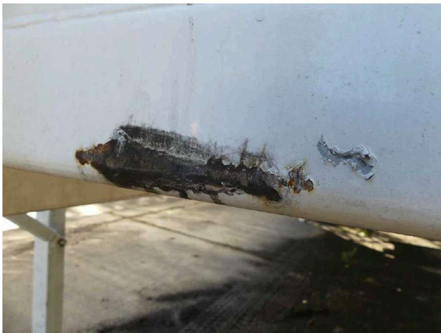
Bild 10 Fahrzeugfront Fahrzeugrahmen vorn korrodiert
