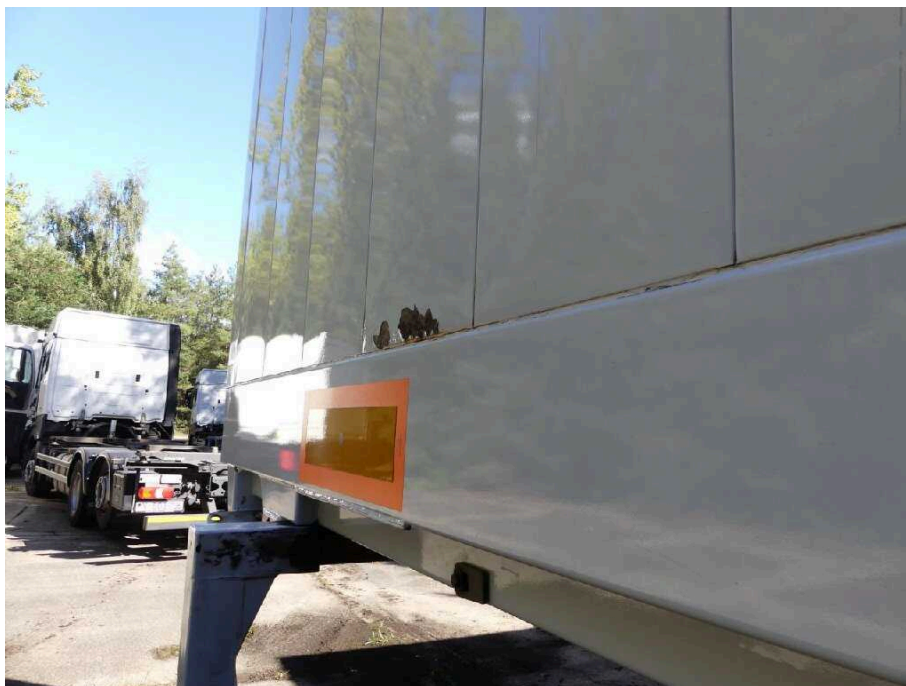
Bild 32 Fahrzeugfront Fahrzeugrahmen links korrodiert
