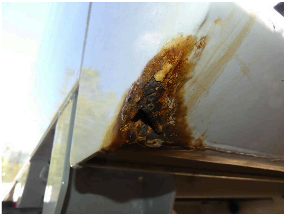
Bild 28 Fahrzeugheck Rahmen hinten links korrodiert
