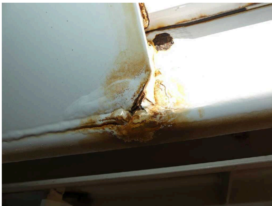
Bild 26 Fahrzeugheck Rahmen hinten links korrodiert
