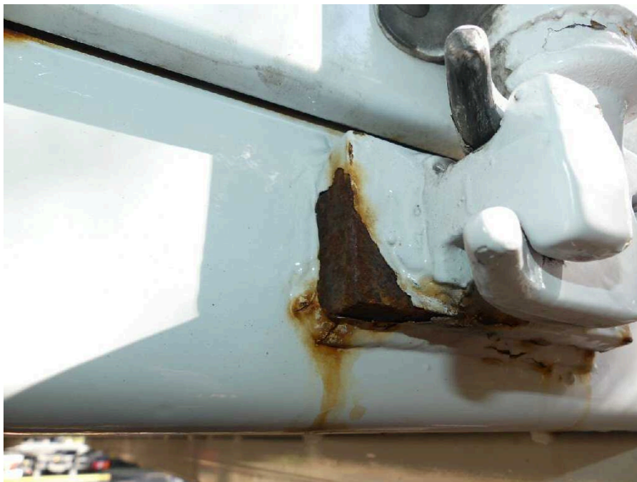
Bild 21 Fahrzeugheck Rahmen hinten Mitte korrodiert
