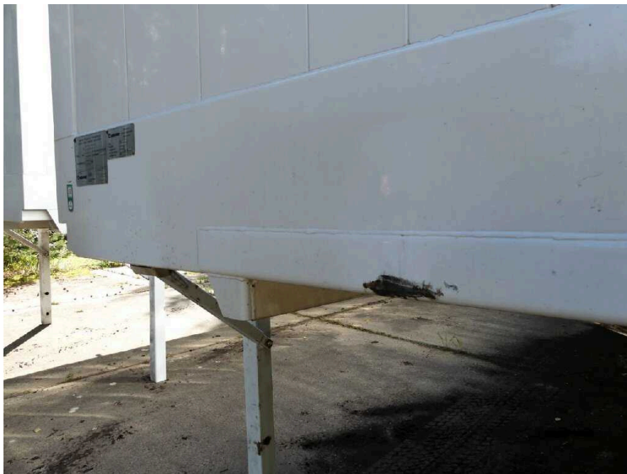
Bild 9 Fahrzeugfront Fahrzeugrahmen vorn korrodiert
