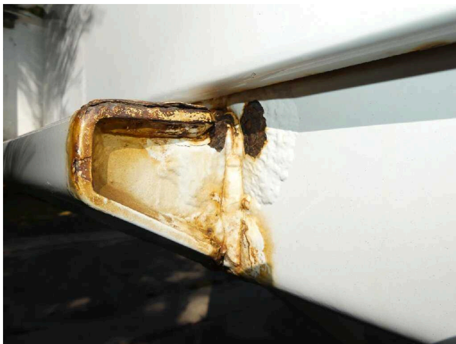
Bild 25 Fahrzeugheck Rahmen hinten links korrodiert
