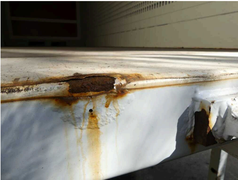
Bild 23 Fahrzeugheck Rahmen hinten Mitte korrodiert
