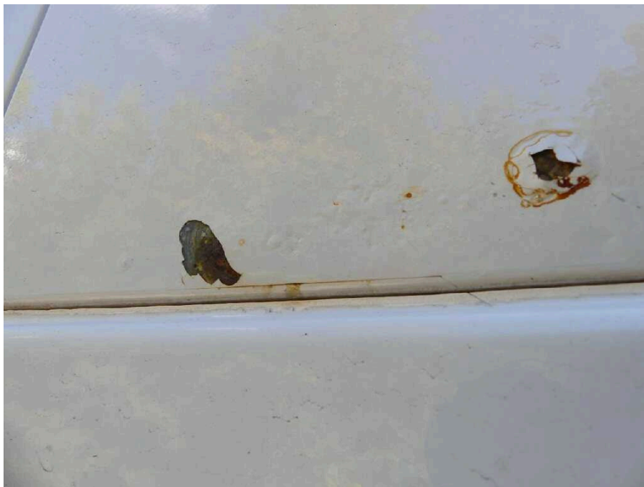
Bild 31 Fahrzeugfront Fahrzeugrahmen links korrodiert
