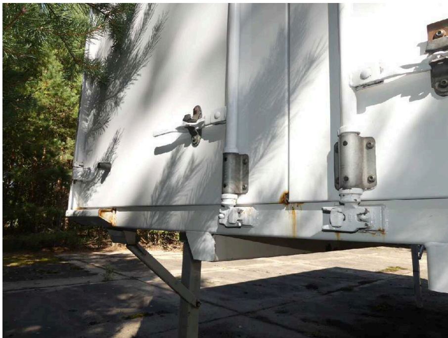
Bild 19 Fahrzeugheck Rahmen hinten Mitte korrodiert
