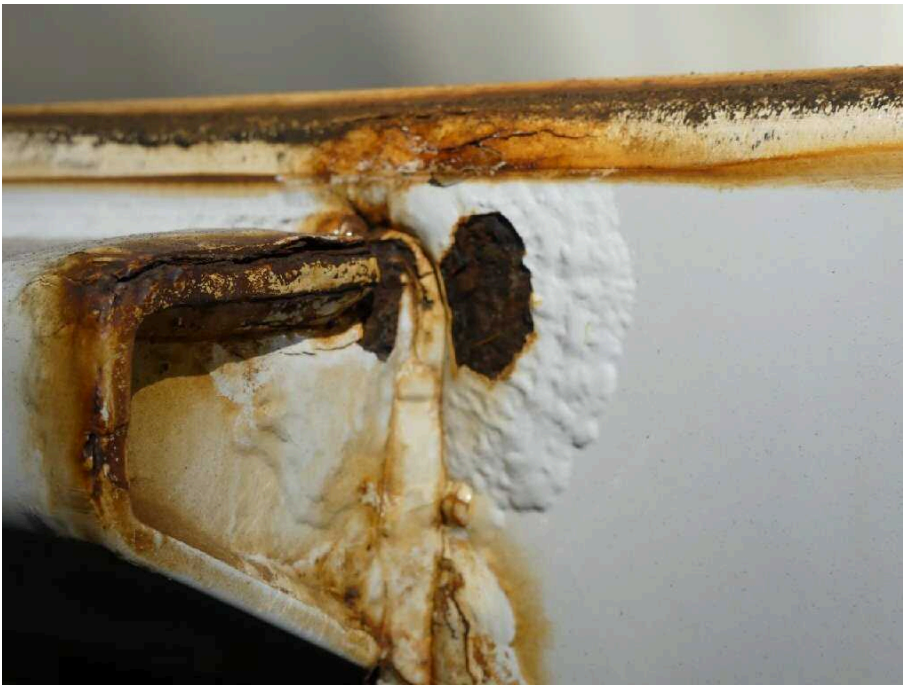
Bild 29 Fahrzeugheck Rahmen hinten links korrodiert
