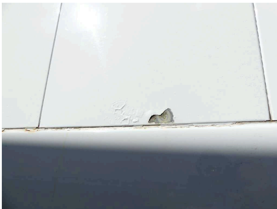
Bild 12 Fahrzeug Fahrzeugrahmen rechts korrodiert
