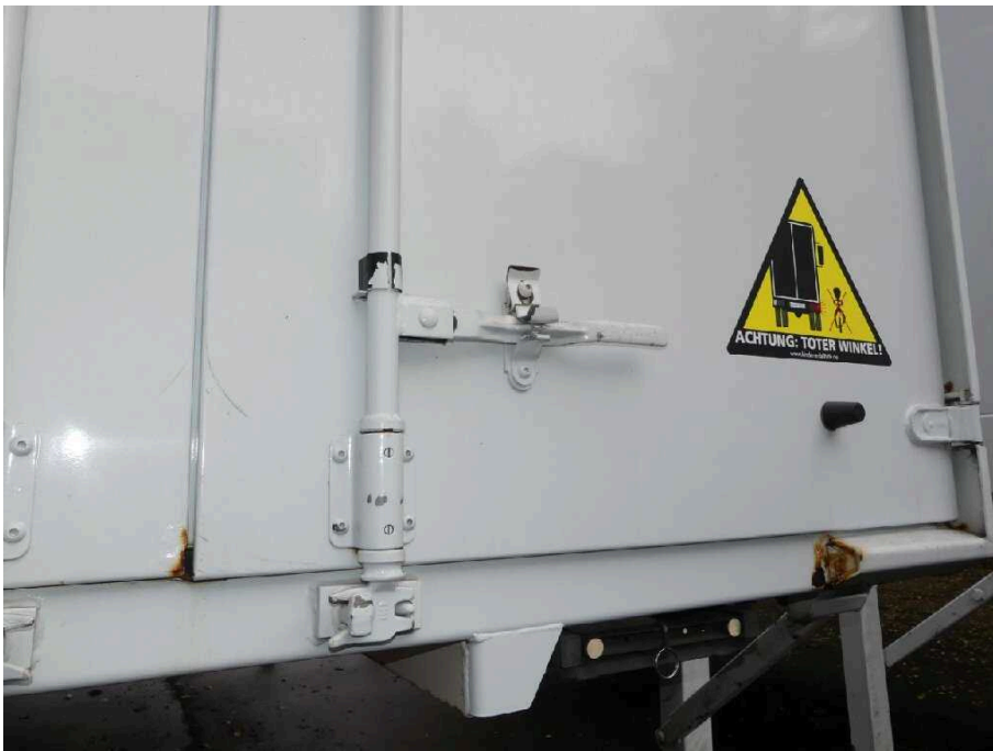
Bild 36 Fahrzeugheck Heckflügeltür rechts Führung Verschluss lose
