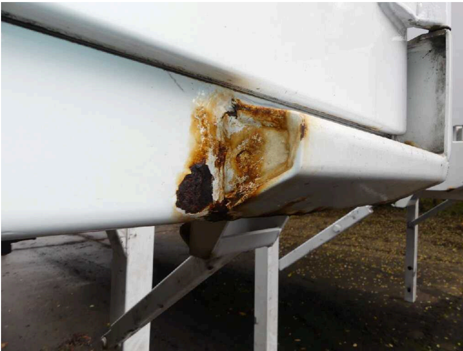
Bild 17 Fahrzeugheck Rahmen hinten rechts stark korrodiert
