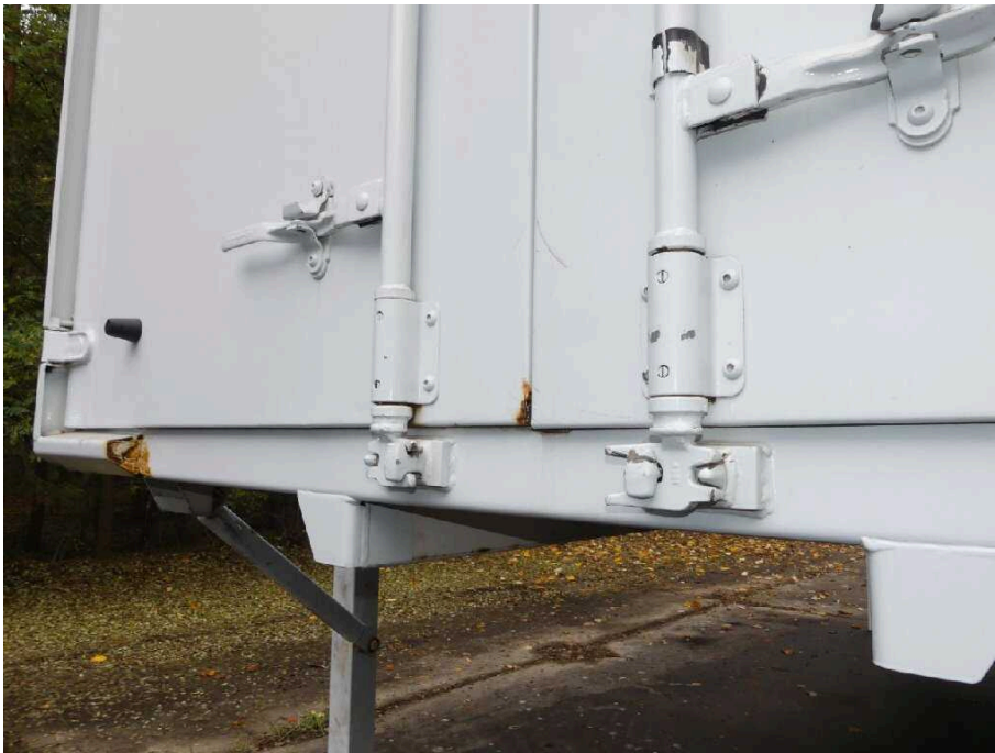
Bild 23 Fahrzeugheck Heckflügeltür links korrodiert
