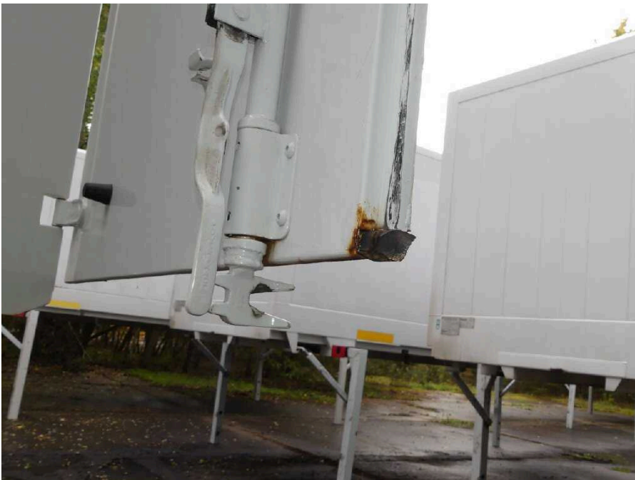
Bild 26 Fahrzeugheck Heckflügeltür links korrodiert
