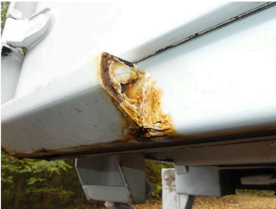
Bild 30 Fahrzeugheck Rahmen hinten links stark korrodiert
