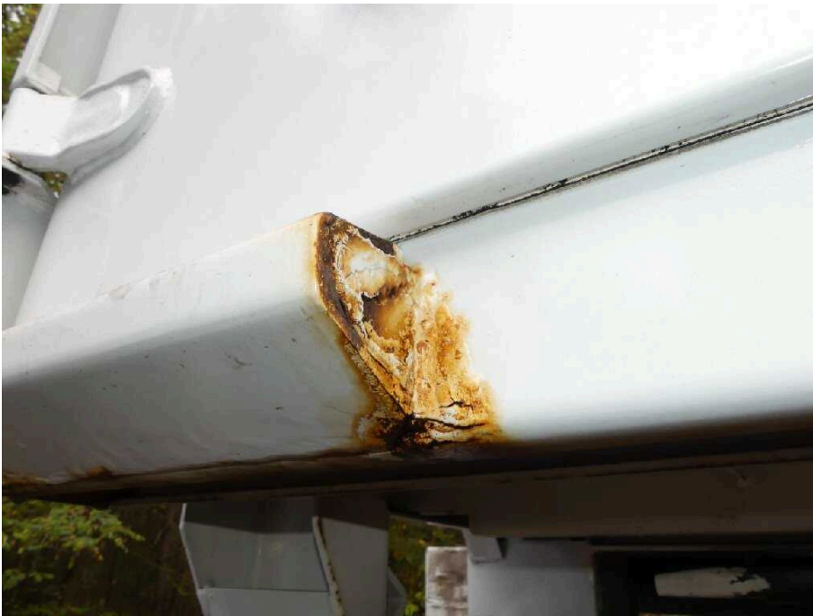
Bild 31 Fahrzeugheck Rahmen hinten links stark korrodiert
