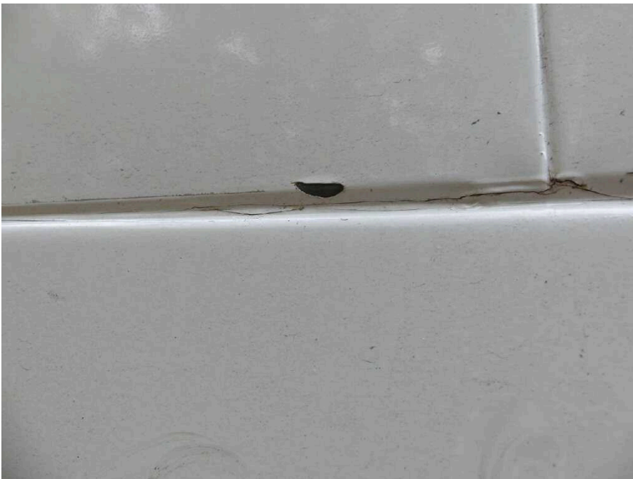
Bild 12 Fahrzeug Fahrzeug aussen links, Kratzer/korrodiert und Delle
