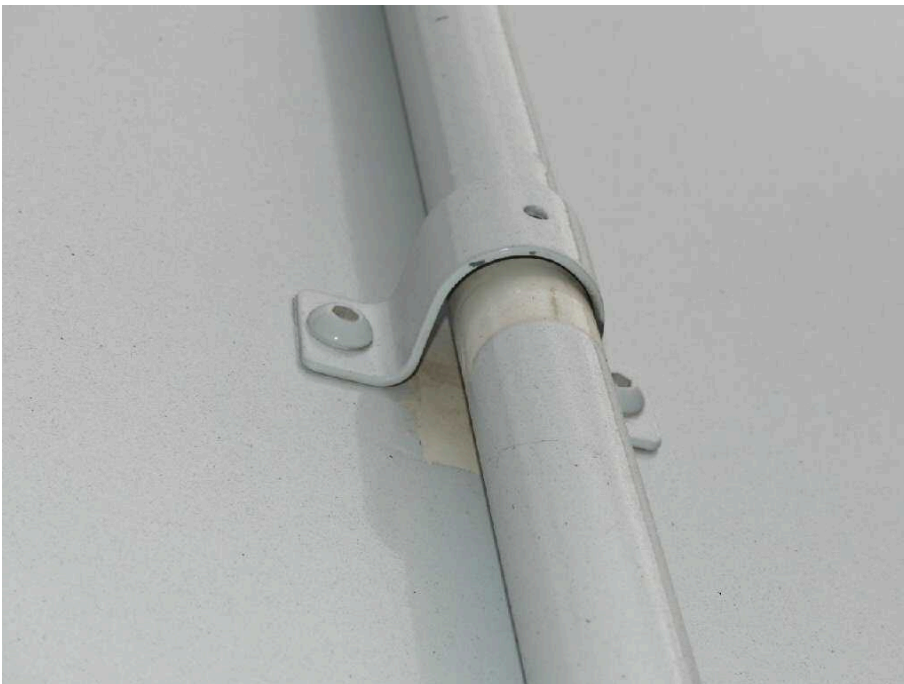
Bild 38 Fahrzeugheck Heckflügeltür rechts Führung Verschluss lose
