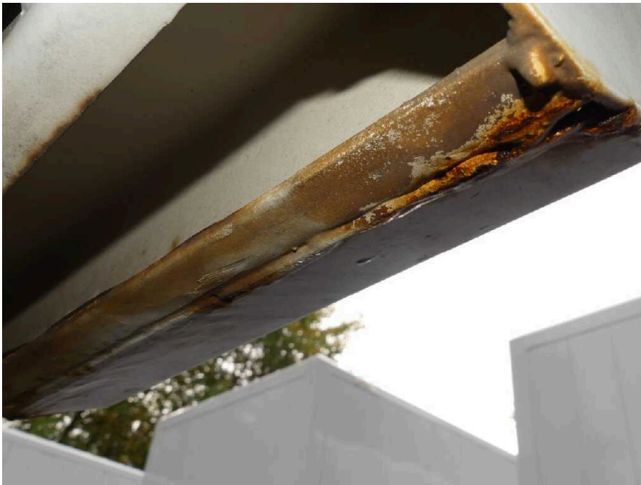
Bild 35 Fahrzeugheck Rahmen hinten links stark korrodiert
