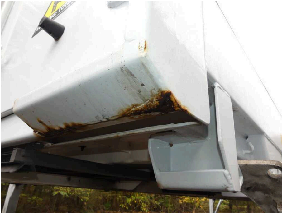
Bild 15 Fahrzeugheck Rahmen hinten rechts stark korrodiert
