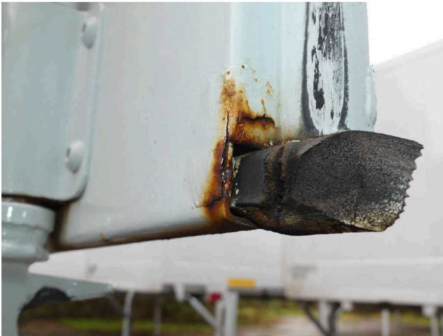
Bild 27 Fahrzeugheck Heckflügeltür links korrodiert
