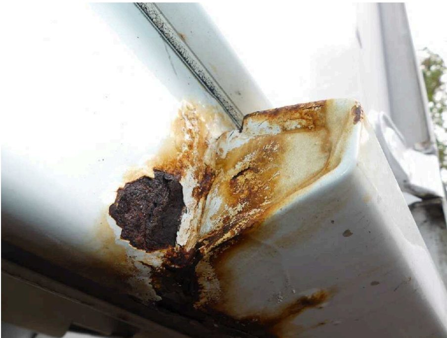
Bild 18 Fahrzeugheck Rahmen hinten rechts stark korrodiert
