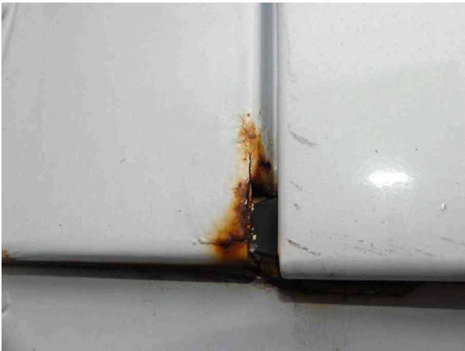
Bild 24 Fahrzeugheck Heckflügeltür links korrodiert
