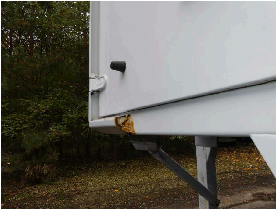
Bild 29 Fahrzeugheck Rahmen hinten links stark korrodiert
