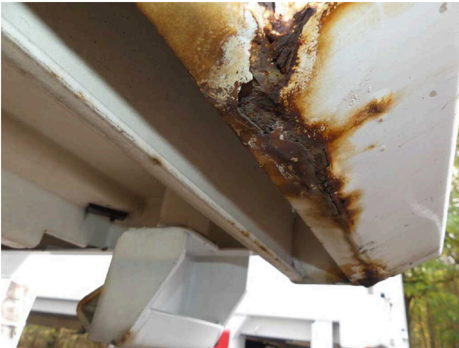
Bild 19 Fahrzeugheck Rahmen hinten rechts stark korrodiert
