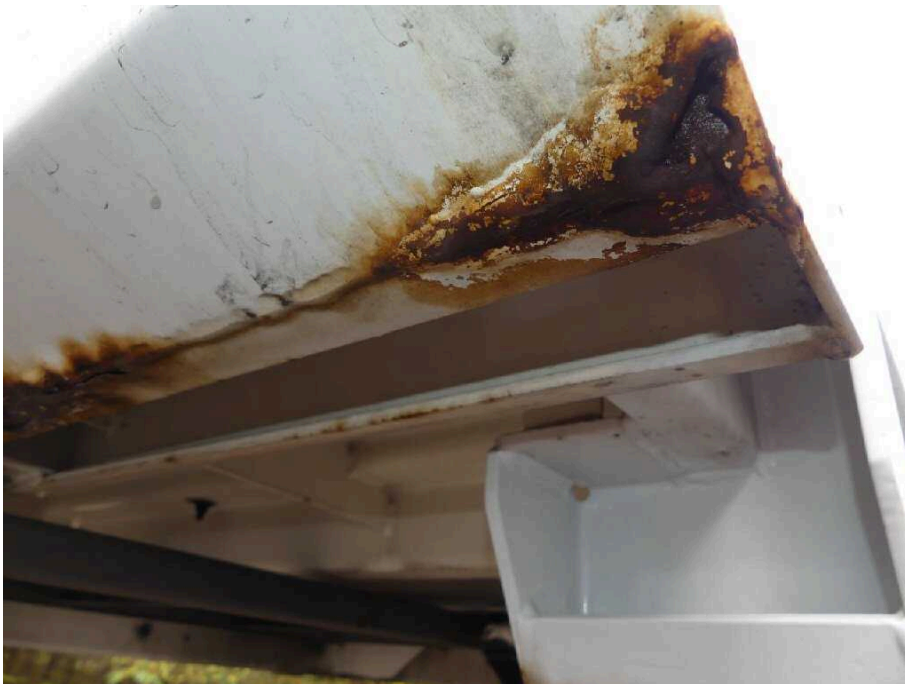
Bild 16 Fahrzeugheck Rahmen hinten rechts stark korrodiert
