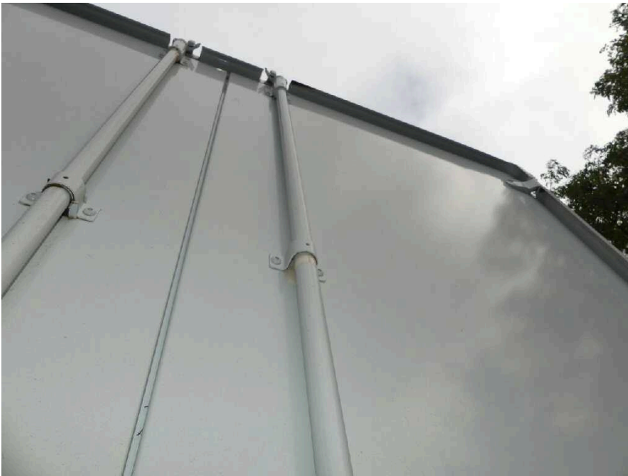
Bild 37 Fahrzeugheck Heckflügeltür rechts Führung Verschluss lose
