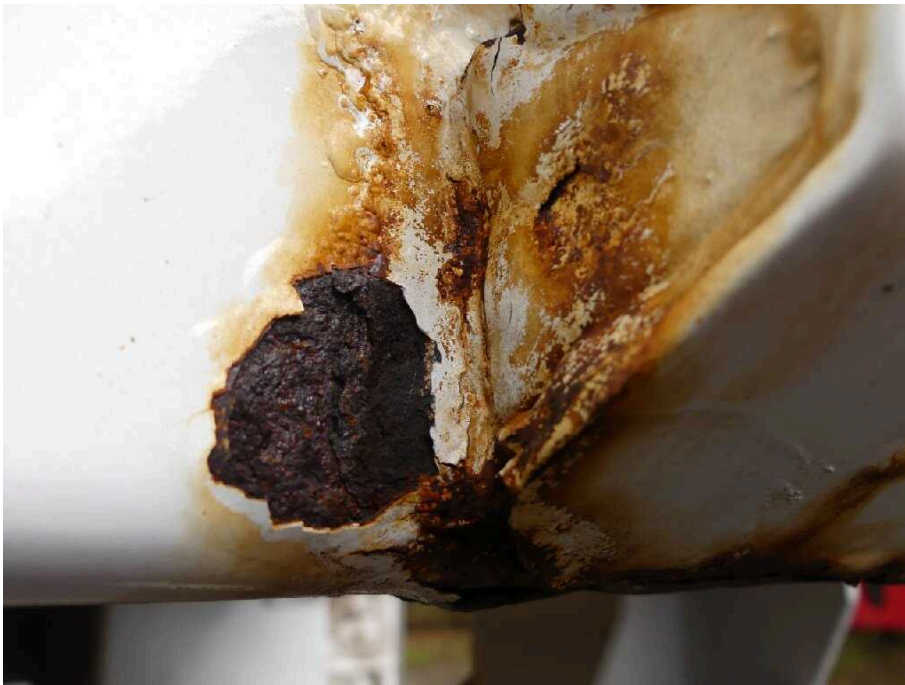
Bild 21 Fahrzeugheck Rahmen hinten rechts stark korrodiert
