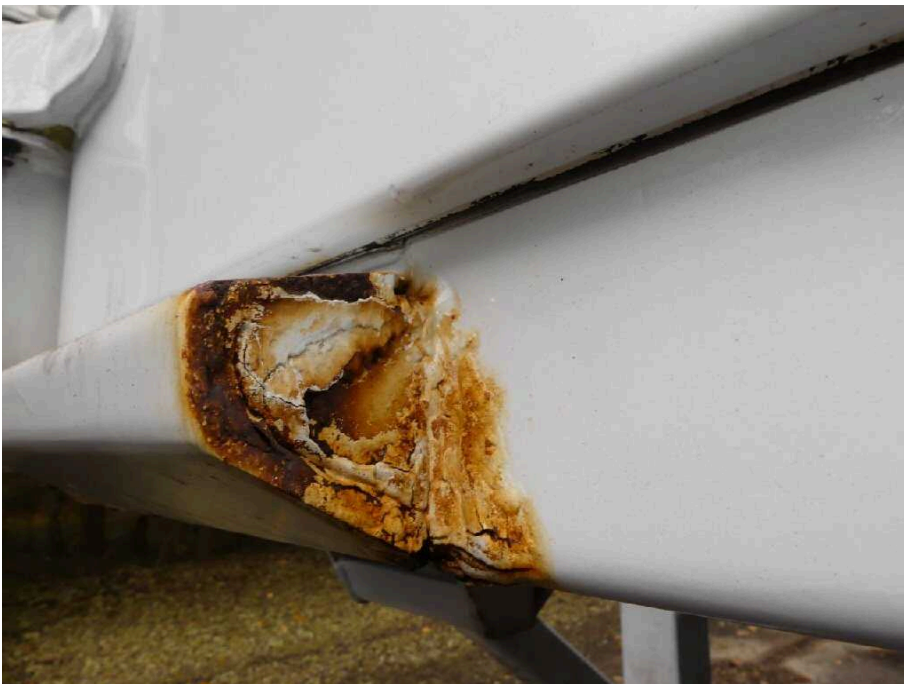
Bild 34 Fahrzeugheck Rahmen hinten links stark korrodiert
