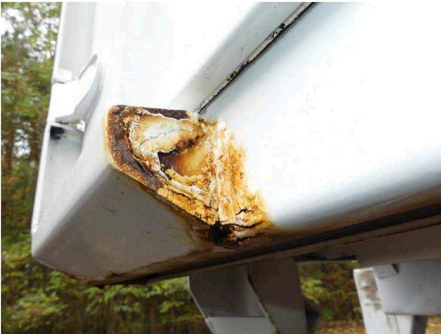
Bild 33 Fahrzeugheck Rahmen hinten links stark korrodiert
