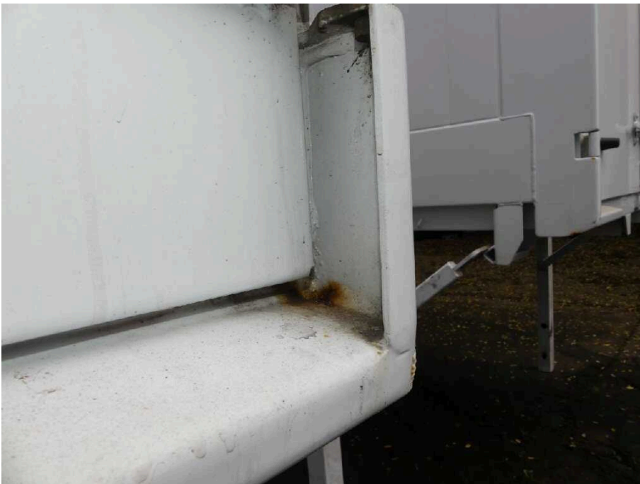
Bild 20 Fahrzeugheck Rahmen hinten rechts stark korrodiert
