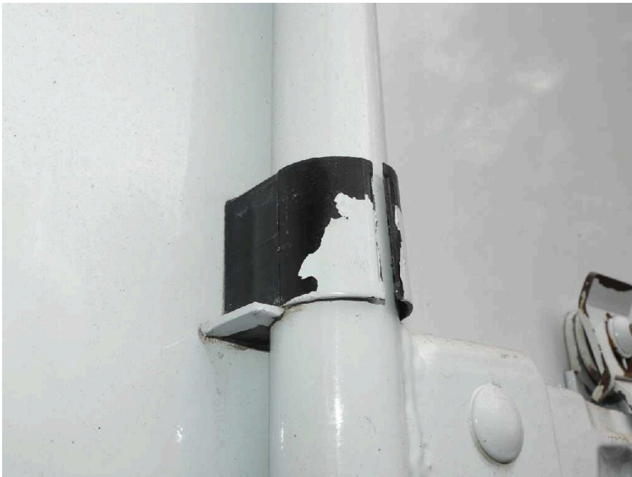
Bild 39 Fahrzeugheck Heckflügeltür rechts Führung Verschluss lose
