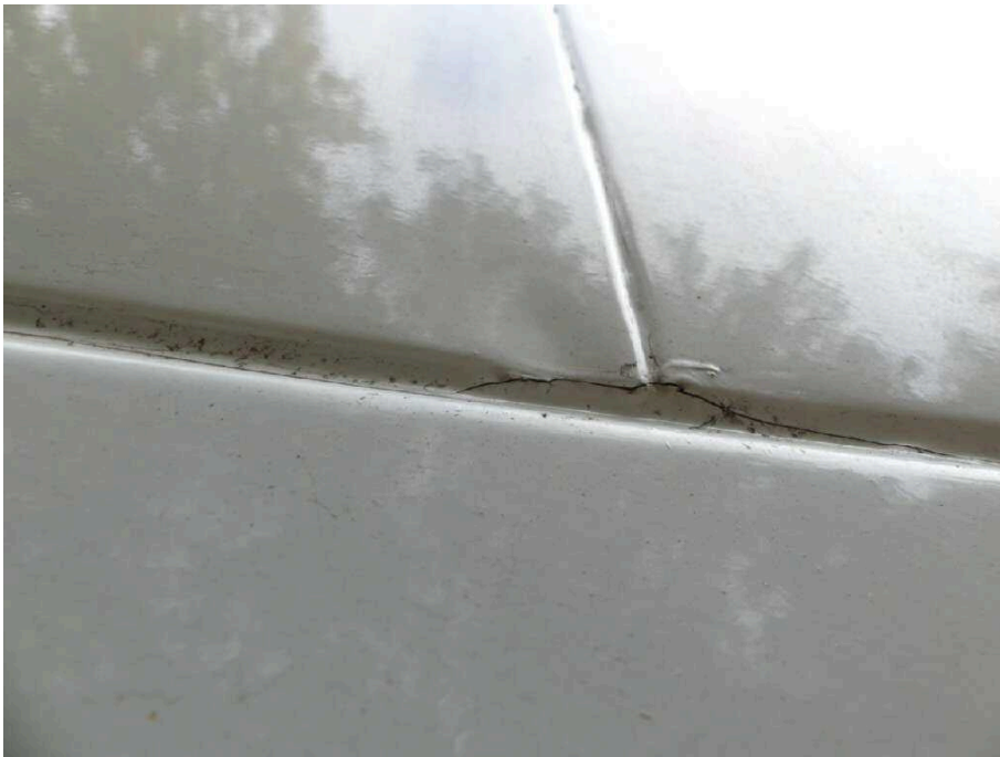
Bild 13 Fahrzeug Fahrzeug aussen links, Kratzer/korrodiert und Delle
