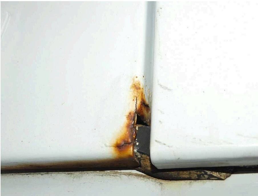
Bild 25 Fahrzeugheck Heckflügeltür links korrodiert
