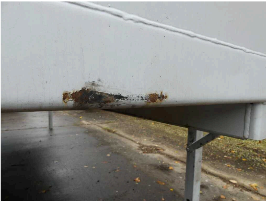
Bild 10 Aufbau Bodenrahmen vorne korrodiert
