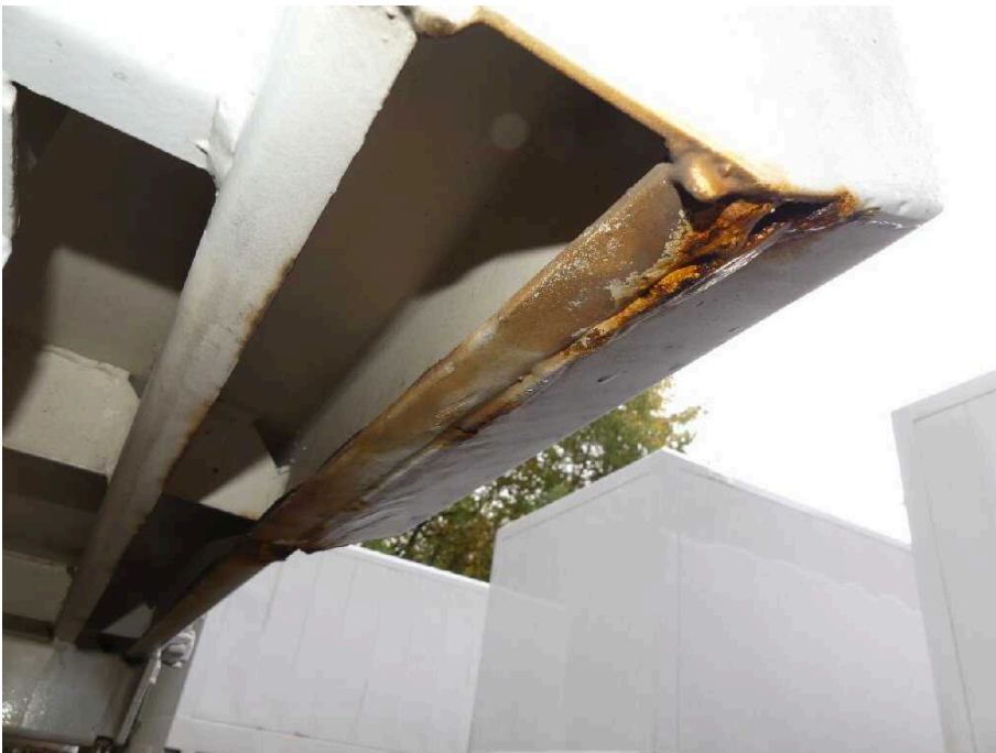
Bild 32 Fahrzeugheck Rahmen hinten links stark korrodiert
