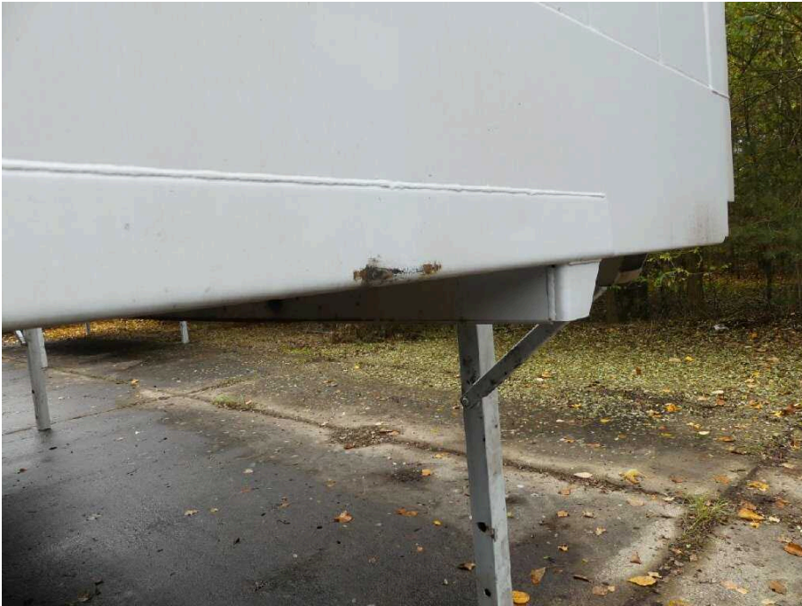
Bild 9 Aufbau Bodenrahmen vorne korrodiert
