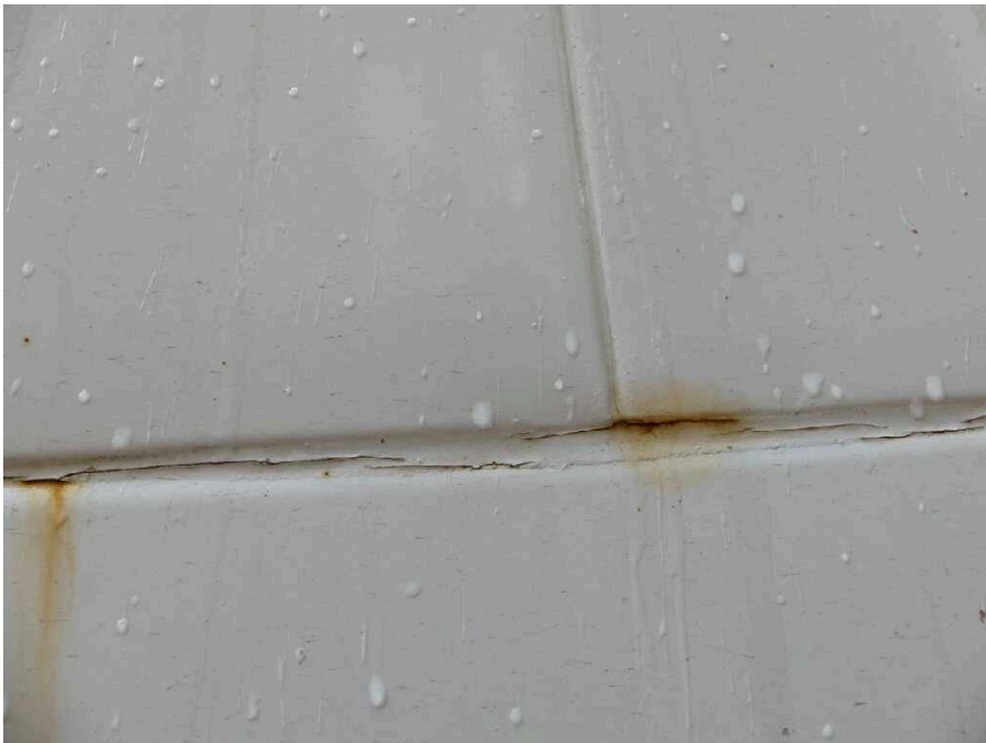
Bild 13 Fahrzeug Fahrzeug aussen links, korrodiert und verkratzt
