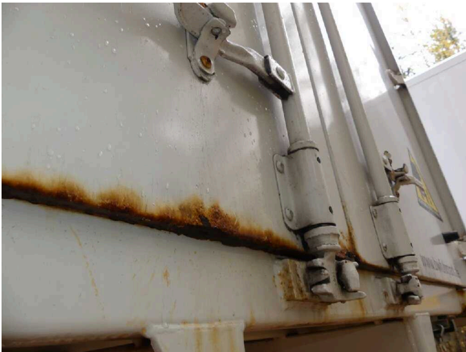
Bild 16 Fahrzeugheck Heckflügeltür links stark korrodiert
