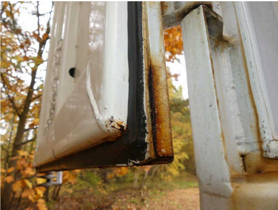
Bild 21 Fahrzeugheck Heckflügeltür links stark korrodiert
