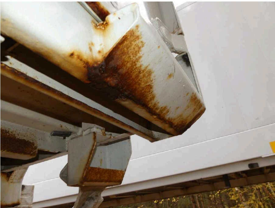
Bild 34 Fahrzeugheck Rahmen hinten rechts korrodiert
