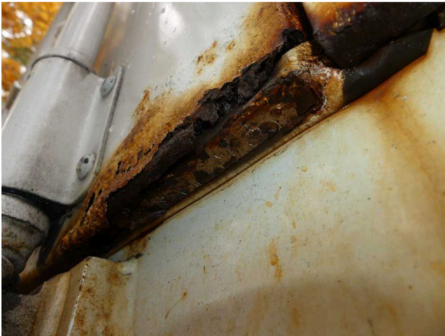
Bild 19 Fahrzeugheck Heckflügeltür links stark korrodiert
