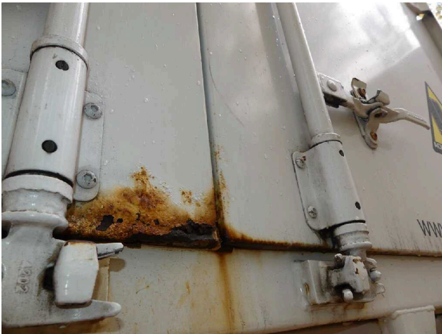
Bild 18 Fahrzeugheck Heckflügeltür links stark korrodiert
