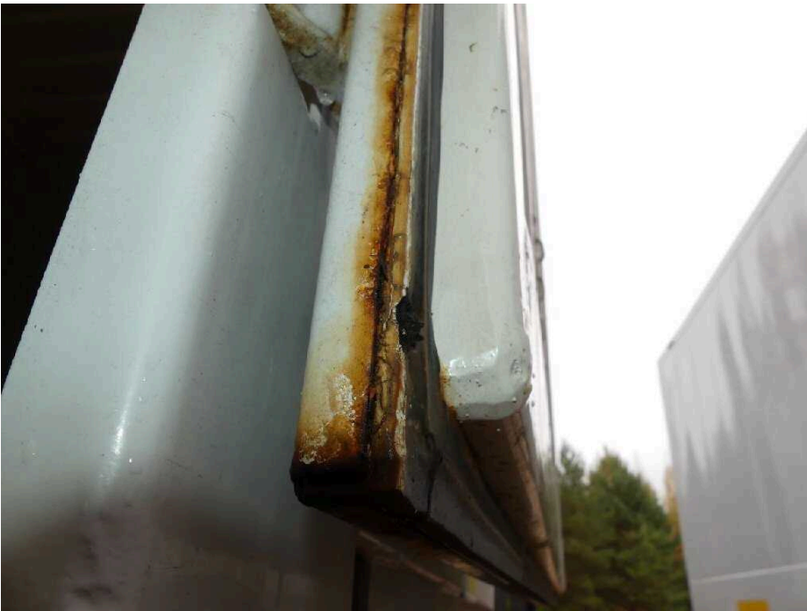
Bild 25 Fahrzeugheck Heckflügeltür rechts korrodiert
