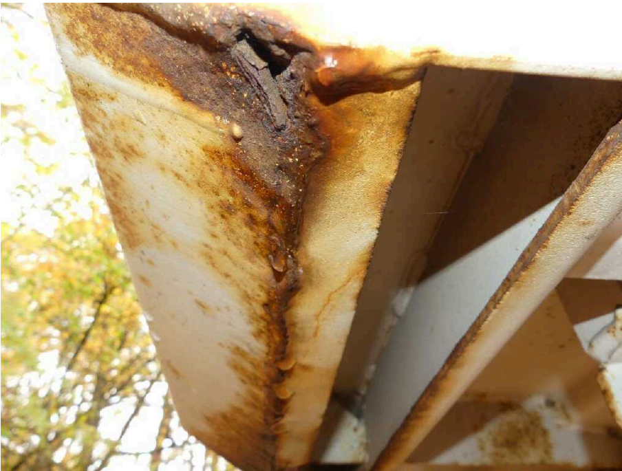
Bild 39 Fahrzeugheck Rahmen hinten rechts korrodiert
