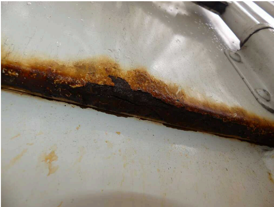
Bild 17 Fahrzeugheck Heckflügeltür links stark korrodiert
