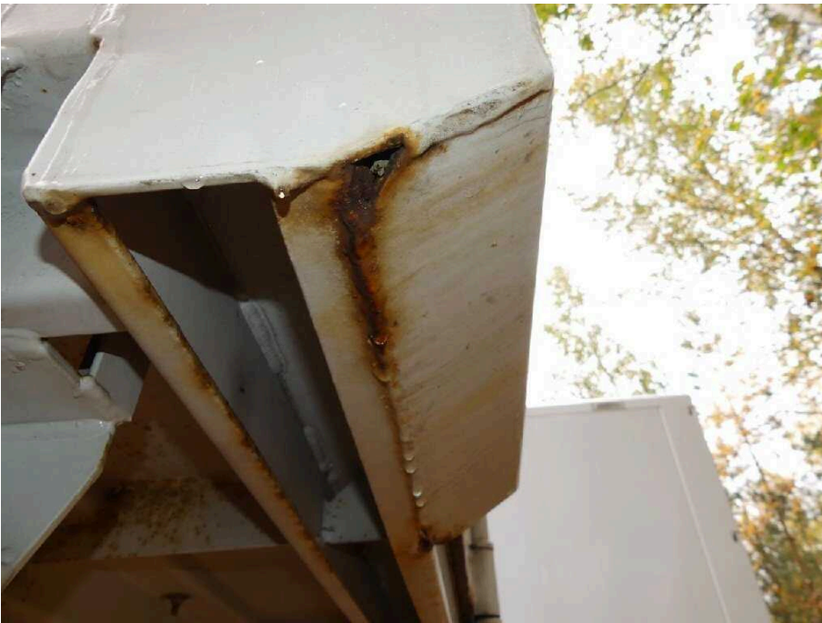
Bild 31 Fahrzeugheck Rahmen hinten links korrodiert
