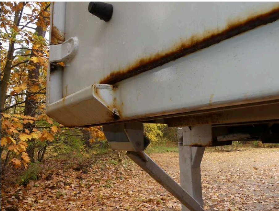
Bild 32 Fahrzeugheck Rahmen hinten links korrodiert
