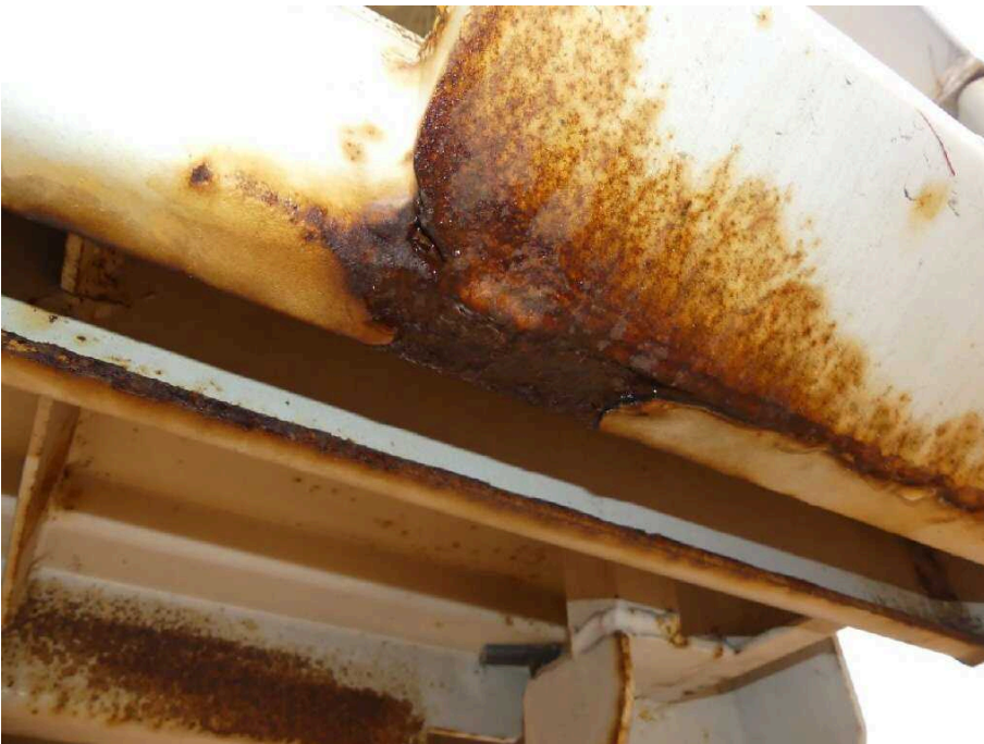
Bild 38 Fahrzeugheck Rahmen hinten rechts korrodiert
