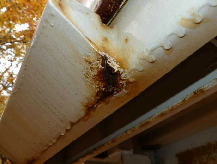
Bild 33 Fahrzeugheck Rahmen hinten links korrodiert
