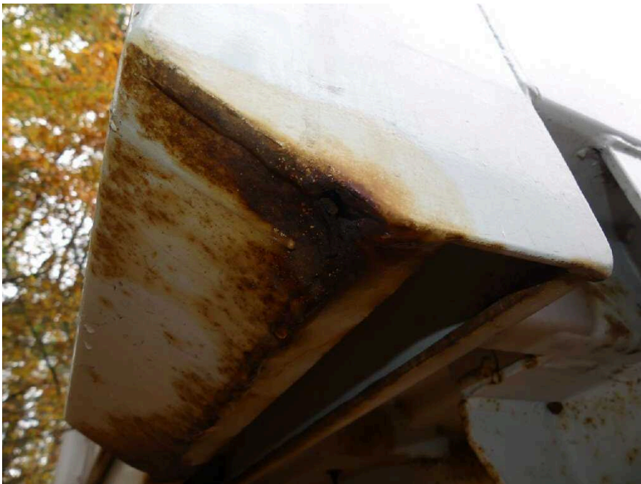
Bild 36 Fahrzeugheck Rahmen hinten rechts korrodiert
