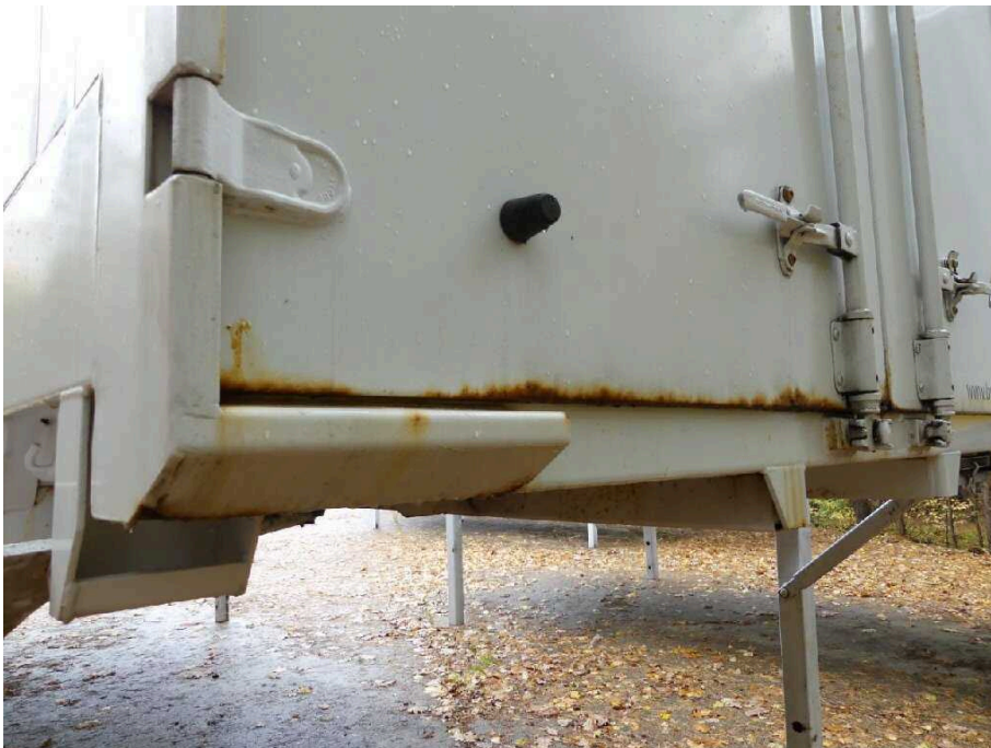
Bild 14 Fahrzeugheck Heckflügeltür links stark korrodiert
