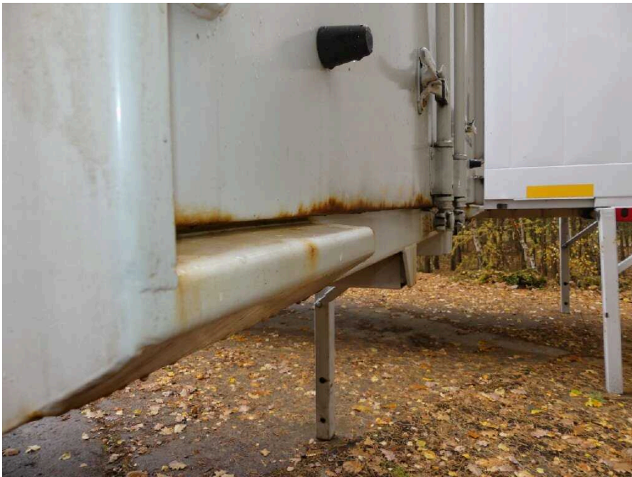
Bild 15 Fahrzeugheck Heckflügeltür links stark korrodiert
