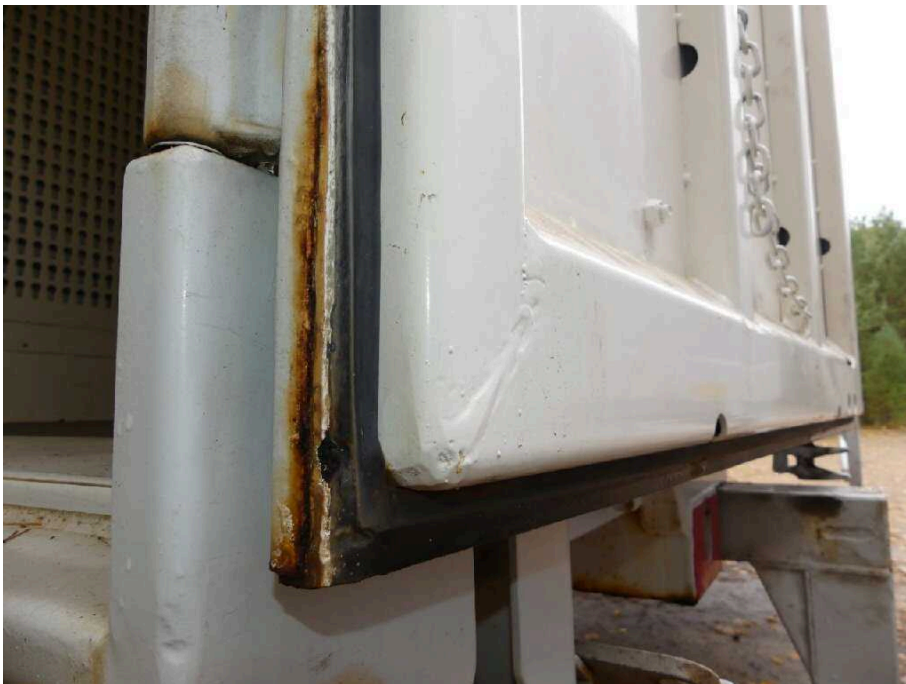
Bild 24 Fahrzeugheck Heckflügeltür rechts korrodiert
