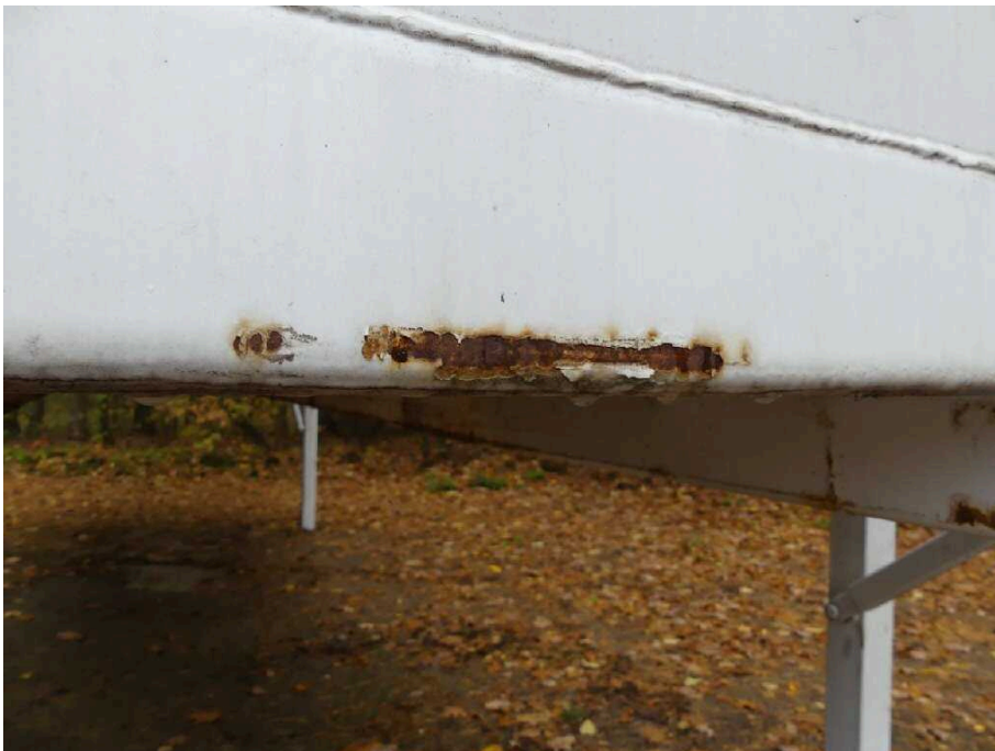
Bild 10 Aufbau Bodenrahmen vorne korrodiert
