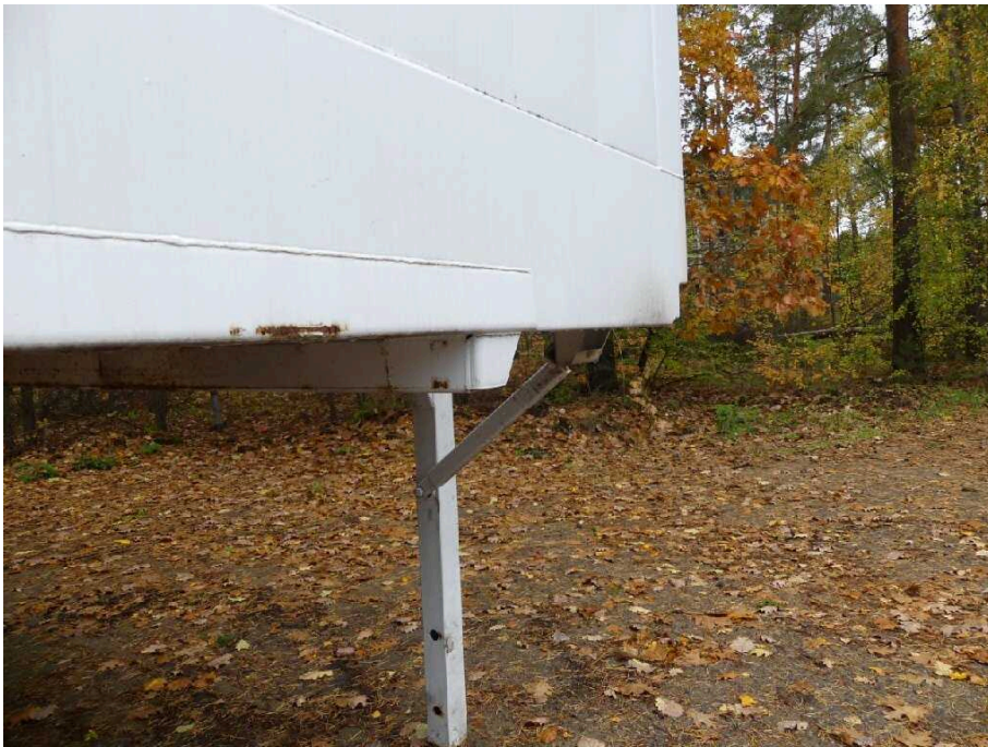
Bild 9 Aufbau Bodenrahmen vorne korrodiert
