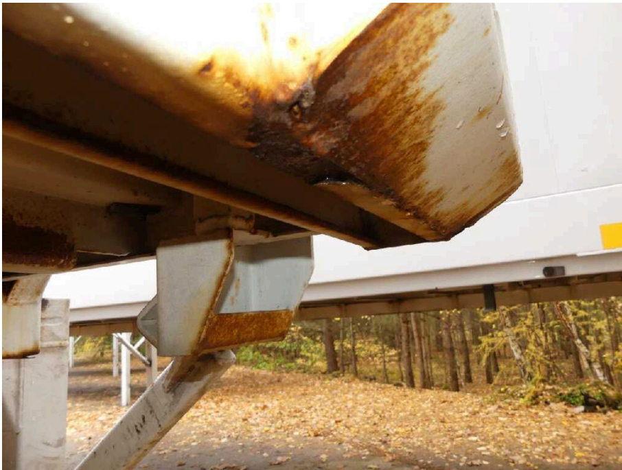
Bild 35 Fahrzeugheck Rahmen hinten rechts korrodiert
