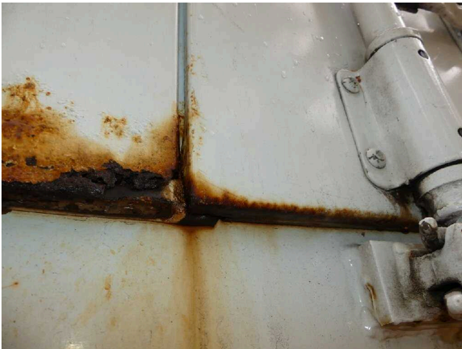
Bild 20 Fahrzeugheck Heckflügeltür links stark korrodiert
