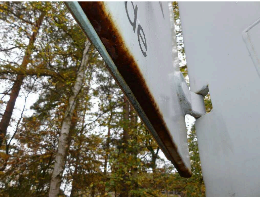
Bild 26 Fahrzeugheck Heckflügeltür rechts korrodiert
