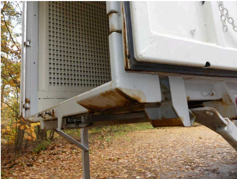
Bild 23 Fahrzeugheck Heckflügeltür rechts korrodiert
