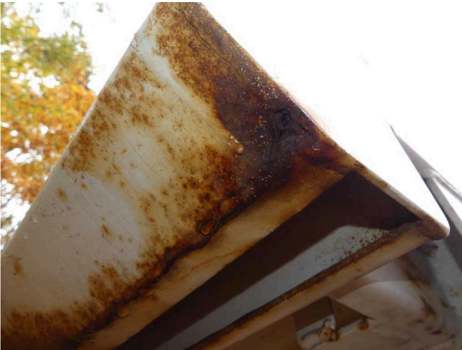
Bild 37 Fahrzeugheck Rahmen hinten rechts korrodiert
