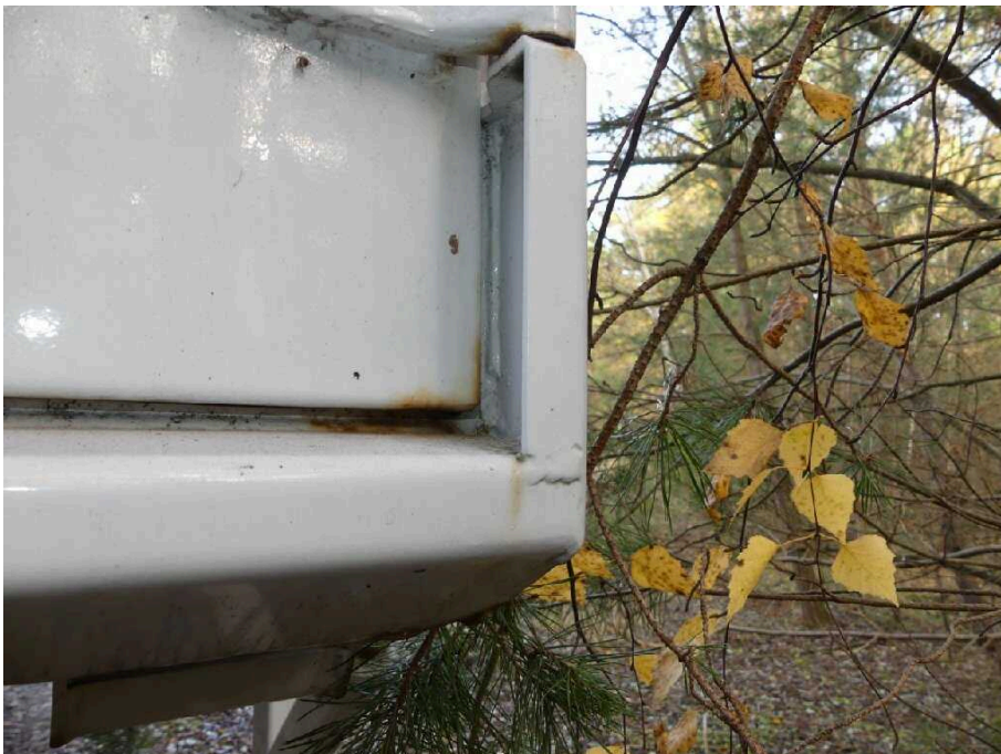
Bild 32 Fahrzeugheck Heckflügeltür rechts korrodiert
