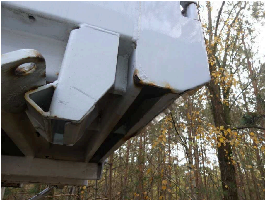
Bild 21 Fahrzeugheck Rahmen hinten links korrodiert
