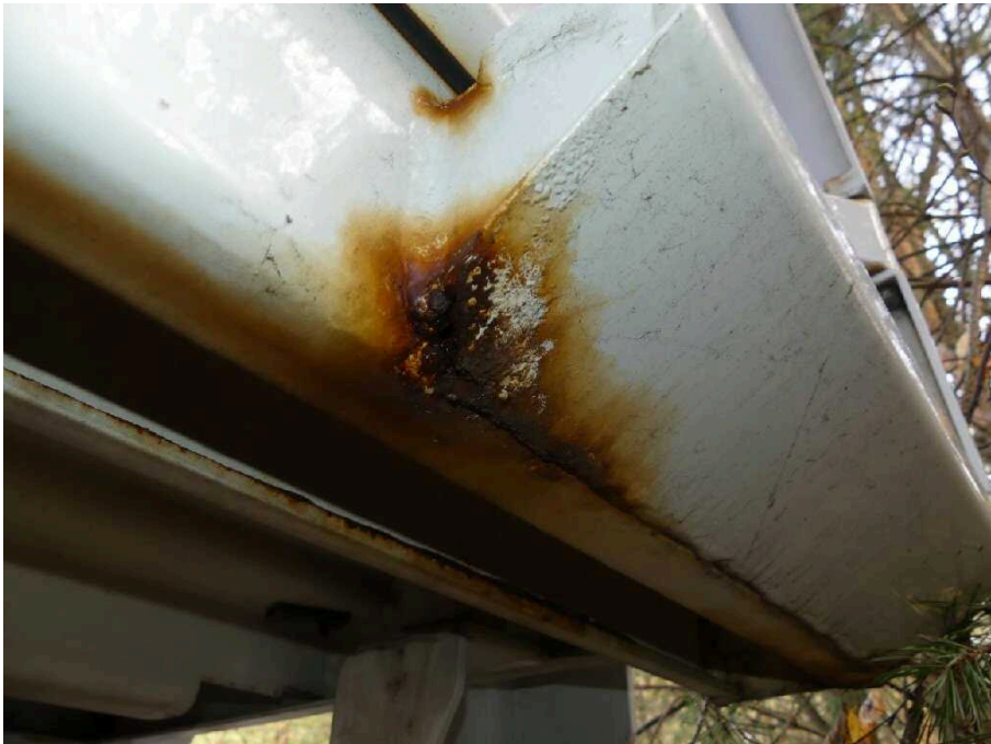
Bild 28 Fahrzeugheck Rahmen hinten rechts korrodiert
