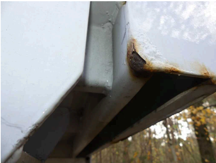
Bild 22 Fahrzeugheck Rahmen hinten links korrodiert
