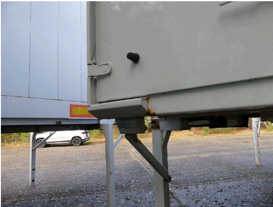
Bild 23 Fahrzeugheck Rahmen hinten links korrodiert
