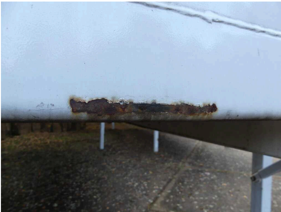
Bild 10 Aufbau Bodenrahmen vorne korrodiert
