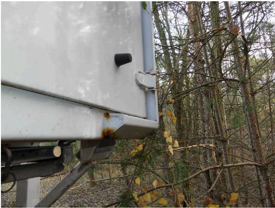
Bild 27 Fahrzeugheck Rahmen hinten rechts korrodiert
