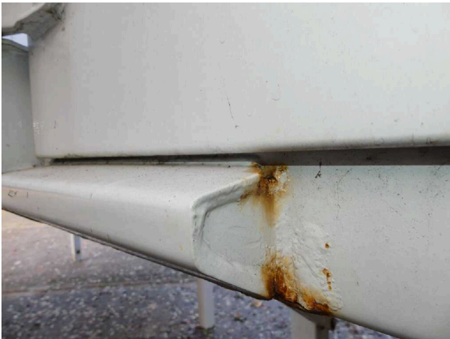
Bild 26 Fahrzeugheck Rahmen hinten links korrodiert
