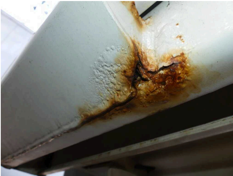
Bild 25 Fahrzeugheck Rahmen hinten links korrodiert
