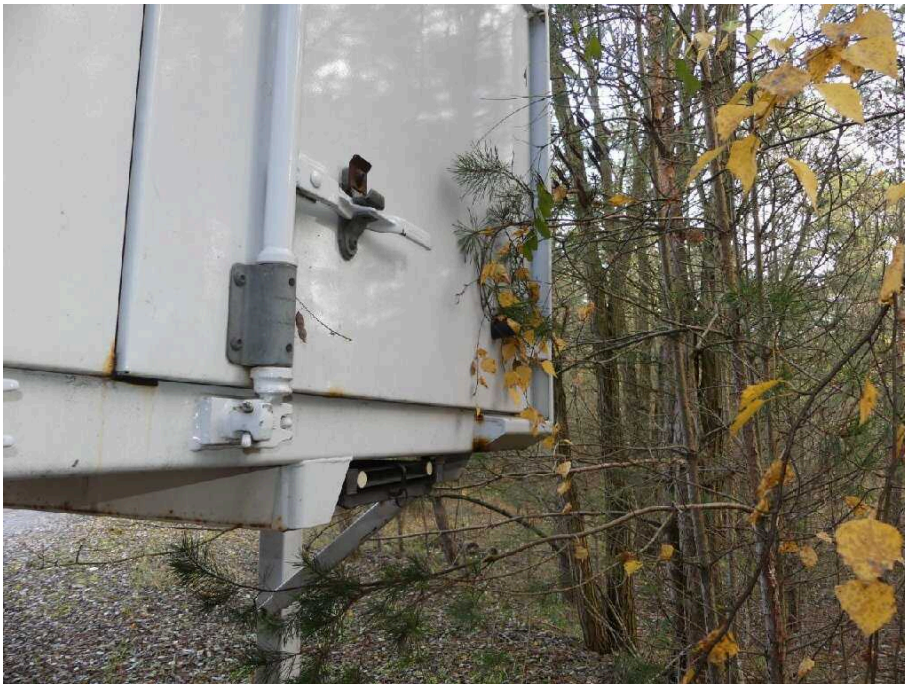
Bild 29 Fahrzeugheck Heckflügeltür rechts korrodiert
