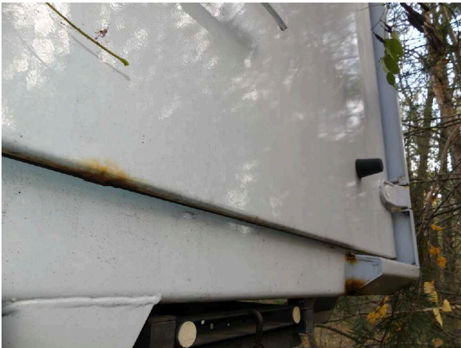
Bild 30 Fahrzeugheck Heckflügeltür rechts korrodiert
