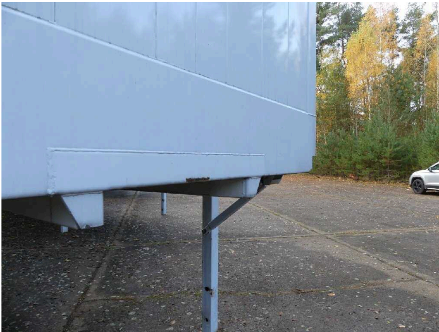
Bild 9 Aufbau Bodenrahmen vorne korrodiert
