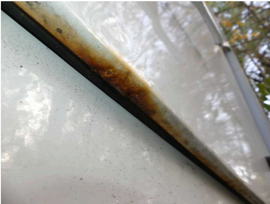
Bild 31 Fahrzeugheck Heckflügeltür rechts korrodiert
