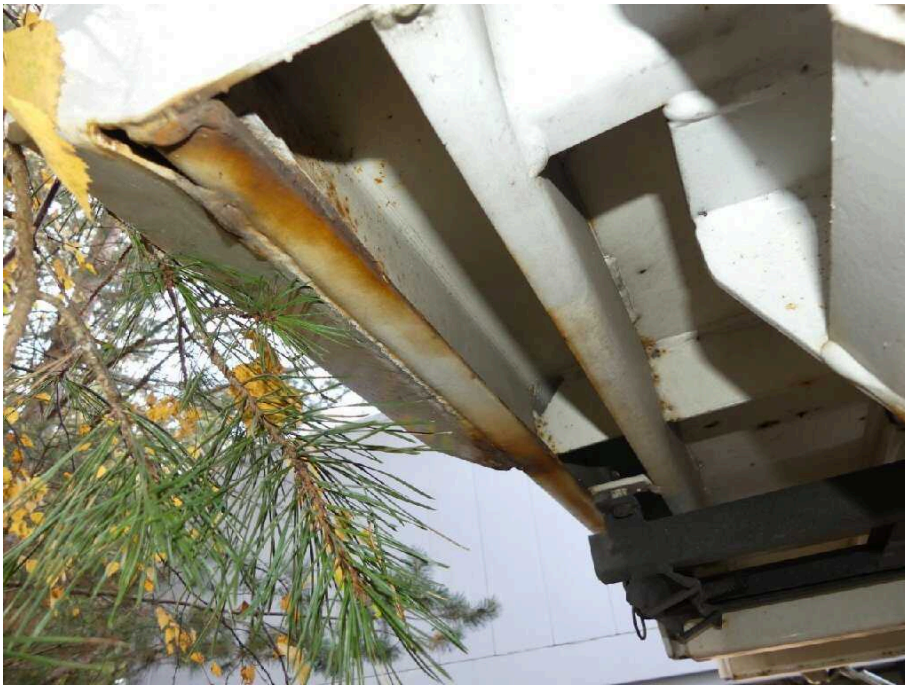
Bild 33 Fahrzeugheck Heckflügeltür rechts korrodiert
