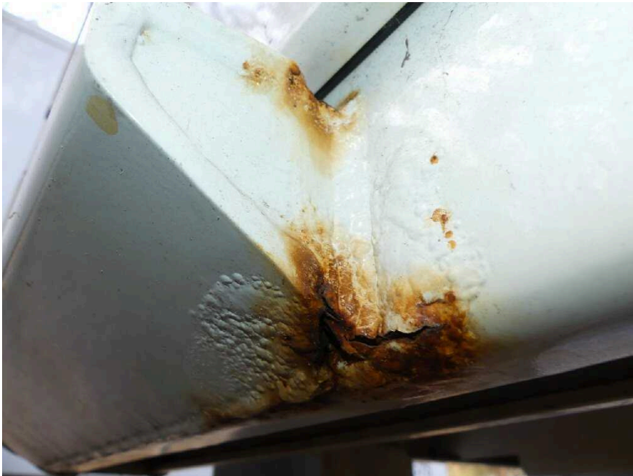
Bild 24 Fahrzeugheck Rahmen hinten links korrodiert
