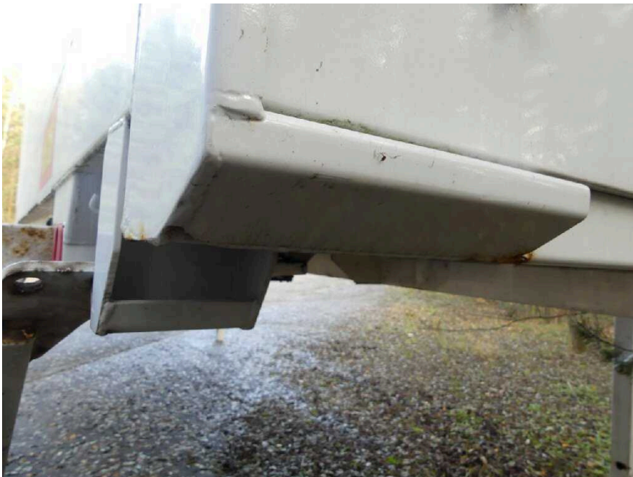
Bild 20 Fahrzeugheck Rahmen hinten links korrodiert
