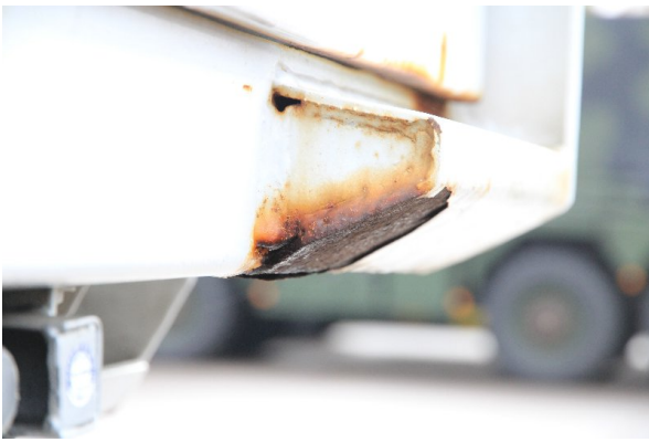
Bild 7: Heckbereich überdurchschnittlich starke Rostaufblühungen - entrosten, beilackieren
