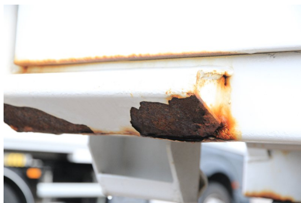
Bild 6: Heckbereich überdurchschnittlich starke Rostaufblühungen - entrosten, beilackieren
