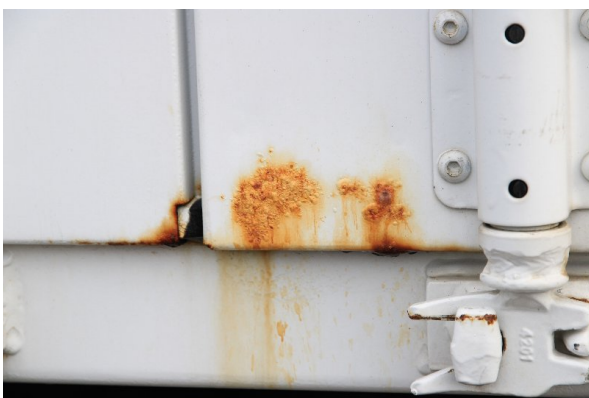
Bild 5: Heckbereich überdurchschnittlich starke Rostaufblühungen - entrosten, beilackieren
