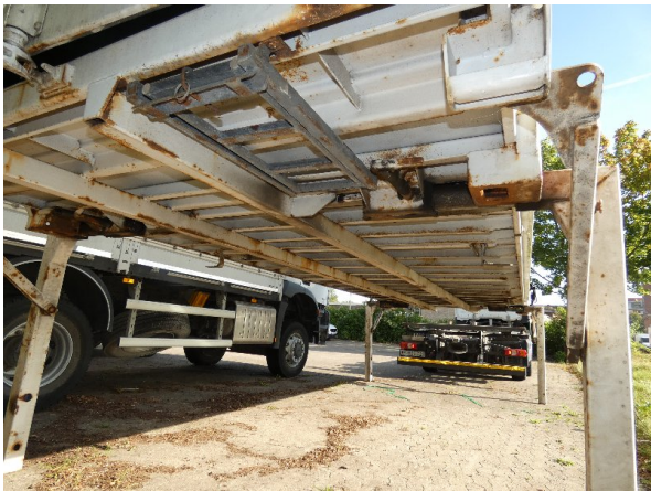
Bild 11: Rahmen und Stützbeine Korrosion - ohne Reparatur
