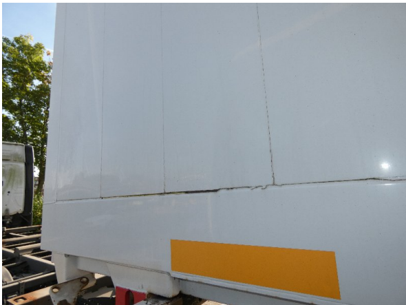
Bild 19: Seritenwand links außen Korrosion / Lackablösung - teillackieren
