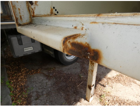
Bild 10: Portalrahmen unten Korrosion - ohne Reparatur
