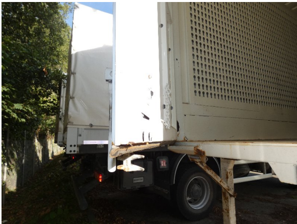
Bild 13: Hecktür links Korrosion - teillackieren
