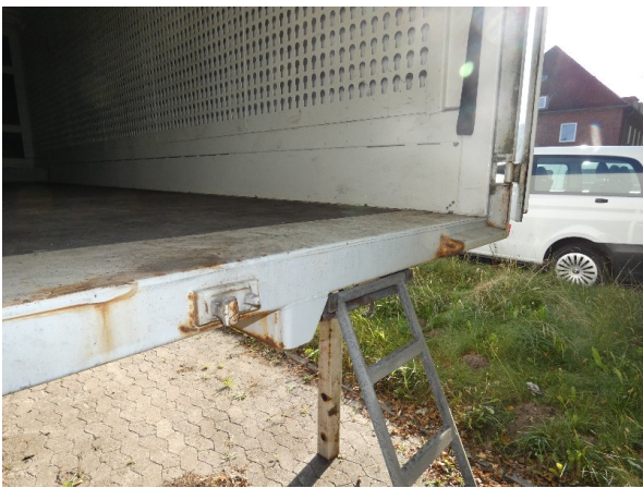
Bild 8: Portalrahmen unten Korrosion - ohne Reparatur
