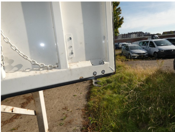
Bild 15: Hecktür rechts Innen - eingeschnitten - instandsetzen und lackieren
