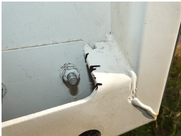
Bild 16: Hecktür rechts Innen - eingeschnitten - instandsetzen und lackieren
