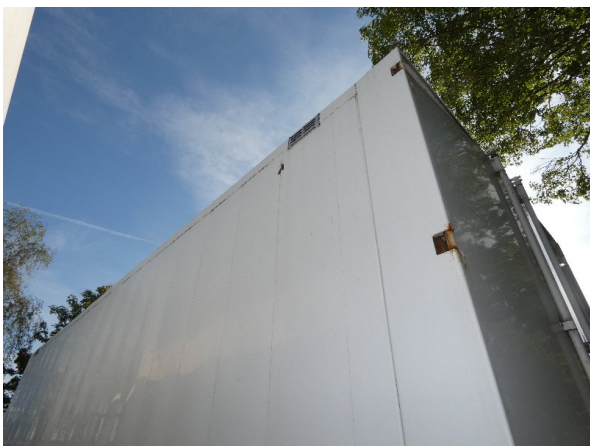
Bild 17: Seritenwand links außen Korrosion / Lackablösung - teillackieren
