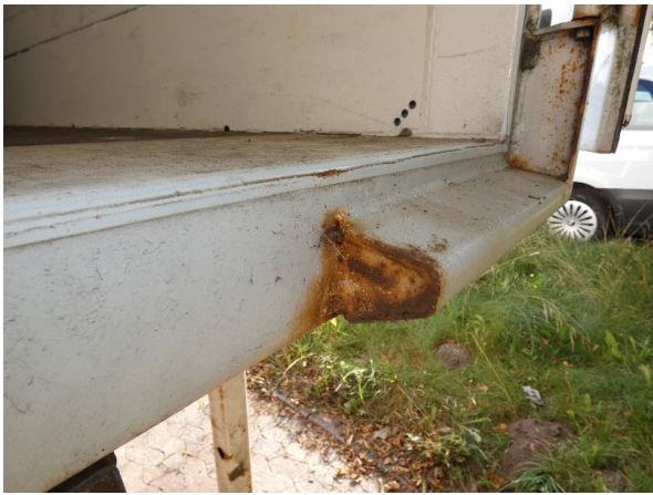
Bild 9: Portalrahmen unten Korrosion - ohne Reparatur
