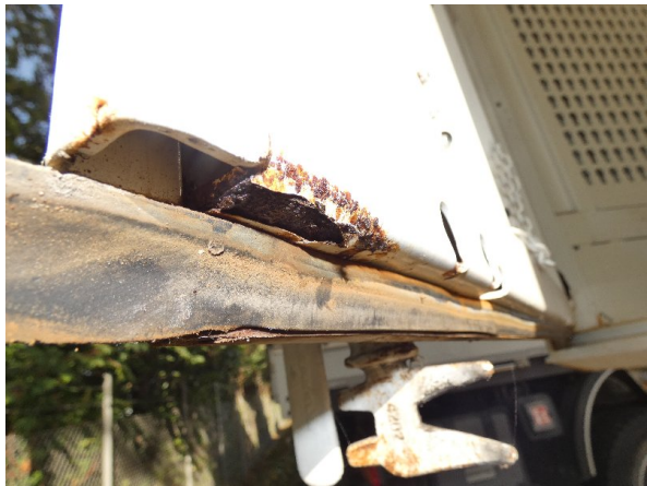
Bild 14: Hecktür links Korrosion - teillackieren
