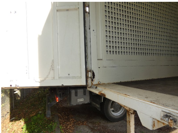
Bild 6: Portalrahmen links Korrosion - teillackieren
