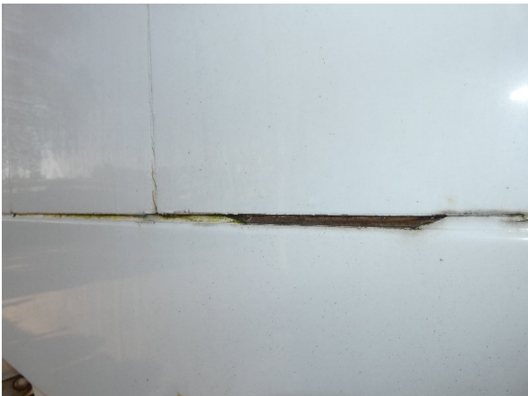
Bild 20: Seritenwand links außen Korrosion / Lackablösung - teillackieren
