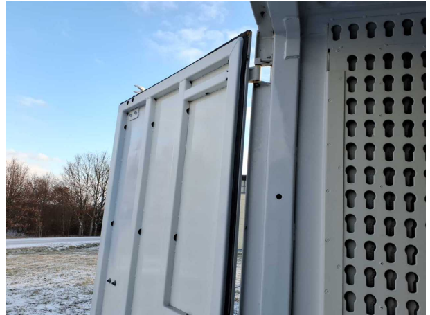
Beschädigung 1: Heckklappe/-tür: Dichtung links - beschädigt - erneuern
