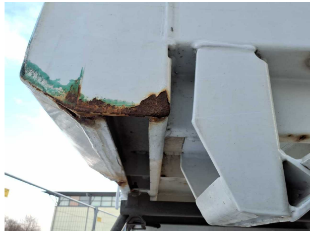
Beschädigung 4: Koffer: Portalrahmen - Korrosion - instandsetzen und lackieren
