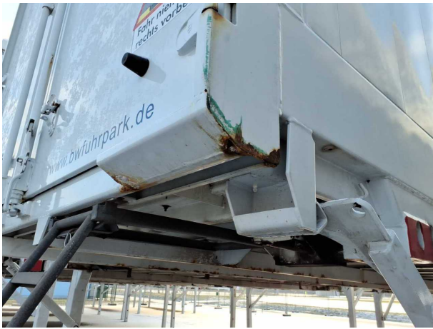
Beschädigung 4: Koffer: Portalrahmen - Korrosion - instandsetz... und lackieren
