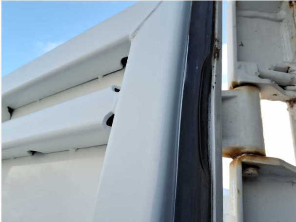
Beschädigung 1: Heckklappe/-tür: Dichtung links - beschädigt - erneuern
