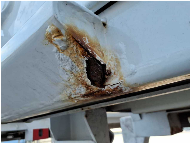
Beschädigung 4: Koffer: Portalrahmen - Korrosion - instandsetz... und lackieren
