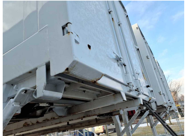
Beschädigung 4: Koffer: Portalrahmen - Korrosion - instandsetzen und lackieren
