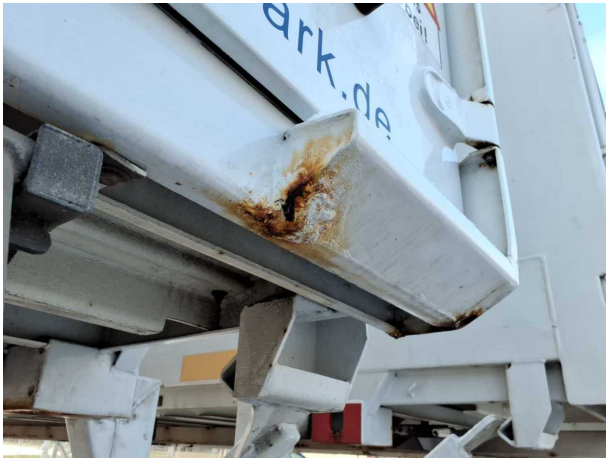
Beschädigung 4: Koffer: Portalrahmen - Korrosion - instandsetz... und lackieren
