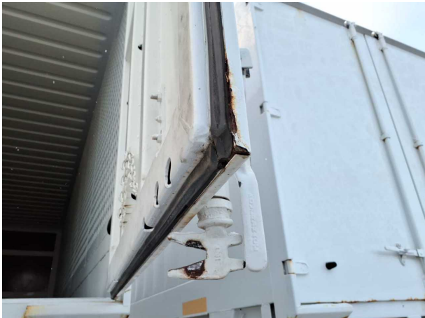
Beschädigung 4: Heckklappe/-tür: Hecktür rechts - Korrosion - instandsetzen und lackieren
