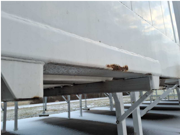
Gebrauchsspur 1: Koffer: Koffer - Korrosion
