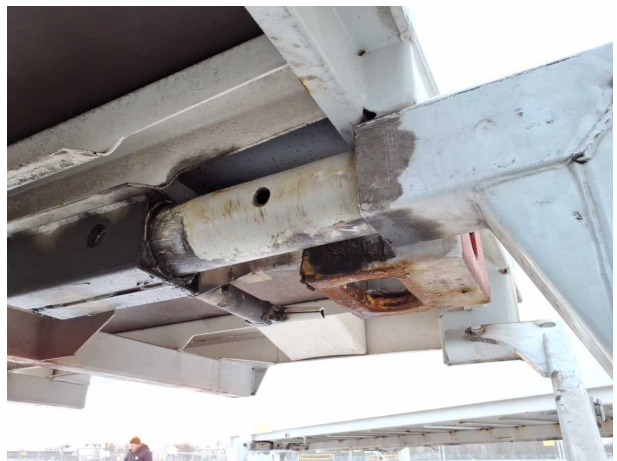
Gebrauchsspur 1: Koffer: Koffer - Korrosion
