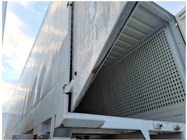
Beschädigung 3: Heckklappe/-tür: Hecktür links - Korrosion - instandsetzen und lackieren
