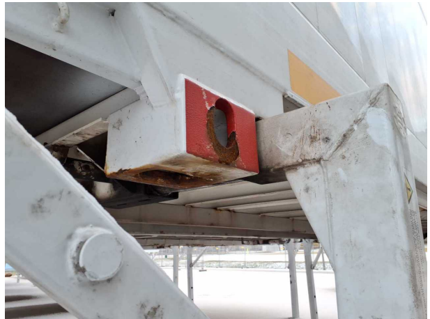
Gebrauchsspur 1: Koffer: Koffer - Korrosion
