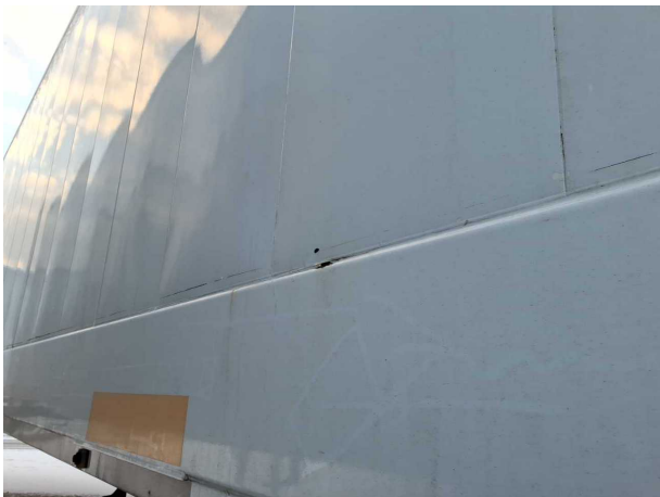
Gebrauchsspur 1: Koffer: Koffer - Korrosion
