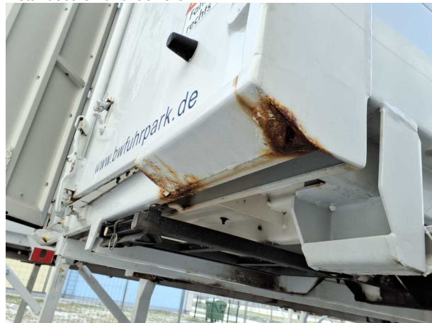
Beschädigung 3: Koffer: Portalrahmen - Korrosion - instandsetzen und lackieren
