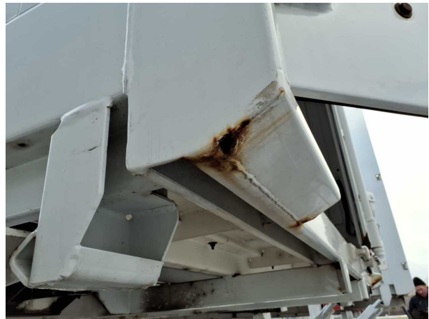
Beschädigung 3: Koffer: Portalrahmen - Korrosion - instandsetzen und lackieren
