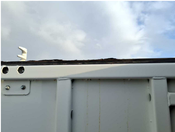
Beschädigung 1: Heckklappe/-tür: Hecktür links - Korrosion - instandsetzen und lackieren
