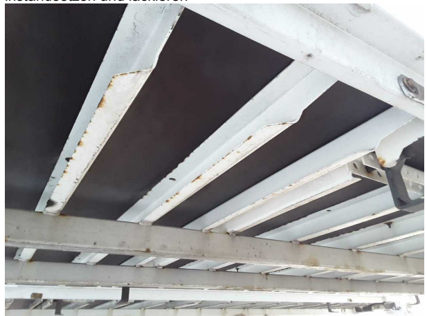
Gebrauchsspur 1: Koffer: Koffer - Korrosion - kein Abzug
