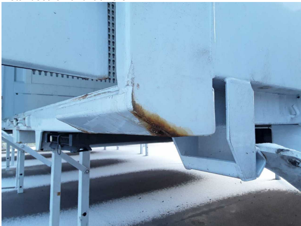
Beschädigung 2: Koffer: Portalrahmen - Korrosion - instandsetzen... und lackieren
