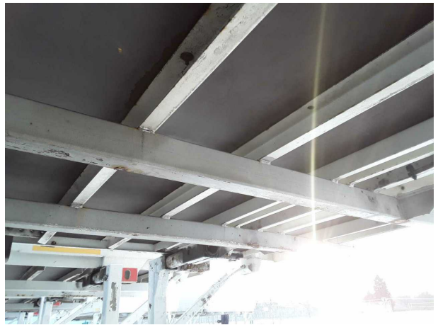
Gebrauchsspur 1: Koffer: Koffer - Korrosion - kein Abzug
