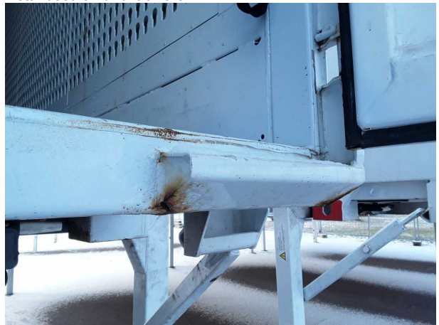
Beschädigung 2: Koffer: Portalrahmen - Korrosion - instandsetzen und lackieren
