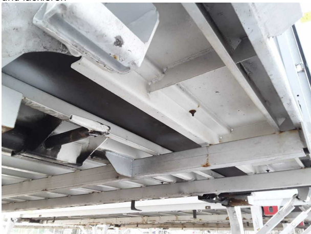
Gebrauchsspur 1: Koffer: Koffer - Korrosion - kein Abzug
