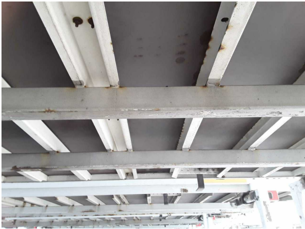
Gebrauchsspur 1: Koffer: Koffer - Korrosion - kein Abzug
