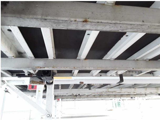
Gebrauchsspur 1: Koffer: Koffer - Korrosion - kein Abzug
