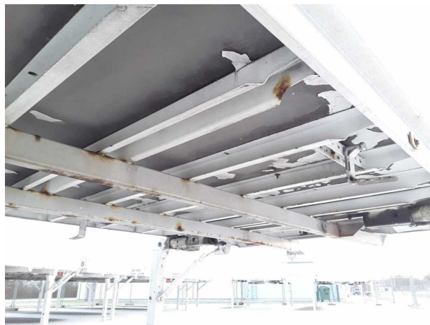
Gebrauchsspur 1: Koffer: Koffer - Korrosion - kein Abzug
