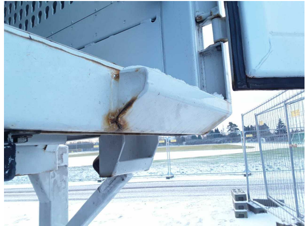
Beschädigung 1: Koffer: Portalrahmen - Korrosion - instandsetzen und lackieren
