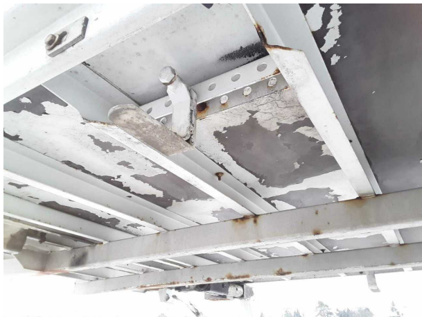
Gebrauchsspur 1: Koffer: Koffer - Korrosion - kein Abzug
