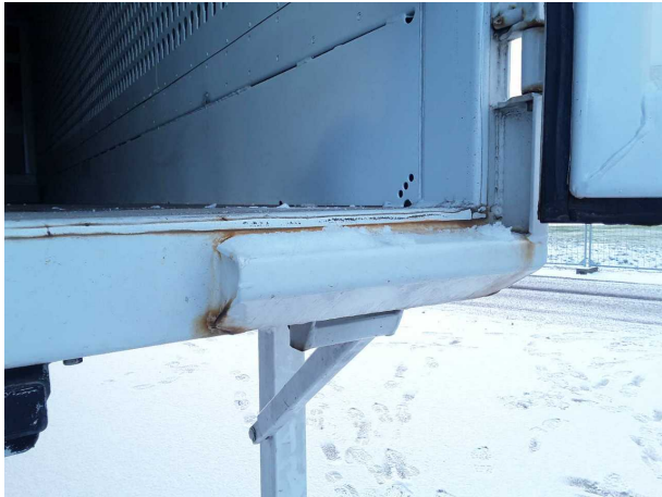
Beschädigung 1: Koffer: Portalrahmen - Korrosion - instandsetz... und lackieren
