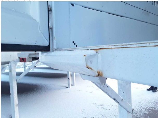
Beschädigung 1: Koffer: Portalrahmen - Korrosion - instandsetz... und lackieren
