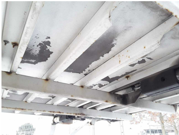
Gebrauchsspur 1: Koffer: Koffer - Korrosion - kein Abzug
