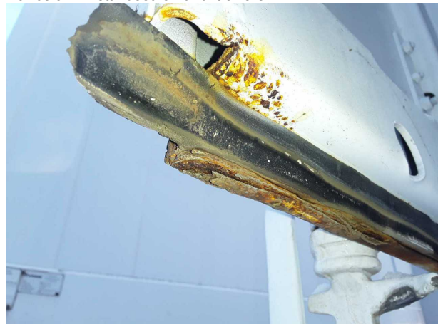
Beschädigung 2: Heckklappe/-tür: Hecktür links (Starke) - Korrosion - instandsetzen und lackieren
