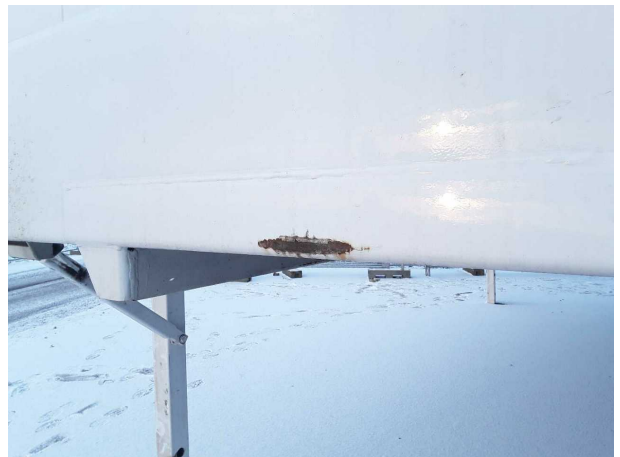
Gebrauchsspur 1: Koffer: Koffer - Korrosion - kein Abzug
