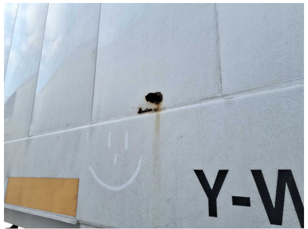
Beschädigung 4: Seitenwand rechts: Seitenwand vorn - beschädigt - instandsetzen
