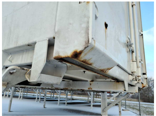
Beschädigung 3: Koffer: Portalrahmen - Korrosion - instandsetzen und lackieren
