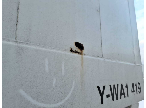
Beschädigung 4: Seitenwand rechts: Seitenwand vorn - beschädigt - instandsetzen
