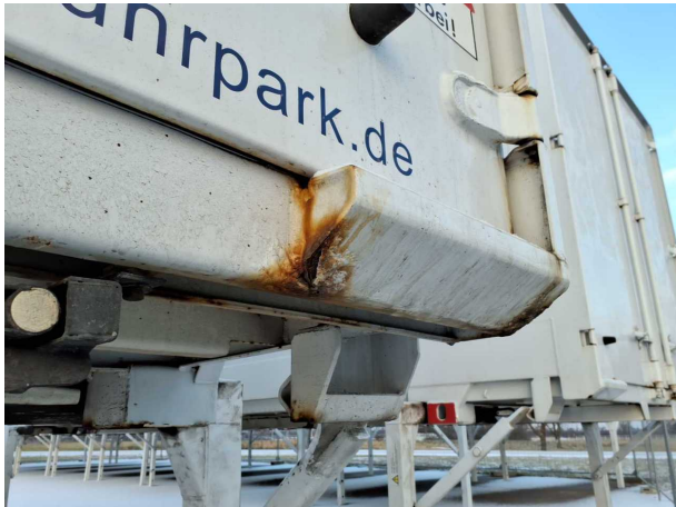
Beschädigung 3: Koffer: Portalrahmen - Korrosion - instandsetzen und lackieren
