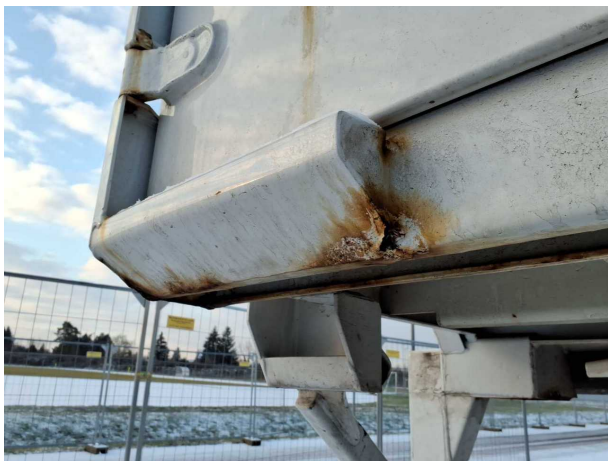
Beschädigung 3: Koffer: Portalrahmen - Korrosion - instandsetz... und lackieren
