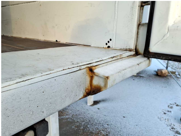
Beschädigung 3: Koffer: Portalrahmen - Korrosion - instandsetz... und lackieren
