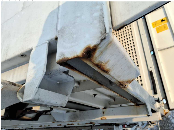
Beschädigung 3: Koffer: Portalrahmen - Korrosion - instandsetz... und lackieren
