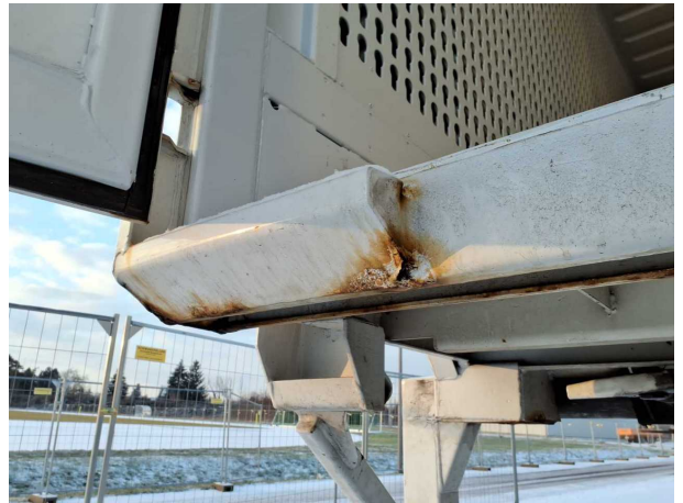
Beschädigung 3: Koffer: Portalrahmen - Korrosion - instandsetzen und lackieren
