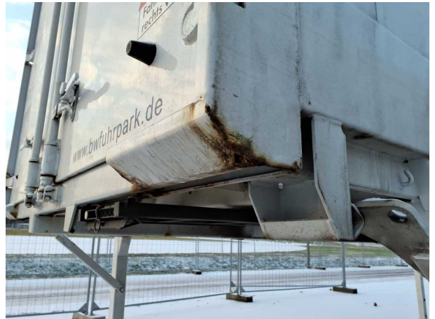
Beschädigung 3: Koffer: Portalrahmen - Korrosion - instandsetzen und lackieren
